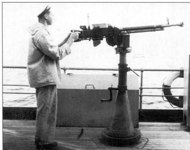
12,7-мм пулемет ДШК на тумбовом лафете
