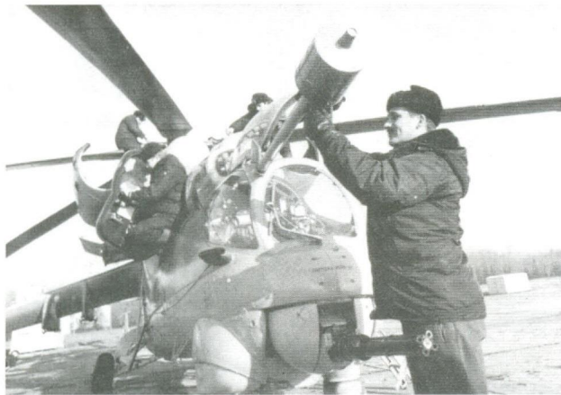
Цилиндрический защитный кожух на датчиках скольжения
