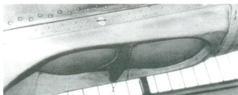
Антенны доплеровского измерителя скорости сноса ДИСС-15Д в нижней части хвостовой балки
