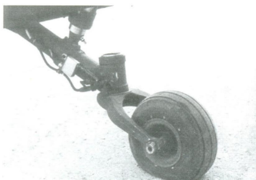
Хвостовое колесо может поворачиваться на 360°
