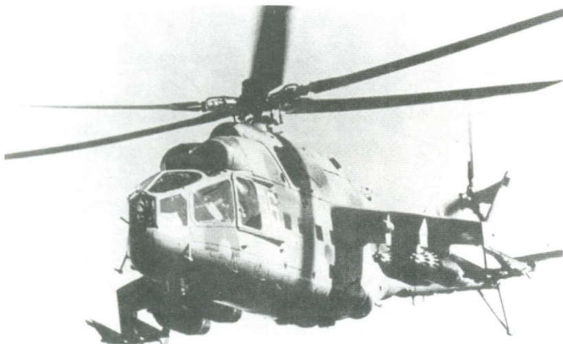
Серийный Ми-24А с новым крылом, под которым подвешены НУР еще в «самолетных» блоках УБ-32
