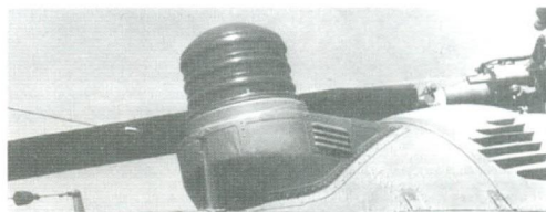
Импульсная лампа инфракрасных помех Л-166В-1АЕ
