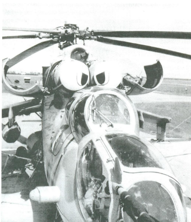
Ми-24В с открытыми створками мотокапотов
