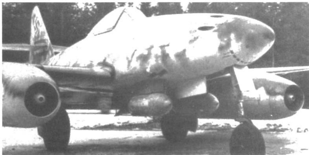
Истребитель-бомбардировщик Me.262A-2a с двумя бомбами калибра 250 кг
