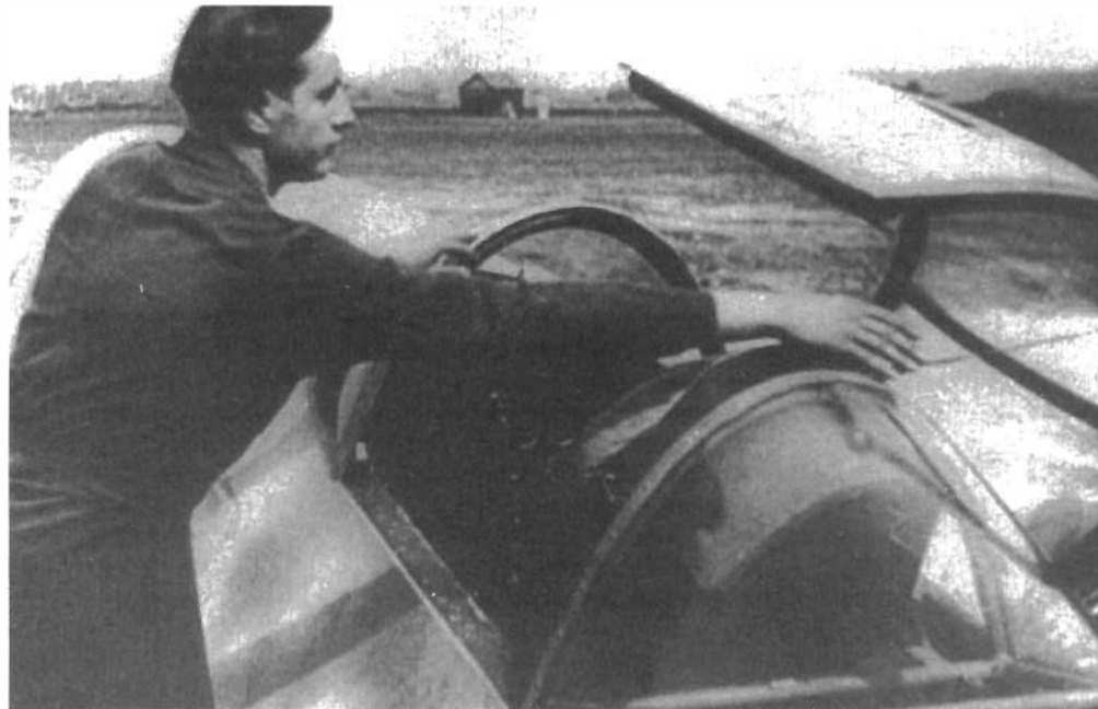
Подвижная часть фонаря кабины пилота самолета Me.262 открывалась в бок
