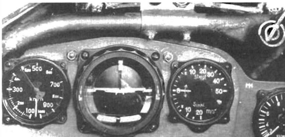
Указатель скорости и авиагоризонт с указателем скольжения на приборной доске летчика
