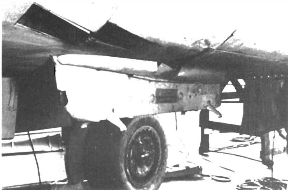
Бомбодержатель ETC-504 для истребителя- бомбардировщика
