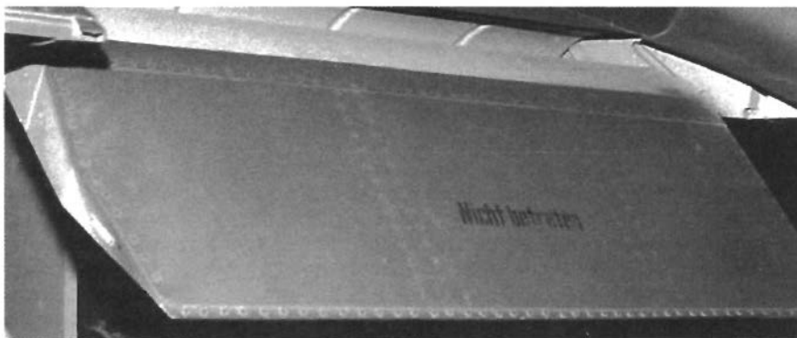
Внутренняя часть трехсекционного предкрылка и закрылок Фаулера на Me.262
