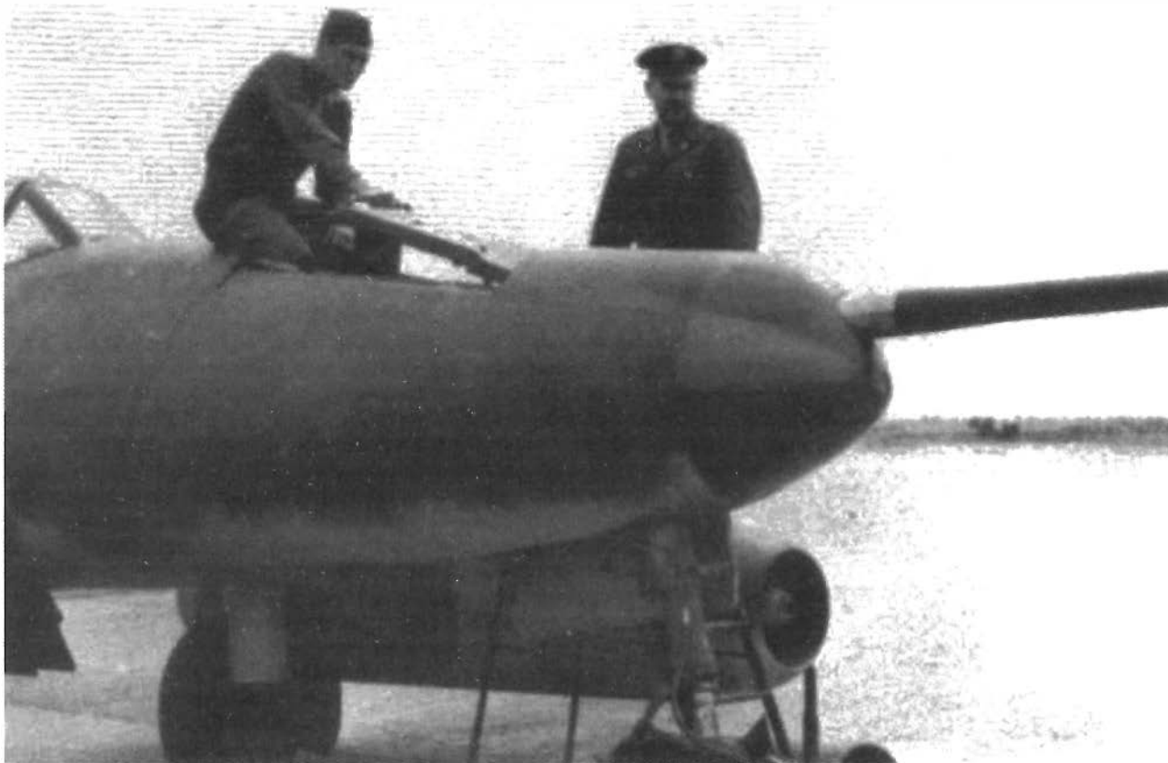
«Швальбе» Me.262A1-а (заводской № 230 083) с пушкой МК-214А калибра 50 мм
