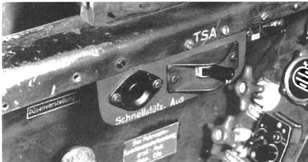
Фрагмент кабины пилота (левый борт) самолета Me.262A-1a/U1
