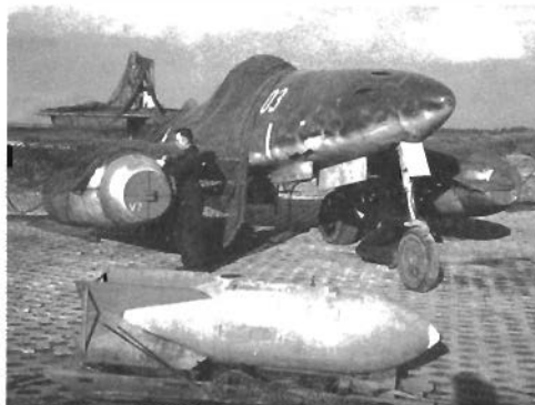
Me.262V7 — прототип истребителя бомбардировщика Me.262A-2a. На верхнем снимке на переднем плане бомба калибра 250 кг
