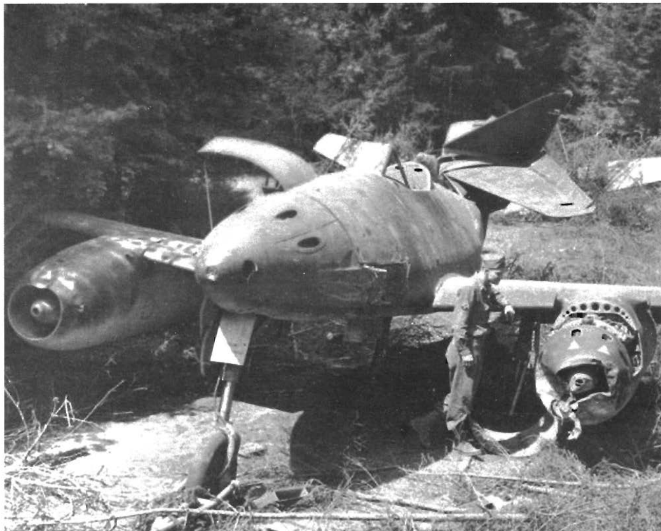
Разбитый двухместный истребитель-перехватчик
