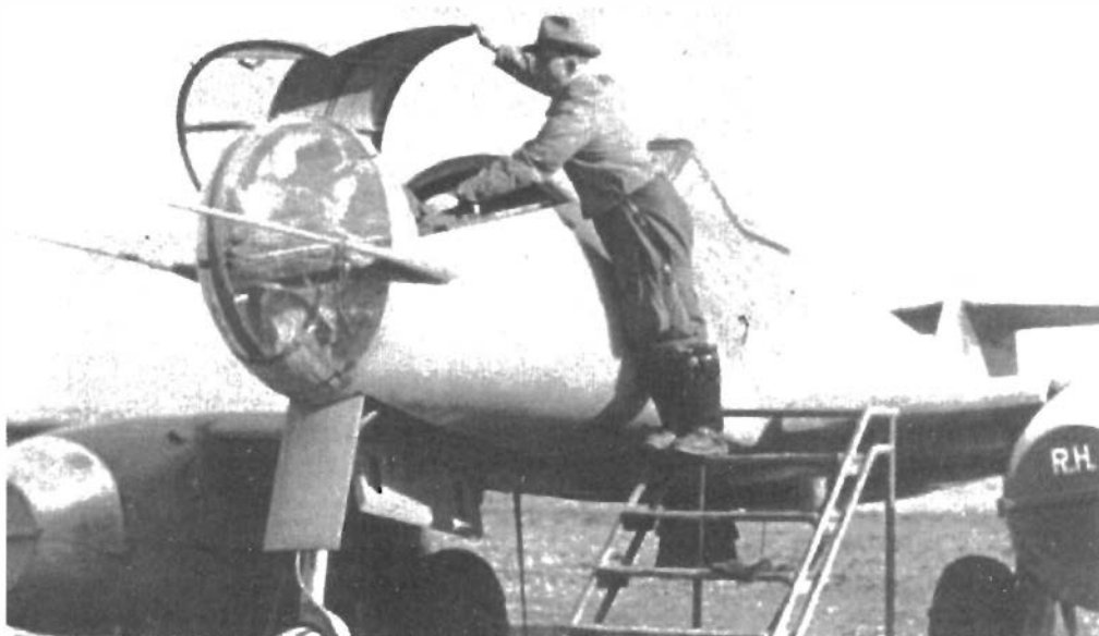
Второй вариант двухместного бомбардировщика Me.262 (заводской № 110 555) с кабиной бомбардира (располагавшегося лежа) в носовой части фюзеляжа
