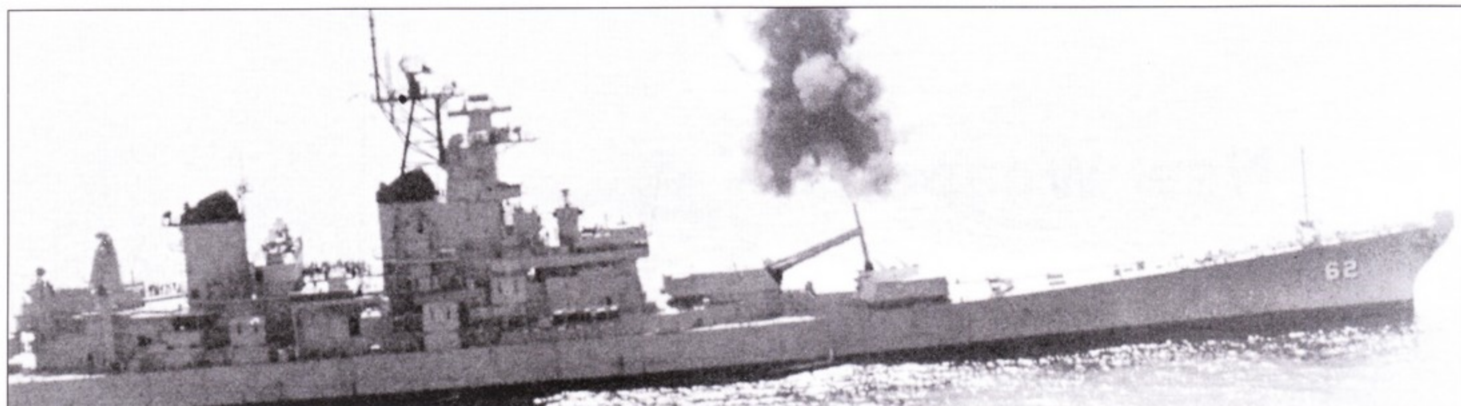
Главный калибр «Нью Джерси» был опробован во втором после модернизации выходе в море. Вооружение корабля новыми системами еще не завершено. Так установлена только одна из четырех пусковых установок для крылатых ракет «Томагавк». За дымовой трубой, однако, уже смонтированы пусковые установки ПКР «Гарпун».
