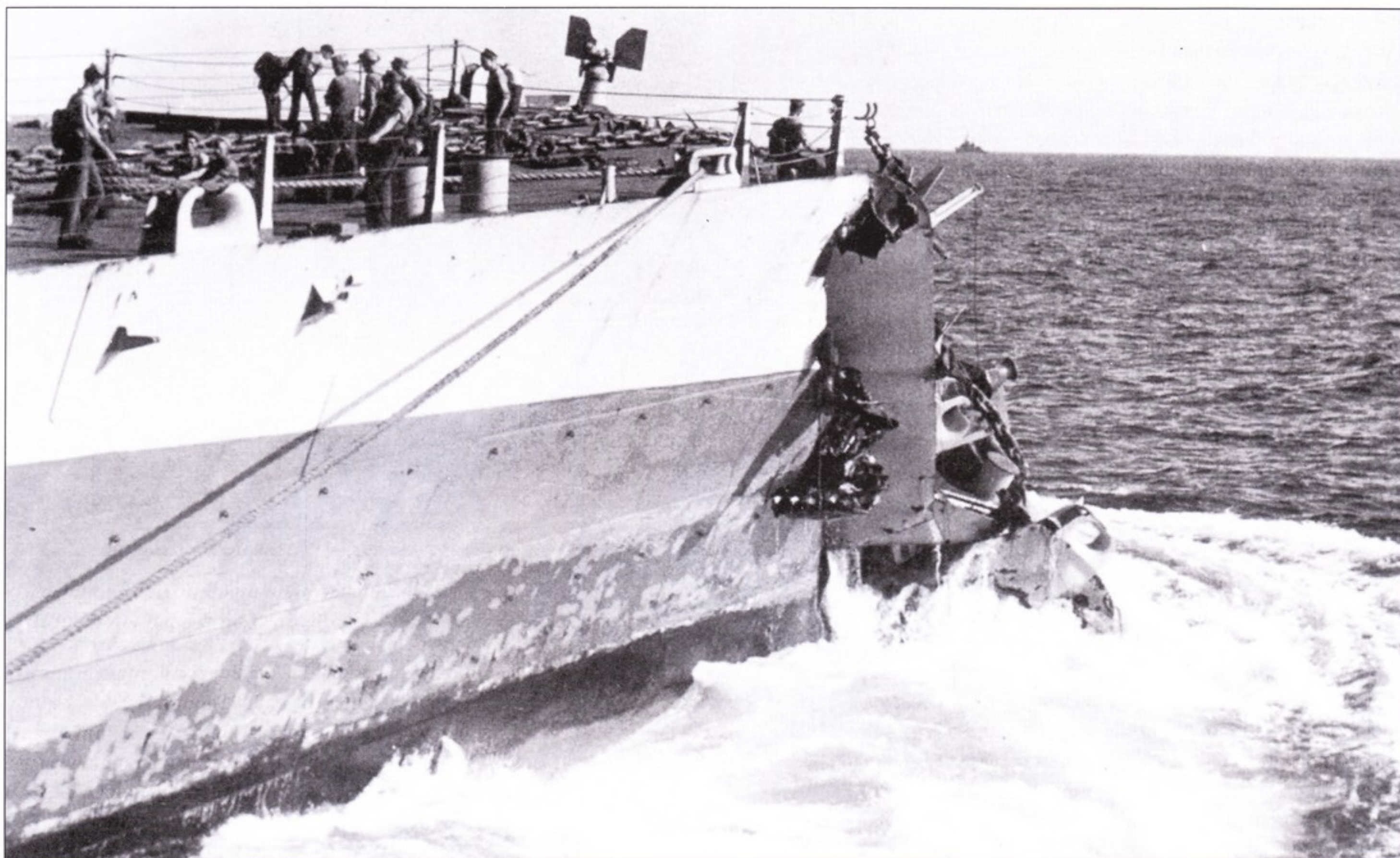
«Вашингтон» столкнулся с «Индианой» при маневрировании в водах Квадзалеяна ранним утром 1 февраля 1944 г. В результате столкновения у «Вашингтона» отвалилась носовая часть корпуса по шпангоуту № 21. Ремонт провели быстро - 30 мая корабль уже вернулся в строй.
