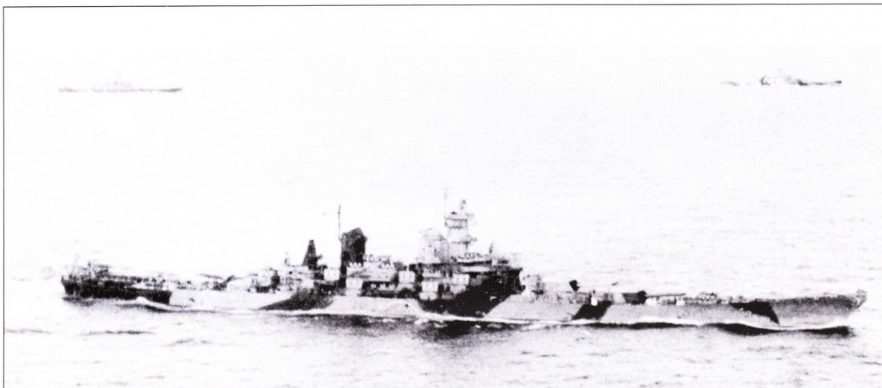
Радиотехническое вооружение «Айовы» отличалось от аналогичного на «Нью Джерси» только установкой на башенноподобной надстройке антенны FC. Окраска - крайне необычная, камуфляж: Dull Black/Ocean Gray. Обратите внимание: одна сторона полос черного цвета - четкая, другая «смягчена» краской серого цвета. Данная схема окраски была разработана для использования в Атлантике на эскортных авианосцах. Предположительно, «Айова» стала единственным на Тихом океане кораблем, окрашенным по данной схеме.
