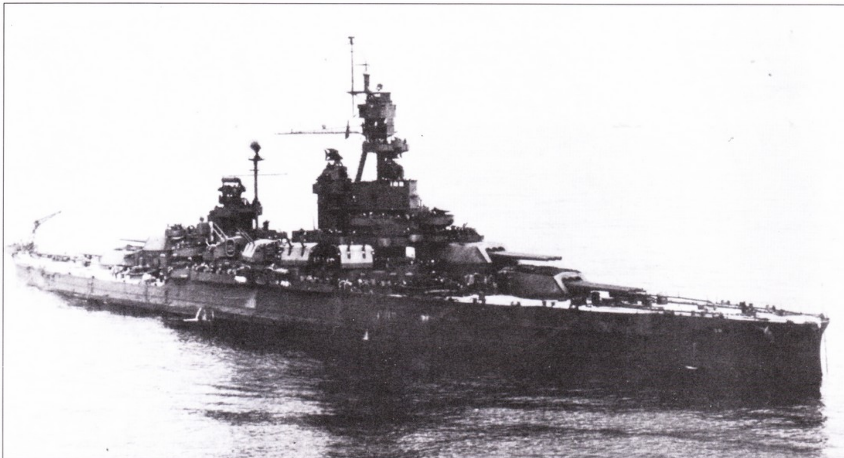
«Пенсильвания» присоединилась в Восточно-Китайском море к TF-95 Олдендорфа, снимок 28 июня 1945 г. Линкор окрашен по схеме Ms. 21. Радиолокационное вооружение типично для конца войны: SG, SK, Mk 28, SP, Mk 34, Mk12/22.
