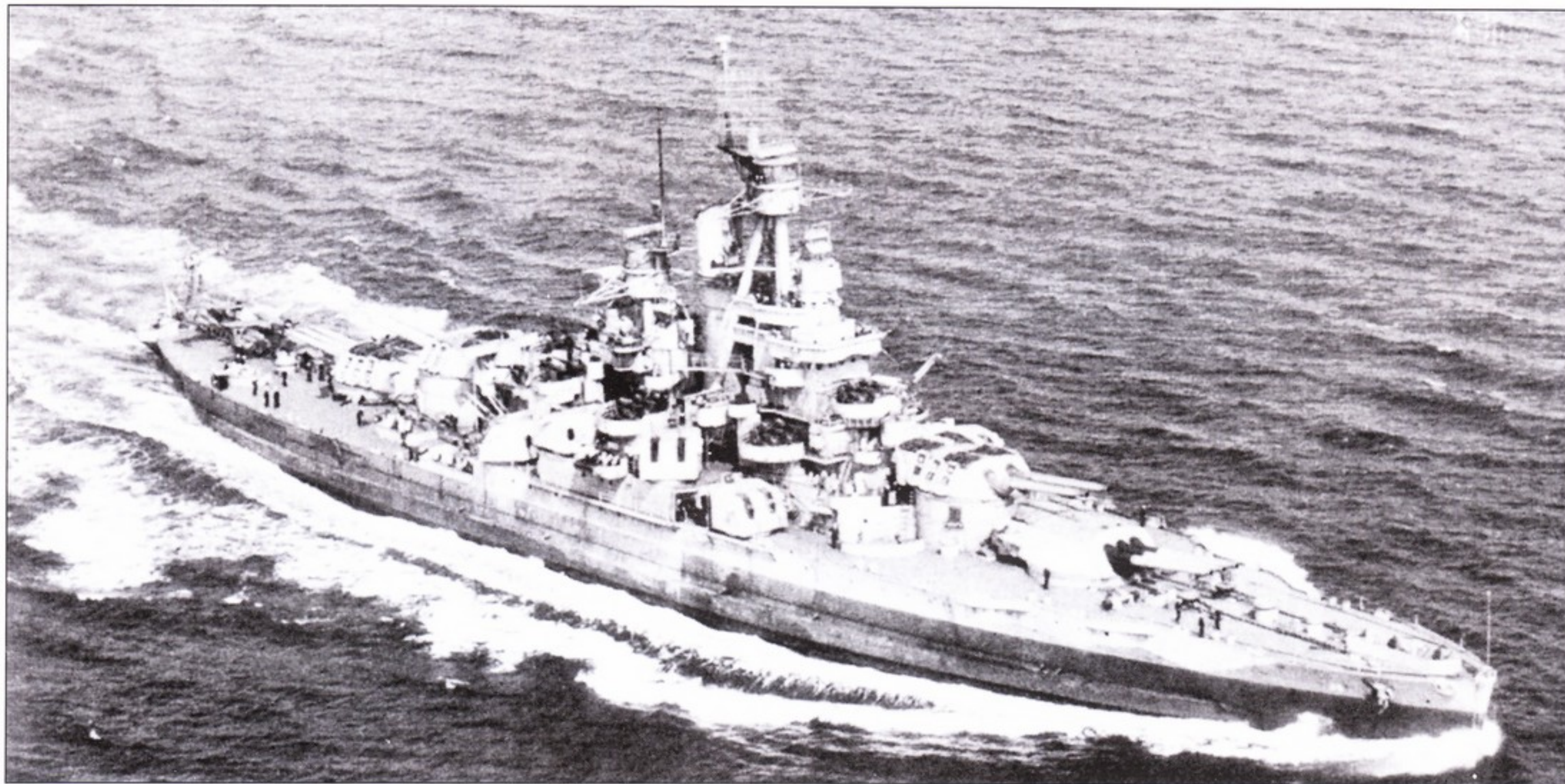
«Невада» держит курс на Норфолк перед уходом в Тихий океан, 17 сентября 1944 г. Линкор принимал участие в высадках союзников в Нормандии и Южной Франции. На фок-мачте хорошо видна антенна радиолокатора SK. Корабль окрашен по типичной для Атлантике схеме Ms. 22.
