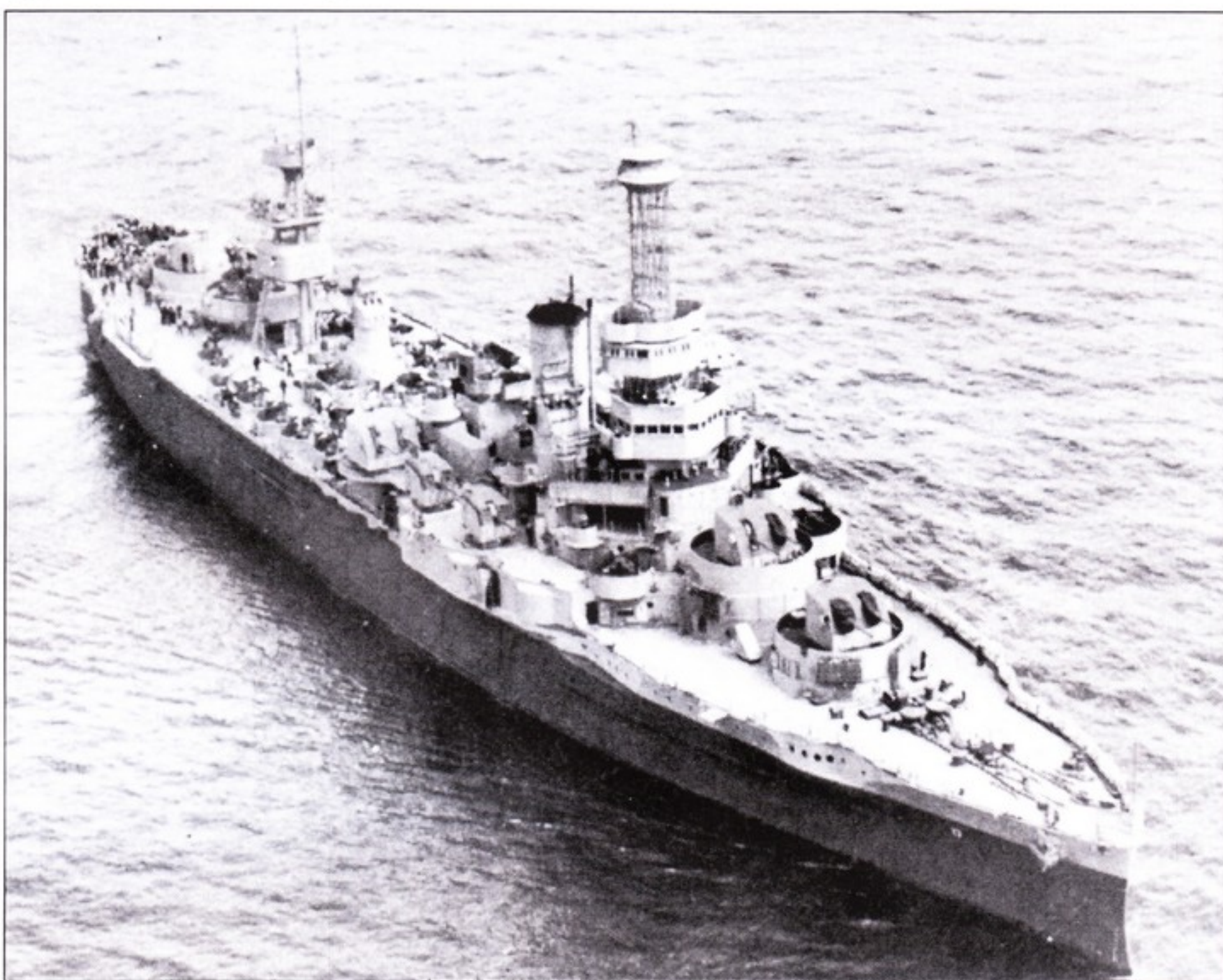
В начале 1944 г. «Вайоминг» окончательно лишился башен с орудиями калибра 12 дюймов. Взамен были поставлены двухорудийные башни с универсальными 5-дюймовыми пушками с длинной ствола 38 калибров. Снимок сделан 18 апреля 1944 г.
