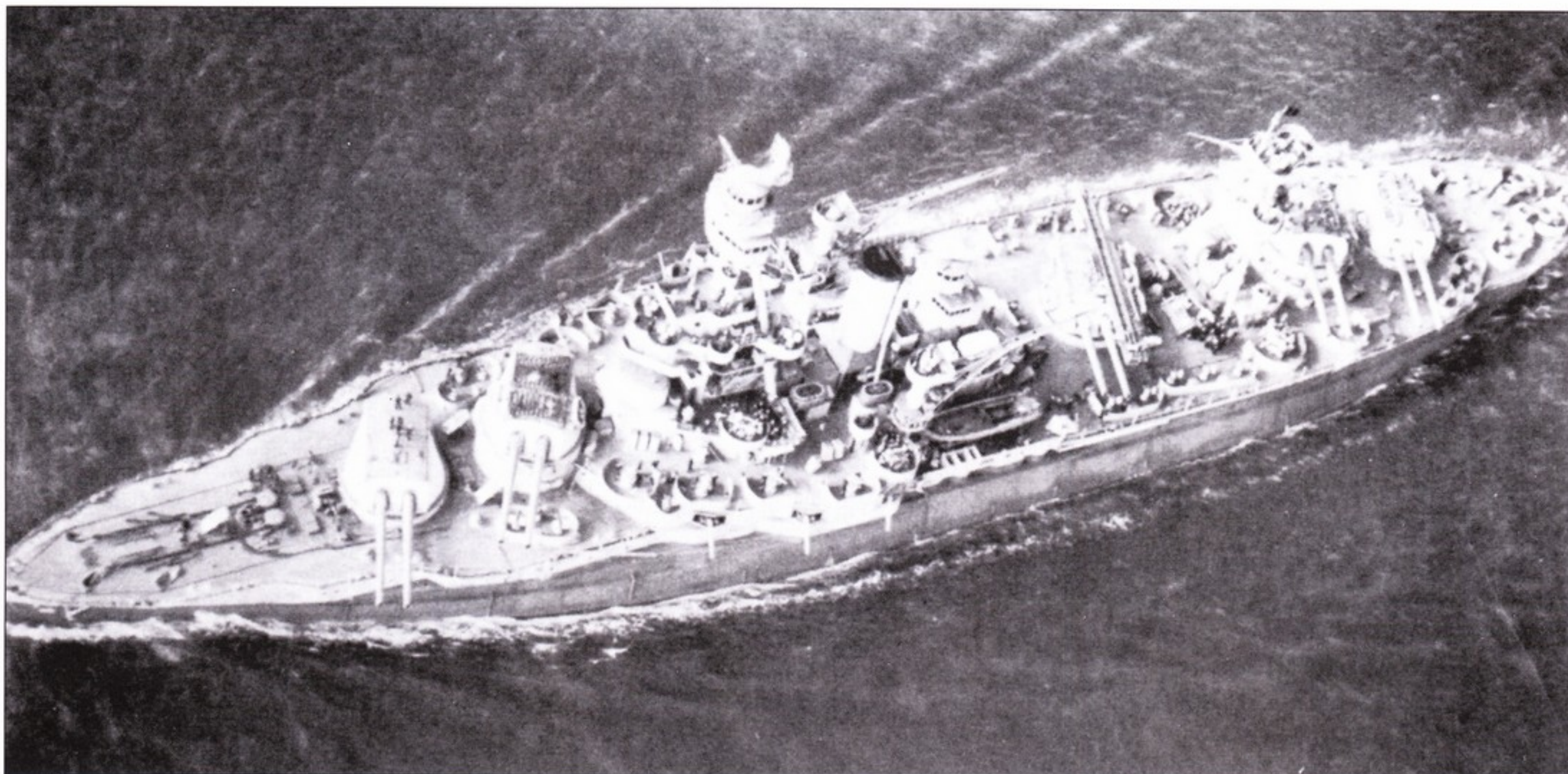
Снимок с самолета линкора «Техас», 15 декабря 1942 г. Хорошо видно размещение зенитной артиллерии на корабле. Централизованной системы управления зенитным огнем в то время на линкорах еще не существовало.
