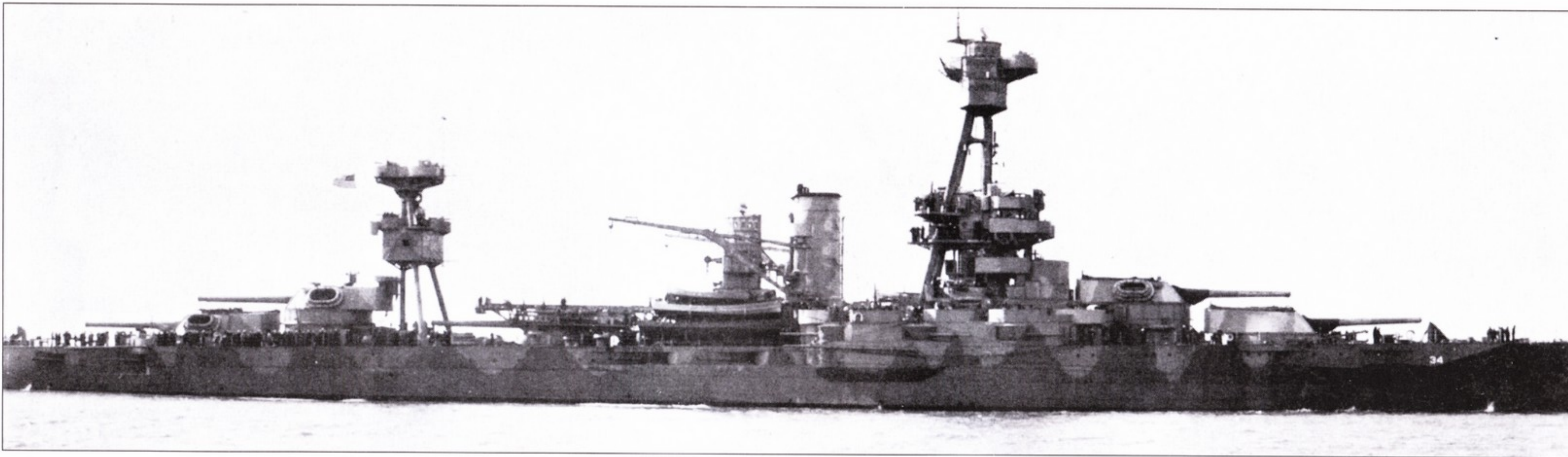
Линкор «Нью-Йорк», окрашенный по схеме Ms 12 Mod., Норфолк, 1 февраля 1942 г. В 1938 г. на корабле проходил испытания экспериментальный радиолокатор XAF, а теперь на фок-мачте установлена антенна радиолокатора FC. Еще одна антенна радиолокатора FC смонтирована на башенной надстройке за дымовой трубой. На платформах фок-мачты в двух уровнях смонтировано значительное количество зенитных автоматов Эрликон калибра 20 мм.
