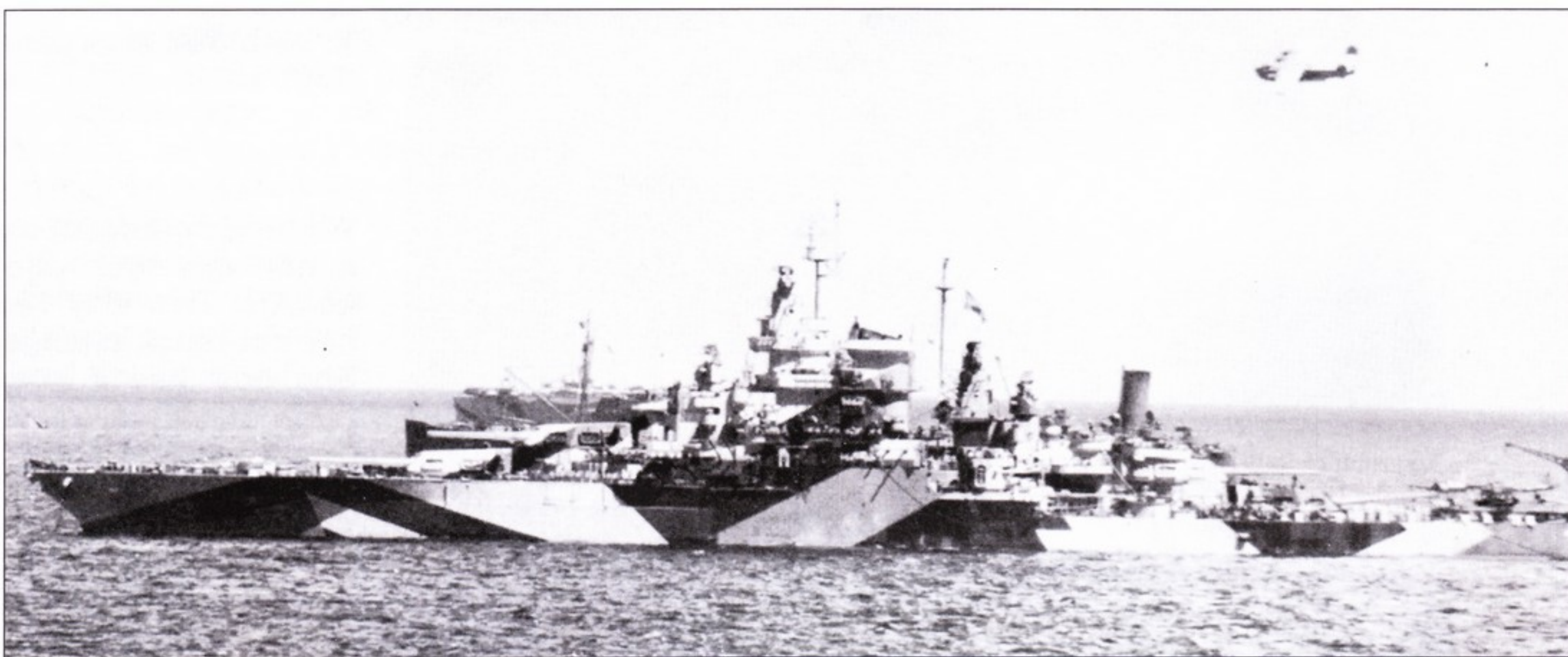
«Калифорния» сильно задержалась в ремонте и вступила в строй лишь в январе 1944 г. внешне практически идентичной «Теннесси», отличаясь только окраской и радиолокационным вооружением. Количество 40-мм счетверенных Бомфорсов на «Калифорнии» было большим, чем на «Теннесси», а на крыше башни «Х» главного калибра поставили платформу с 20-мм Эрликонами. Снимки «Калифорнии» сделаны 12 июня и 28 октября 1944 г. Камуфляж бортов не симметричен.
