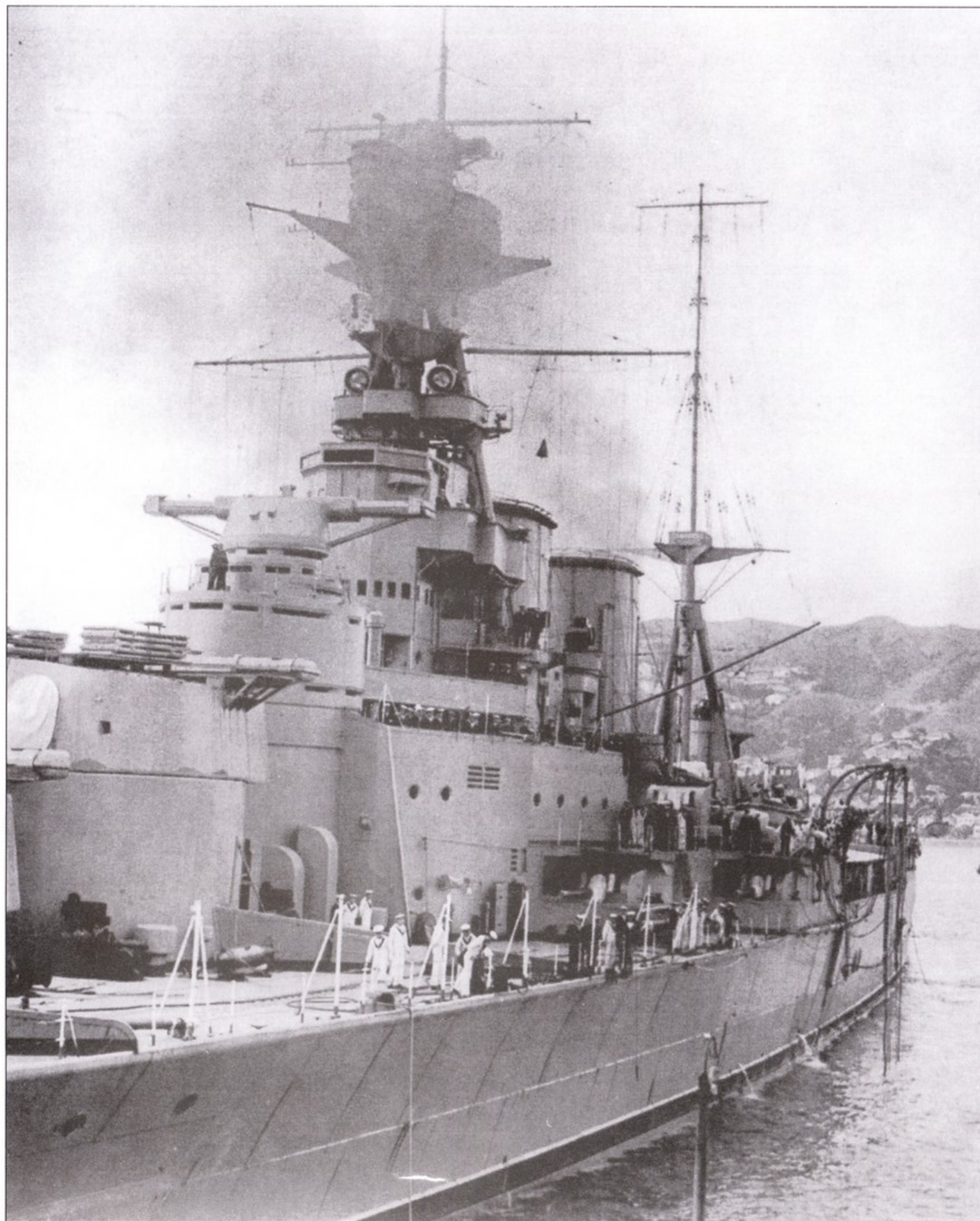
Два снимка «Худа», сделанные на Новой Зеландии в Веллингтоне и Окленде. Хорошо видны детали надстройки и дымовая труба. На мостике установлено огромное количество переговорных труб, использовавшихся для внутрикорабельной связи. Над прожекторами, слева и справа от оси надстройки установлены циферблаты, на которых стрелки указывали другим кораблям дистанцию до цели.
