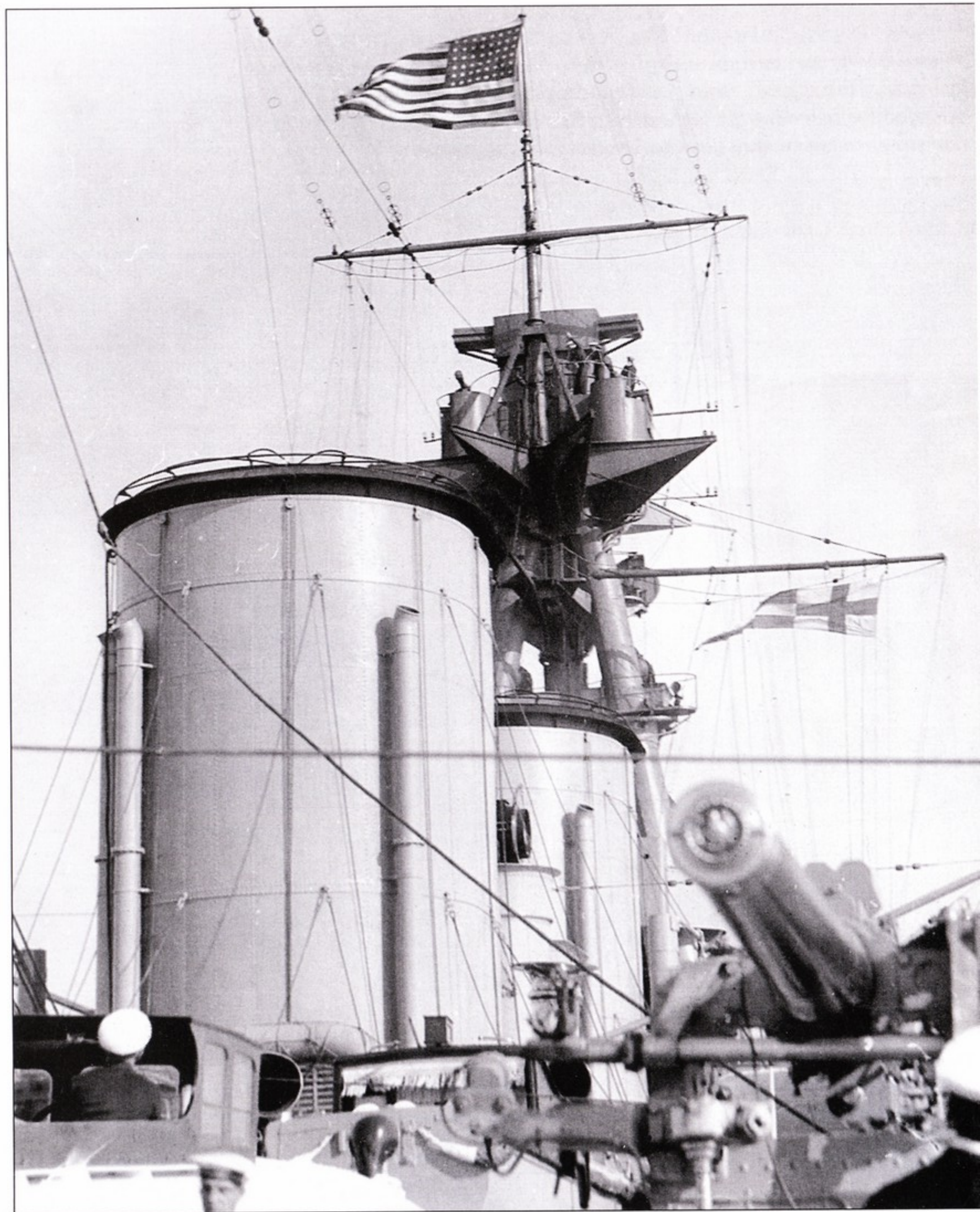
«Худ» в Сан-Франциско, Калифорния, США. Снимок сделан в промежутке с 7 по 11 июля 1924 г. В знак уважения к стране пребывания на британском корабле поднят флаг Соединенных Штатов. На правом фото в кадр попала 4-дюймовое зенитное орудие. Хорошо видны изоляторы натяжных радиоантенн.
