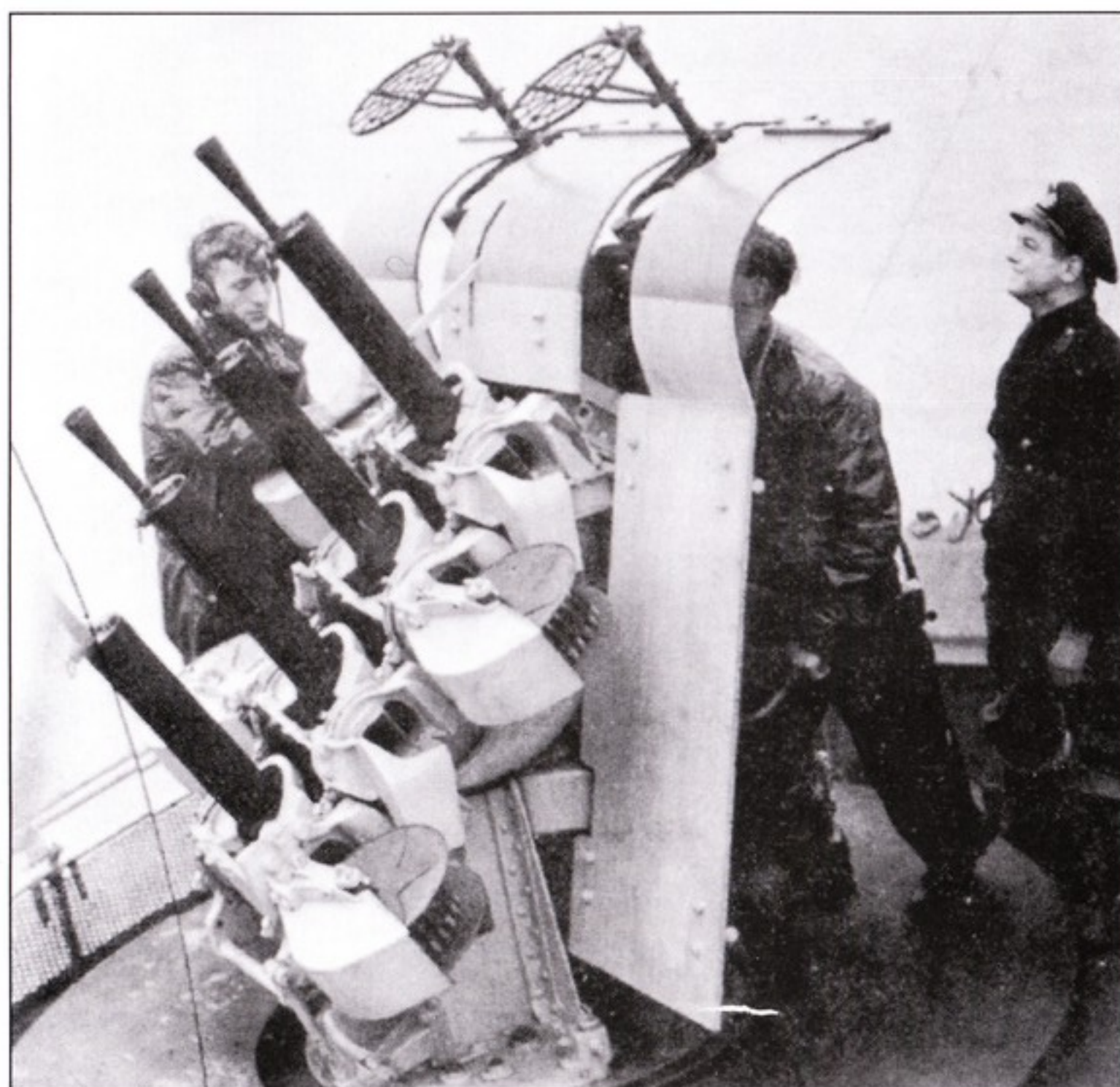
Фотографии малокалиберных зенитных средств линейного крейсера «Худ» и 15-футового оптического дальномера системы наведения малокалиберных зениток. На левом нижнем снимке - счетверенная пулеметная установка, две таких установки смонтировали на «Худе» в 1933 г., еще две - в 1937 г. пулеметы оставались на «Худе» вплоть до гибели корабля. Верхний и нижний правые снимки - 40-мм автоматы «пом-пом» калибра 40 мм. Восьмиствольный автомат обладал скорострельностью 115 выстрелов в минуту, боекомплект - 5670 снарядов. Два «пом-пома» поставили на «Худ» в 1931 г., третий - в 1937 г.
