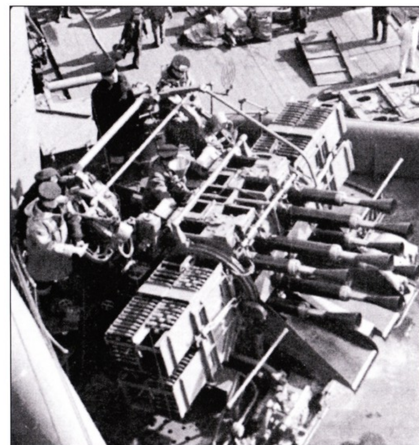
Фотографии малокалиберных зенитных средств линейного крейсера «Худ» и 15-футового оптического дальномера системы наведения малокалиберных зениток. На левом нижнем снимке - счетверенная пулеметная установка, две таких установки смонтировали на «Худе» в 1933 г., еще две - в 1937 г. пулеметы оставались на «Худе» вплоть до гибели корабля. Верхний и нижний правые снимки - 40-мм автоматы «пом-пом» калибра 40 мм. Восьмиствольный автомат обладал скорострельностью 115 выстрелов в минуту, боекомплект - 5670 снарядов. Два «пом-пома» поставили на «Худ» в 1931 г., третий - в 1937 г.
