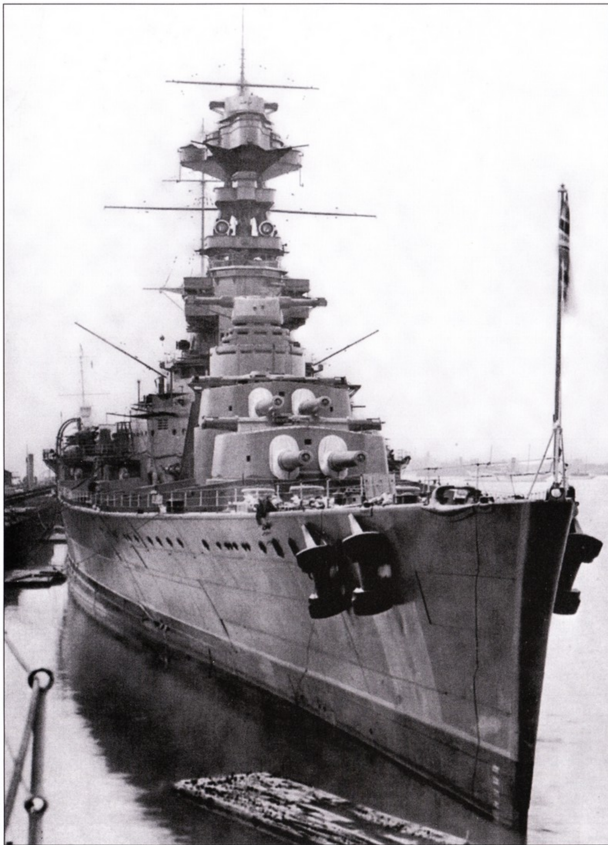
Обе фотографии выполнены 27 июля 1932 г. «Худ» зашел в Портсмут на ремонт после общефлотских учений. В ходе ремонта с корабля демонтировали вообще все авиационное оборудование, поскольку использование самолетов с борта крейсера в бурную погоду представлялось чрезвычайно опасным. Кроме того, самолеты получали повреждения при производстве стрельбы артиллерией главного калибра. Обратите внимание - видимые на палубе участки якорных цепей окрашены в белый цвет.
