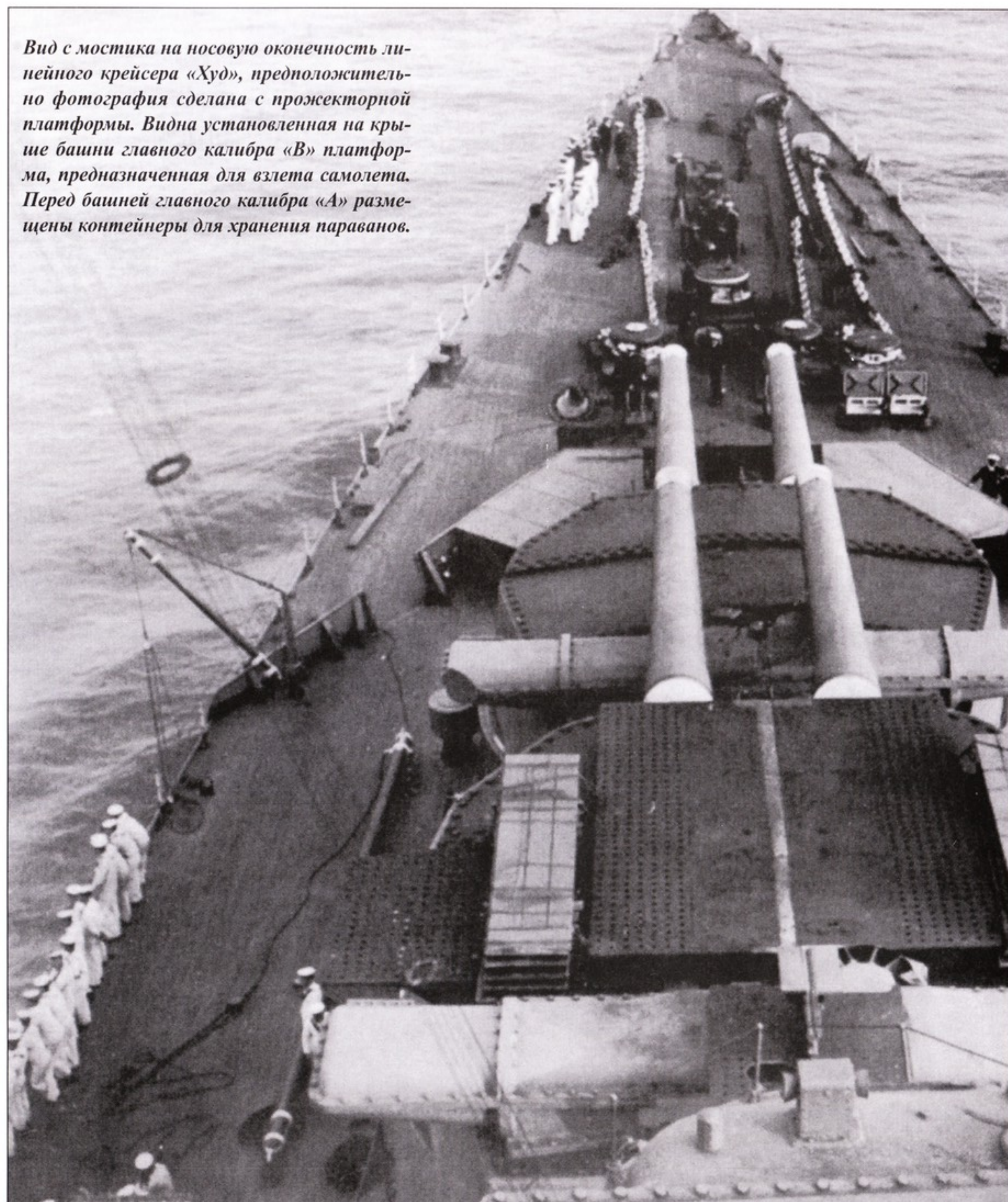
Крупный план носовых башен главного калибра и мостика. Конструкция башен главного калибра линейного крейсера «Худ» уникальна. Стволы орудий закрыты заглушками во избежание попадания внутрь воды и посторонних объектов. На заглушках - фамильный герб семьи Худов.
