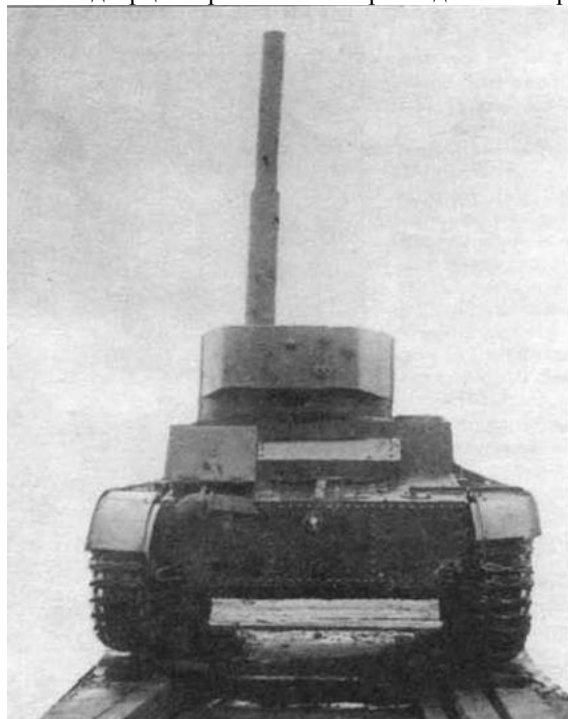
Т-26ПХ конструкции НИБТПолигона. Вид сзади. Хорошо видны поднятая коробка масляного радиатора и воздушный колпак, закрытый дверцей
