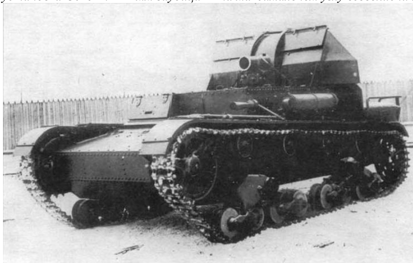
Самоходная установка СУ-5-5 была вооружена 152-мм мортирой
