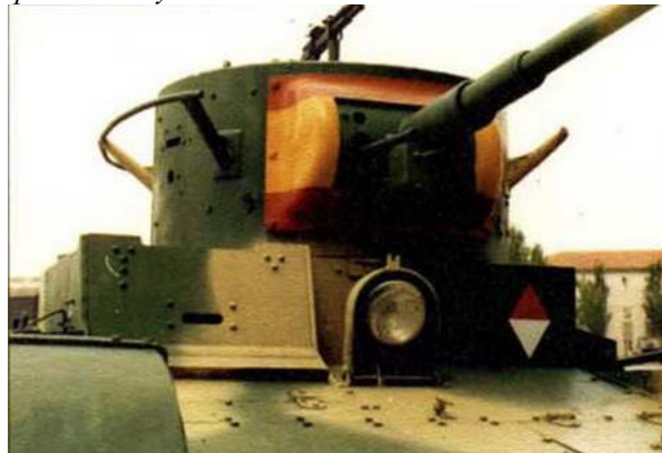
Танк Т-26 обр. 1933 г. в экспозиции музея El Goloso Baracks в Мадриде. Машина вооружена пулеметами "Гочкис". Установка зенитного пулемета и поручневая антенна — имитация Все фото М.Копомийца
