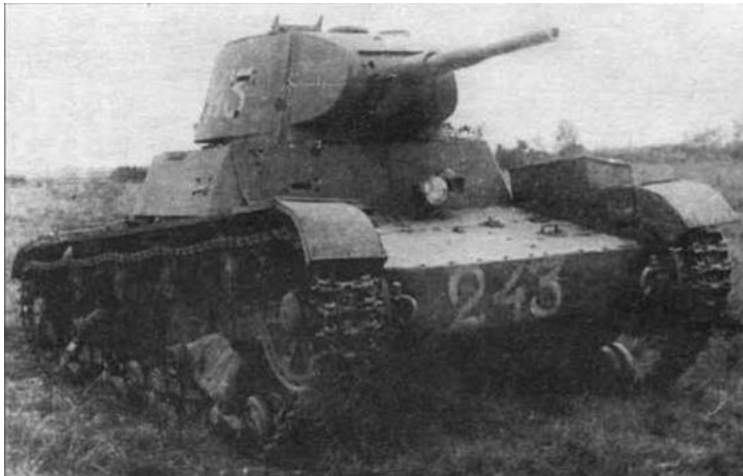
Танк Т-26обр. 1939 г. Пашня со сварным лобовым щитом
