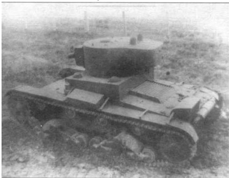
Телетанк XT-130. На крыше башни хороша видны два антенных ввода. НИБТПолигон, 1940г.
