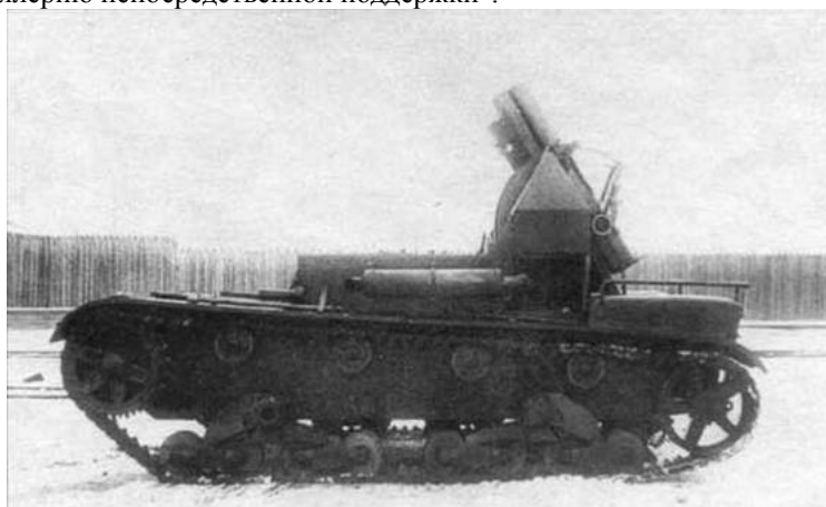
Самоходная установка СУ-5-2. 122-мм гаубица — на максимальном углу возвышения
