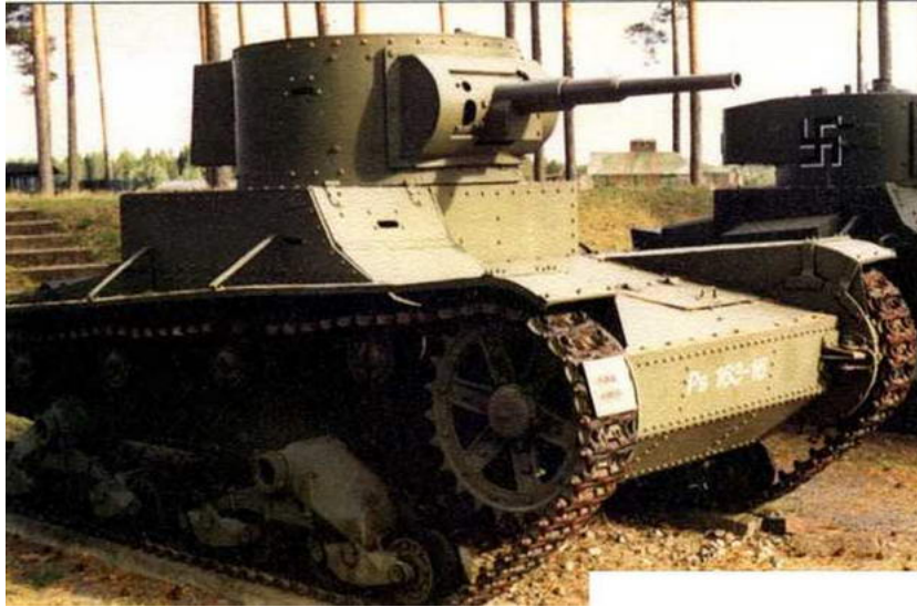
Еще один редкий экспонат музея в Пароле — Т-26 обр. 1933 г. самых ранних выпусков с клепаной башней и маленькой кормовой нишей
