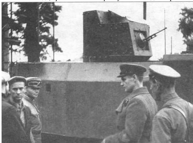
В осажденной Одессе башни, снятые с двухбашенных Т-26, использовались при постройке бронированных тракторов — "танков НИИ". В данной случае пулемет ДТ смонтирован в башне. ранее
