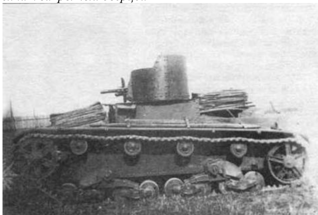
Т-26ПХ конструкции НИБТПолигона. Вид сзади. Хорошо видны поднятая коробка масляного радиатора и воздушный колпак, закрытый дверцей
