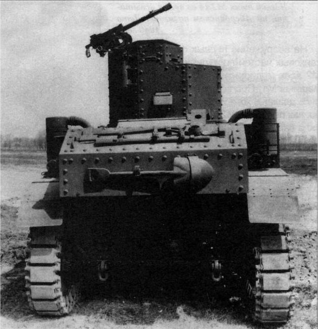
Легкий танк М3. На виде спереди видны открытые крышки смотровых лючков в стенках башни
