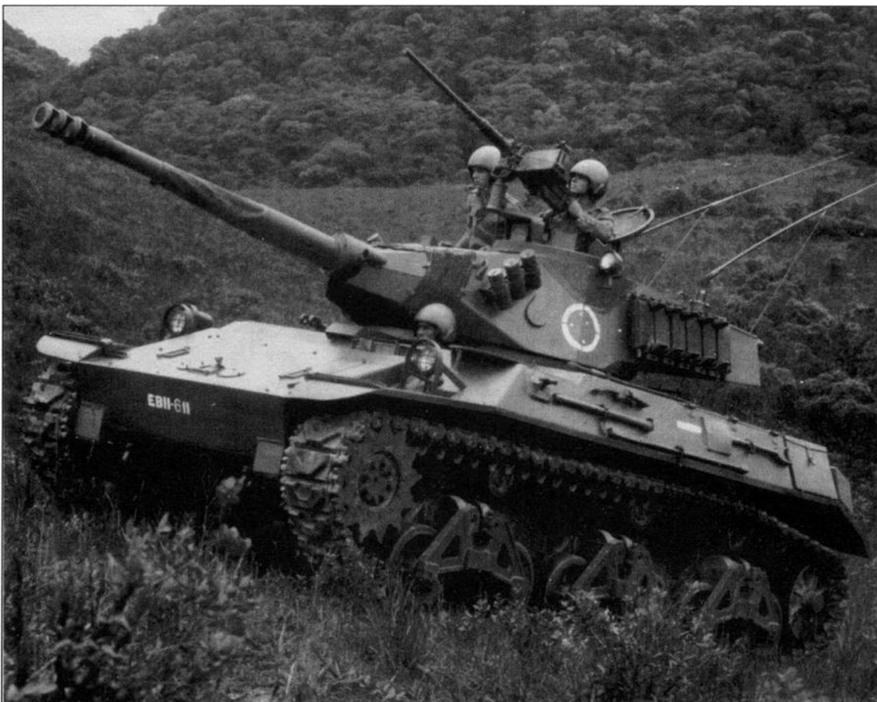
Наследник "Стюарта" — бразильский легкий танк X1A2, вооруженный 90-мм пушкой Cockerill. Начало 1990-х годов
