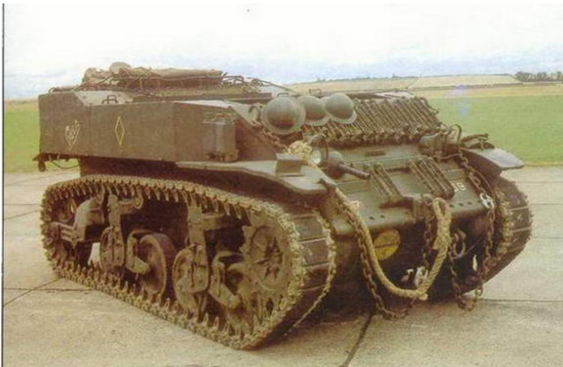
Артиллерийский тягач на базе легкого танка M5A1 Stuart VI. Имперский военный музей, Дуксфорд, Великобритания
