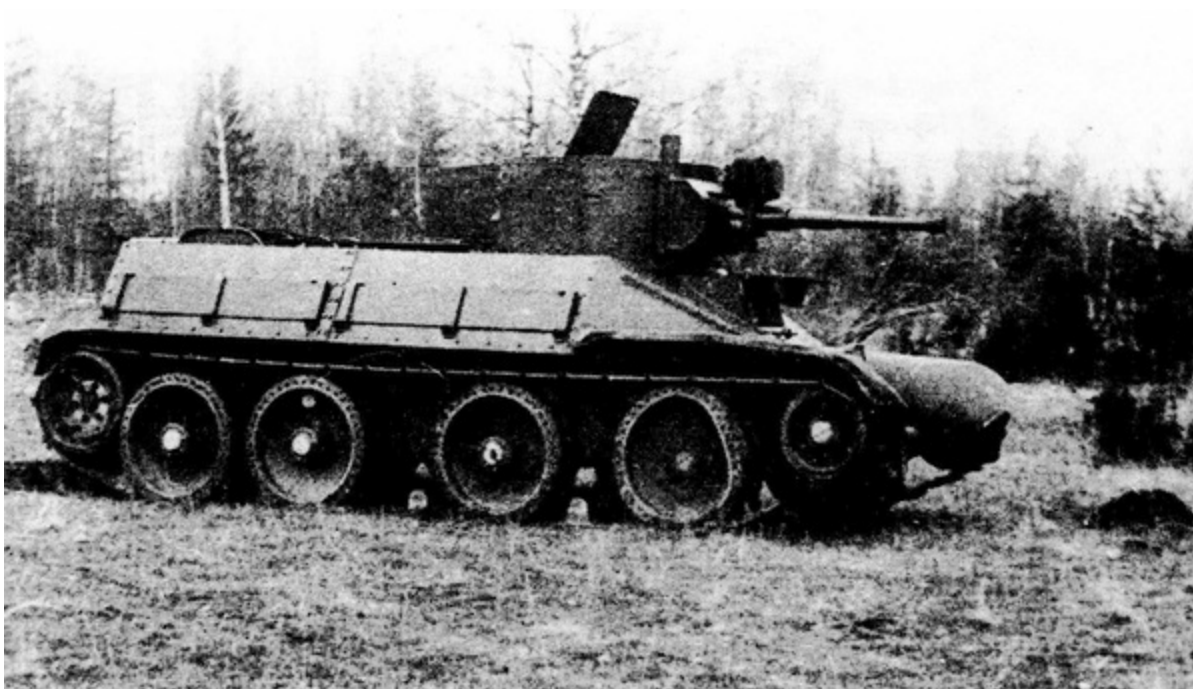
БТ-ИС с дополнительными наклонными бортами. 1937 год.
