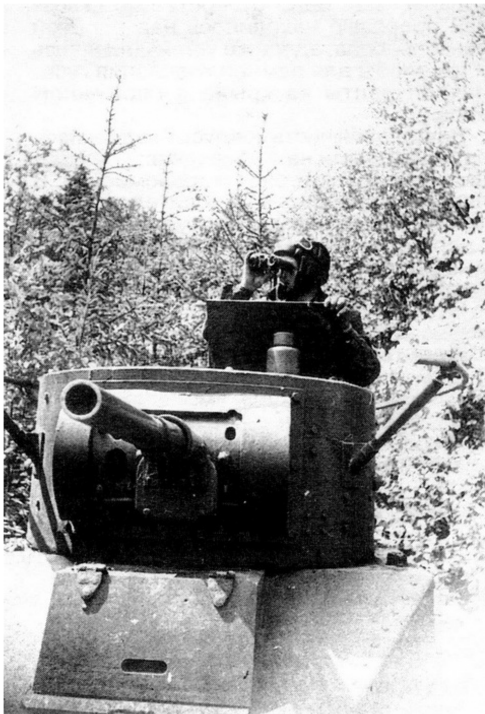
Башня танка БТ-5 с поручневой антенной радиостанции 71-ТК-1.
