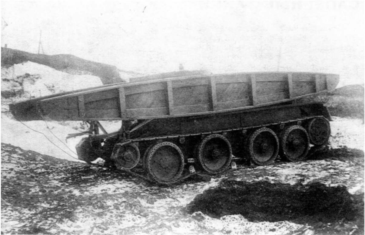
Мостовой танк, построенный по проекту НИИИТ РККА, во время полигонных испытаний. Март 1935 года.
