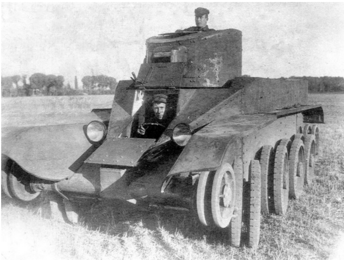
БТ-ИС на испытаниях. У машины на нижнем снимке демонтирована передняя пара опорных катков.
