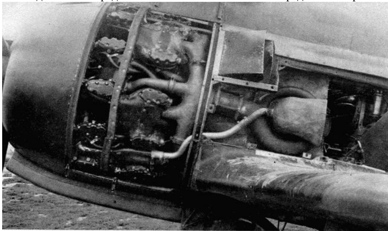
Установка турбокомпрессора ТК-3 на Ла-5ФТК, 1943 г.
