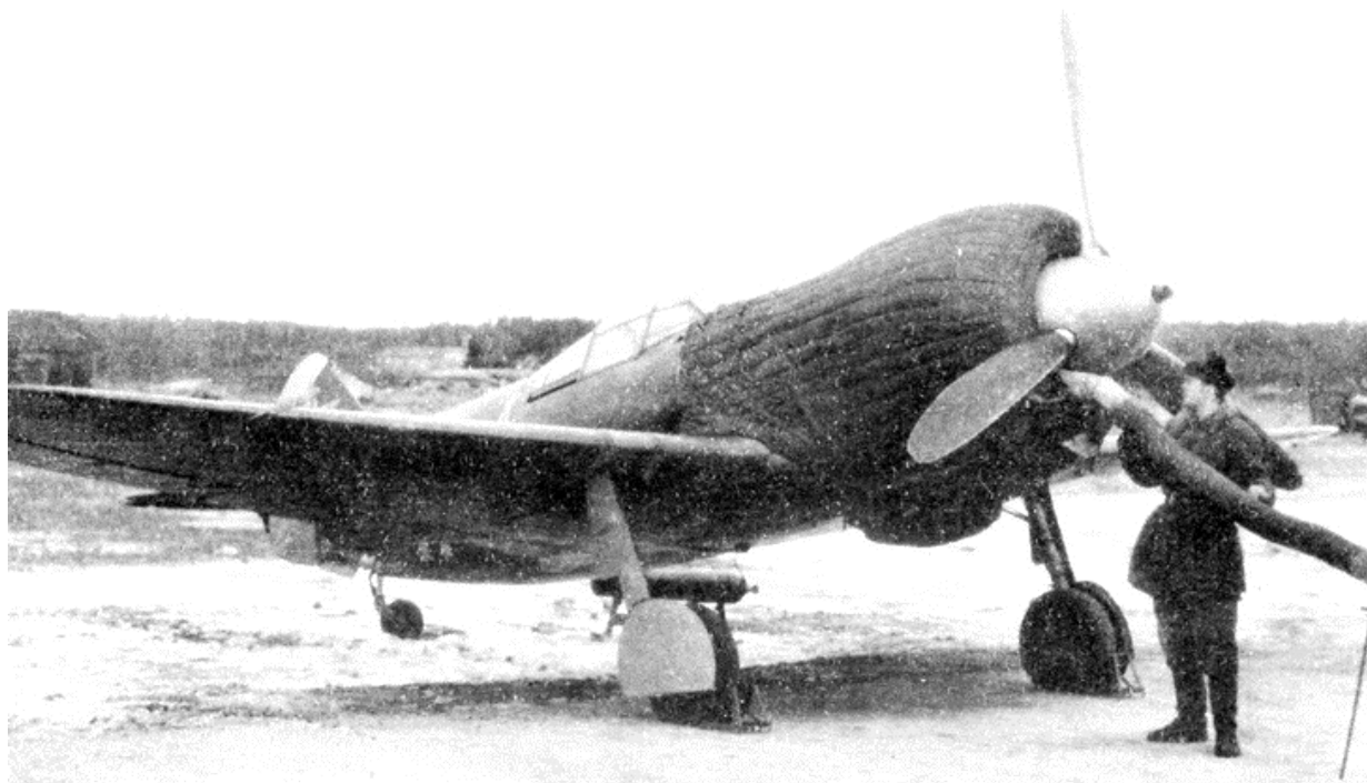
Подогрев двигателя самолета Ла-5ФИ от бензинового обогревателя
