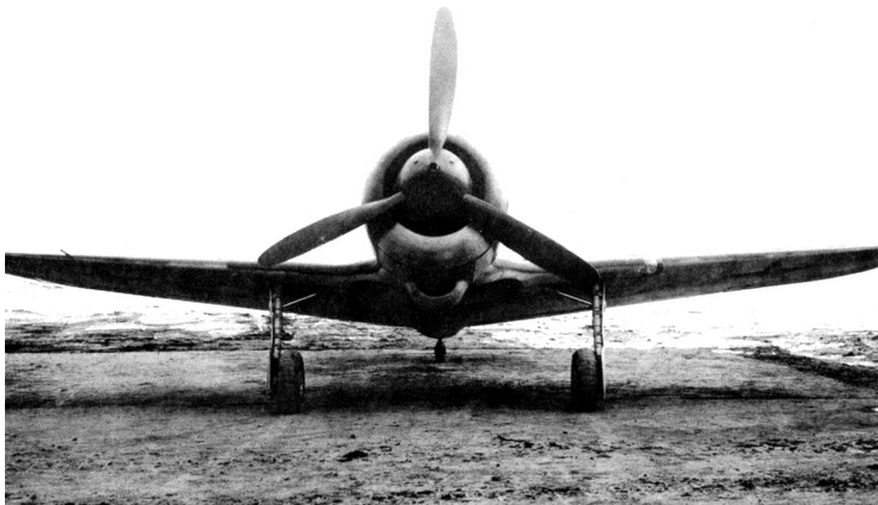
На этом фото и внизу: опытный ЛаГГ-3 с мотором М-82 на совместных испытаниях НКАП и ВВС. Май—июнь 1942 г.
