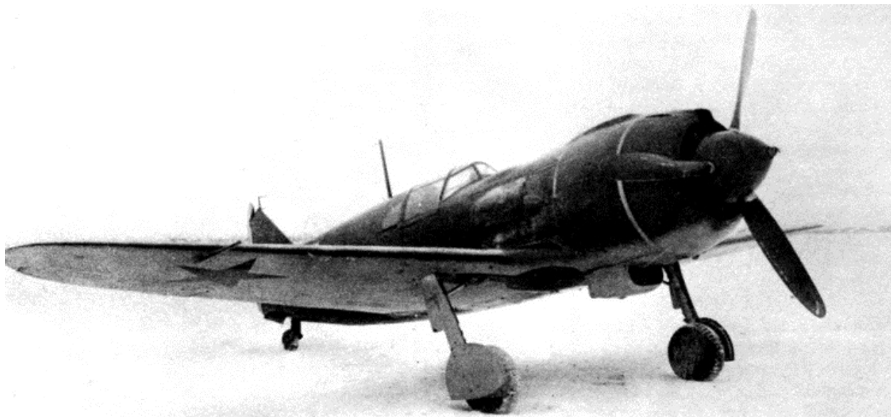
Ла-5 с герметизацией капота по рекомендации ЦАГИ
