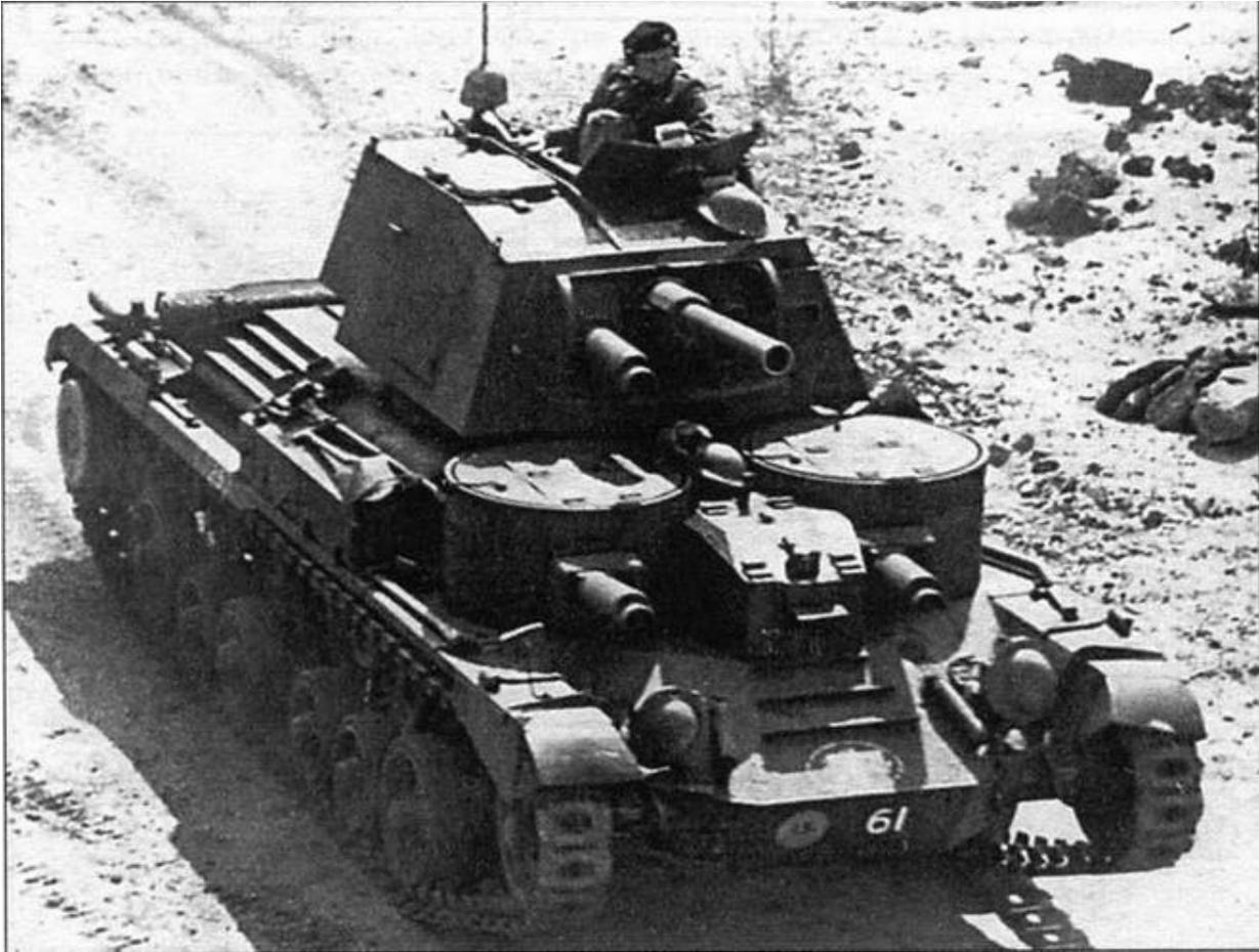
*Крейсерский танк огневой поддержки Mk ICS, вооруженный 3,7-дюймовой гаубицей вместо 2-фунтовой пушки*
