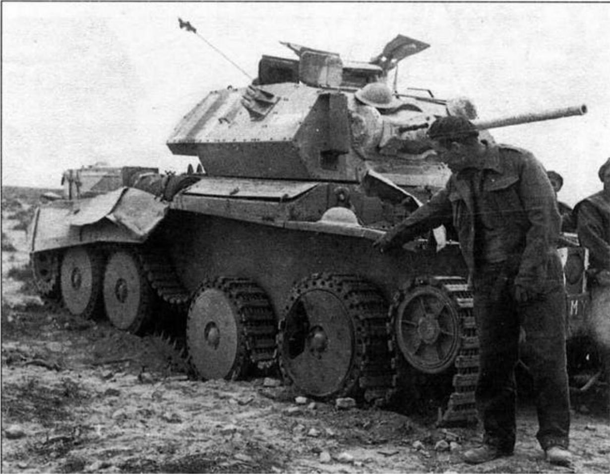
*Экипаж танка Mk IVA осматривает повреждения своей машины, подорвавшейся на mine*
