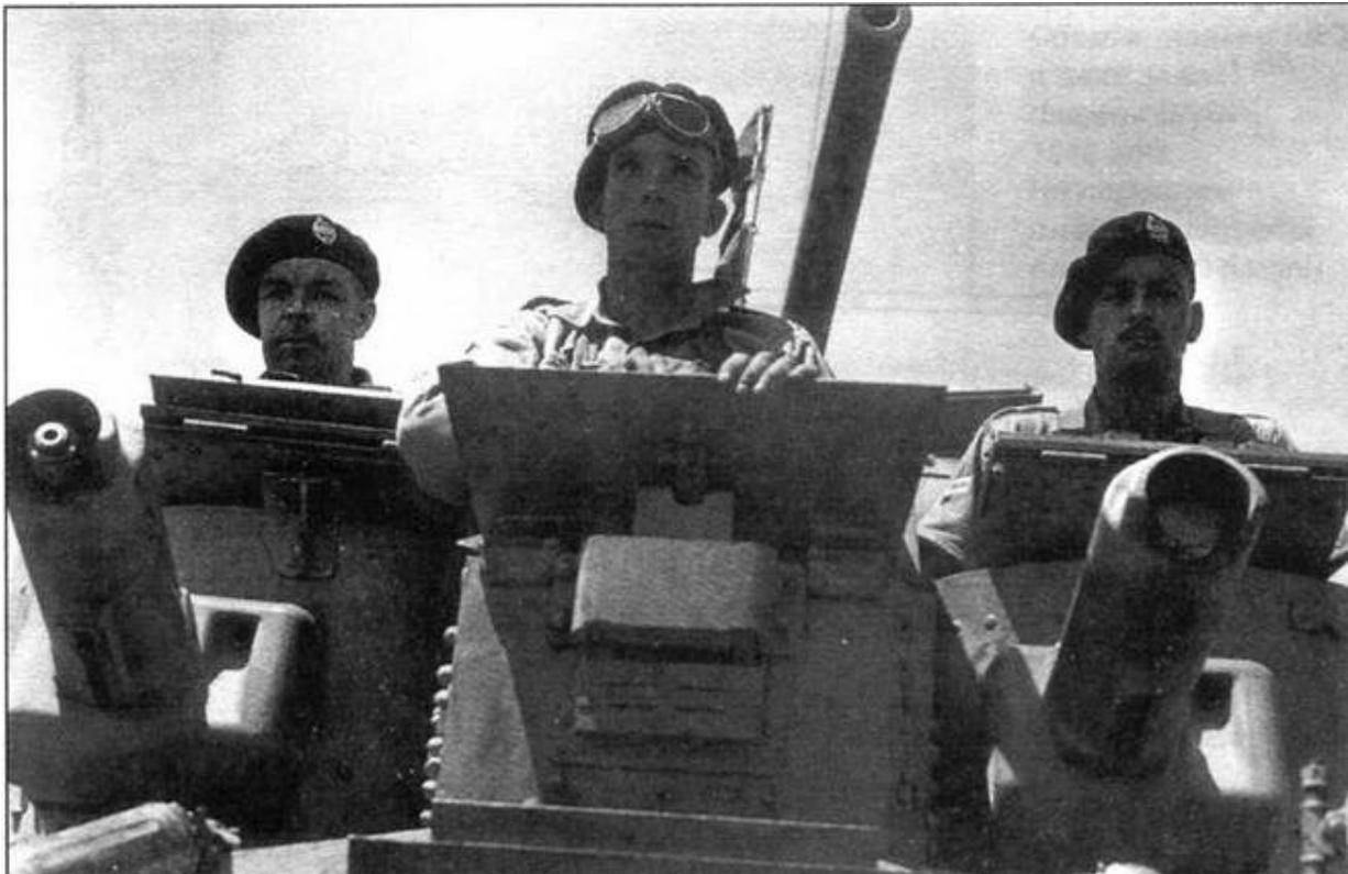
*Механик-водитель (в центре) и оба пулеметчика на своих рабочих местах в танке Mk I. Обращают на себя внимание массивные броневые кожуха пулеметов Vickers*
