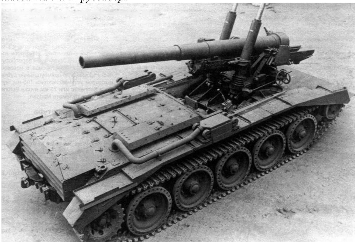
*Опытный образец 5,5-дюймовой самоходкой пушки на базе «Крусейдера»*
