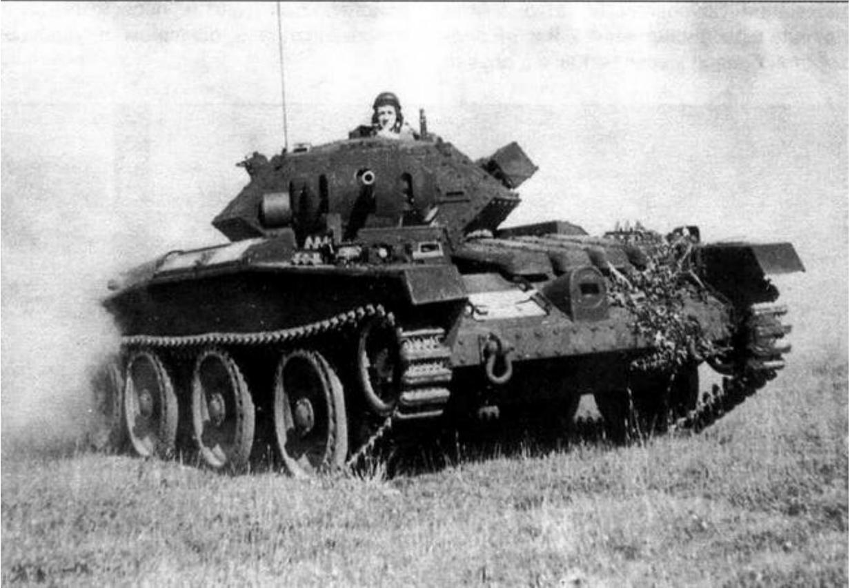
*Танк «Ковенантер» в клубах выхлопного дыма идет в учебную атаку. Характерной формы выступ на верхнем лобовом листе корпуса — кожух фары. На этом танке отсутствуют защитные диски на опорных катках*
