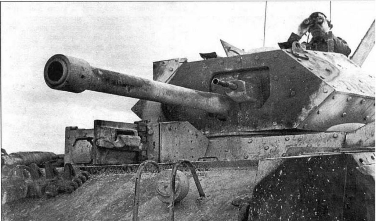
*Характерной деталью внешнего вида «Крусейдер III» была внутренняя маска спаренной установки 6-фунтовой пушки и пулемета*
