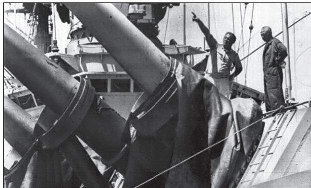
Взрыв в башне тяжелого крейсера «Ньюпорт Ньюс» полностью вывел из строя среднее 203-мм орудие (на фото сверху). Ремонтировать его было признано нецелесообразным - проще оказалось демонтировать ствол, а на лобовой части башни установить броневую заглушку, превратив ее из трех- в двухорудийную (на фото внизу и на с.269)
