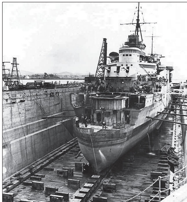
Поврежденный «Ливерпуль» в сухом доке. Хорошо видна форма временной носовой оконечности
