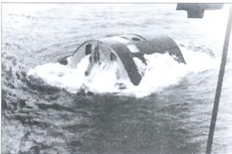
Испытание всплывающей спасательной камеры АПЛ пр.705
