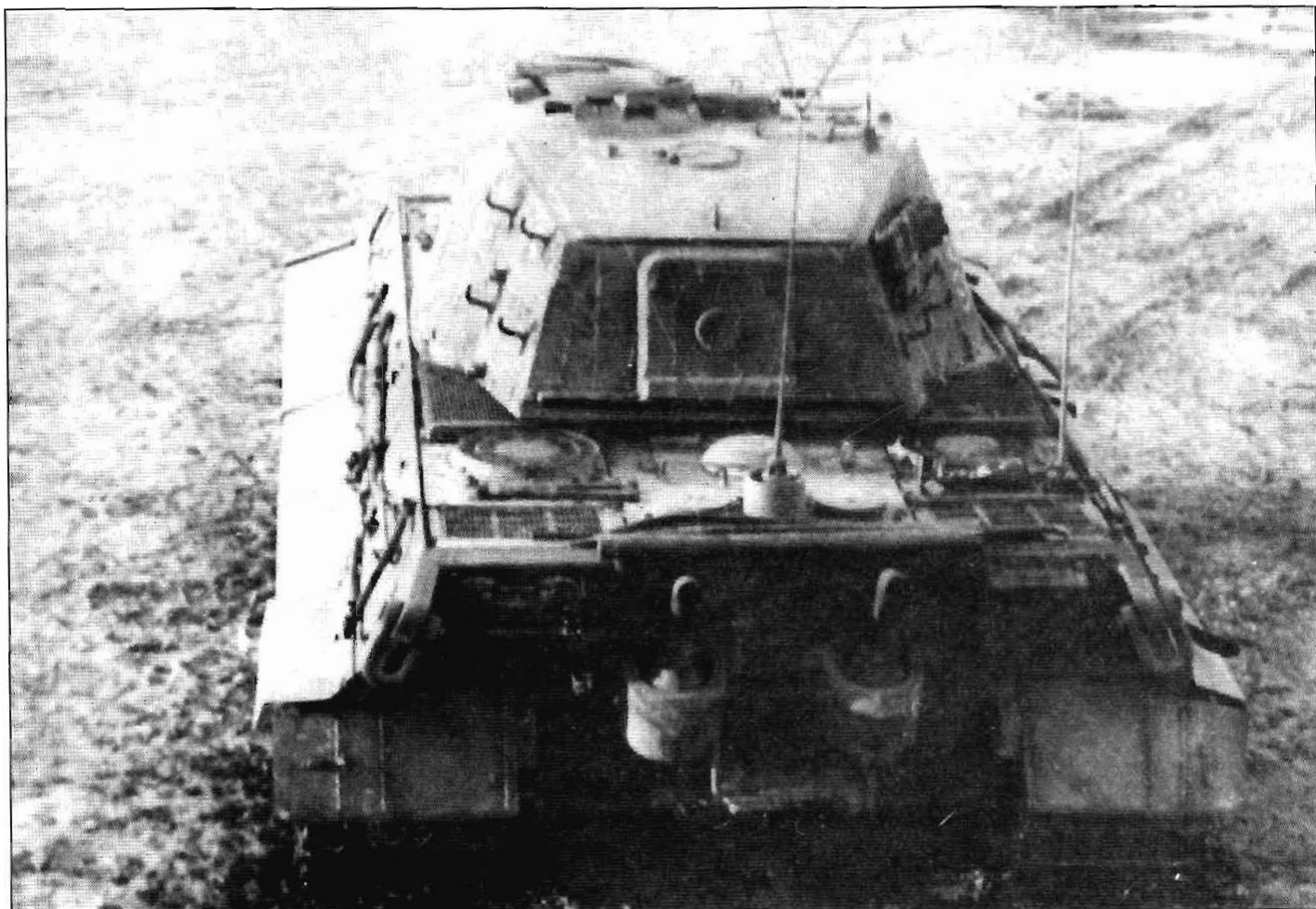
PzBefWg Tiger Ausf. B («502») из штаба sPzAbt 501. На верхней кромке кормовой бронеплиты виден цилиндрический контейнер для удлинителей антенны.
