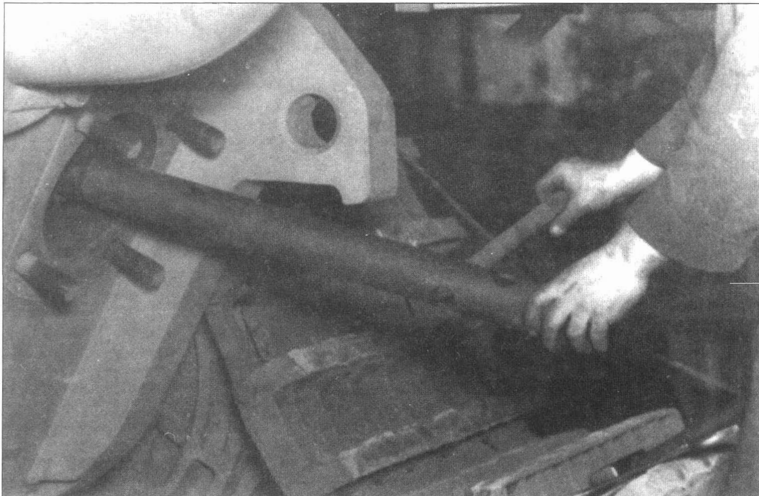
Регуляция положения опорных катков проходила через люки в кормовой бронеплите с помощью специального ключа.
