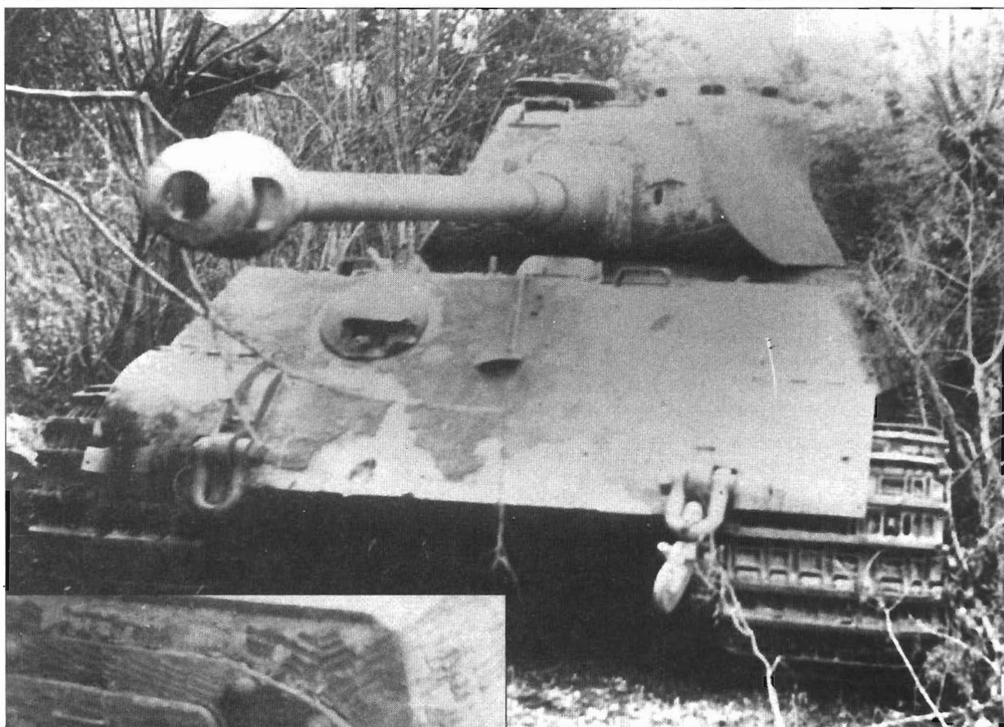
На фото представлены «Королевские Тигры» с башней Порше. Машины выпуска апрель-май 1944 г. из 1-й роты 503-го тяжелого танкового батальона. Обратите внимание на составной ствол орудия, монокулярный прицел наводчика и боевые гусеницы Gg 26/800/300. Торсион кормового башенного люка защищен полукруглыми броневыми накладками, которые тоже покрыты циммеритом.
