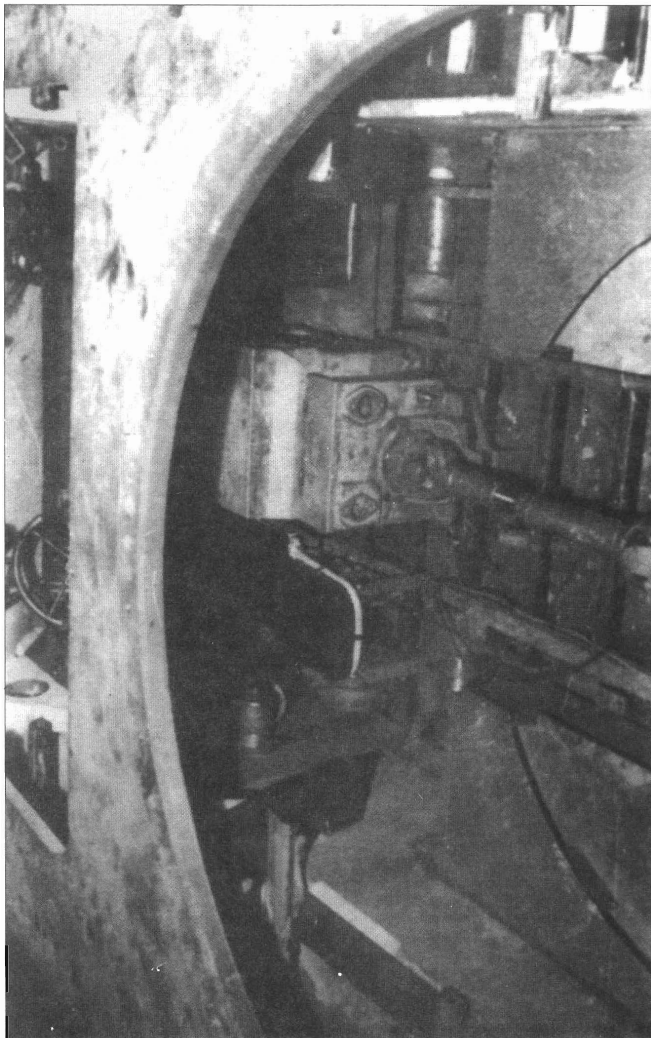
Передняя часть боевого отделения. Места механика-водителя и стрелка-радиста. В центре коробка передач, соединенная с двигателем карданным валом. На полу видны торсионы.
