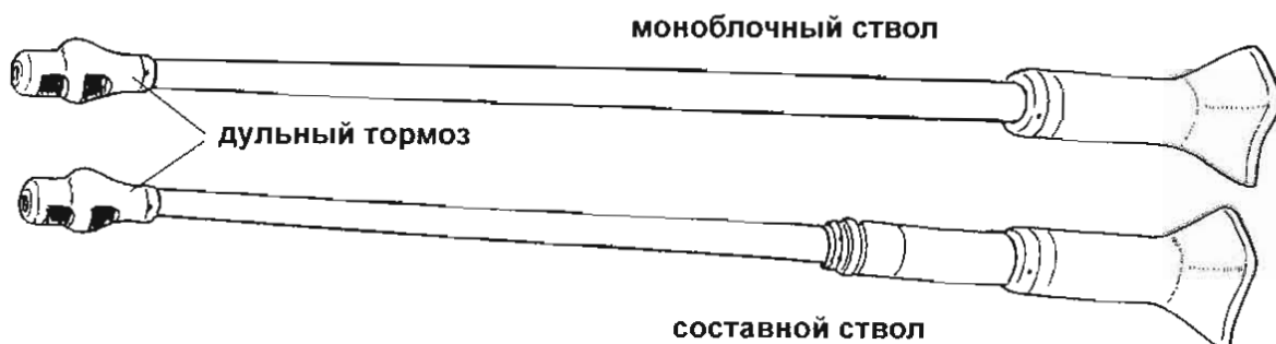
Детали конструкции «Королевских Тигров» с башней Порше
