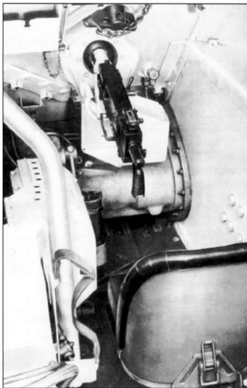
Рабочее место помощника механи- ка-водителя, он же — пулеметчик
