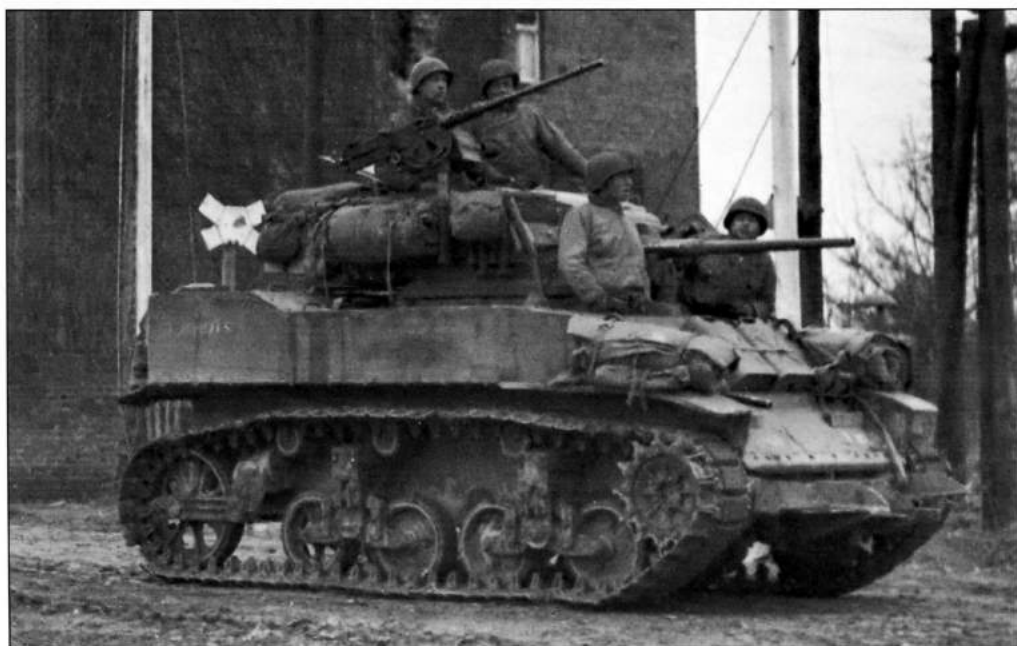
M5A1 из 4-й кавалерийской группы на улице города Ангельсдорф, 28 февраля 1945 года. Вместо штатного 7,62-мм пулемета Browning M1919A4 на этой машине установлен 12,7-мм пулемет Browning M2
