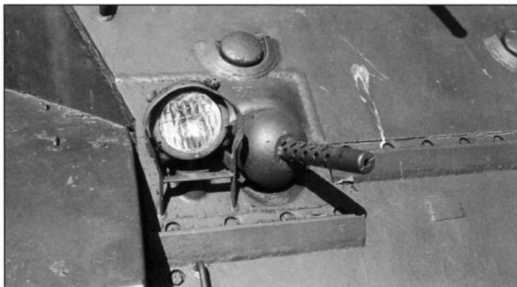
Шаровая установка курсового пулемета танков M5 и M5A1
