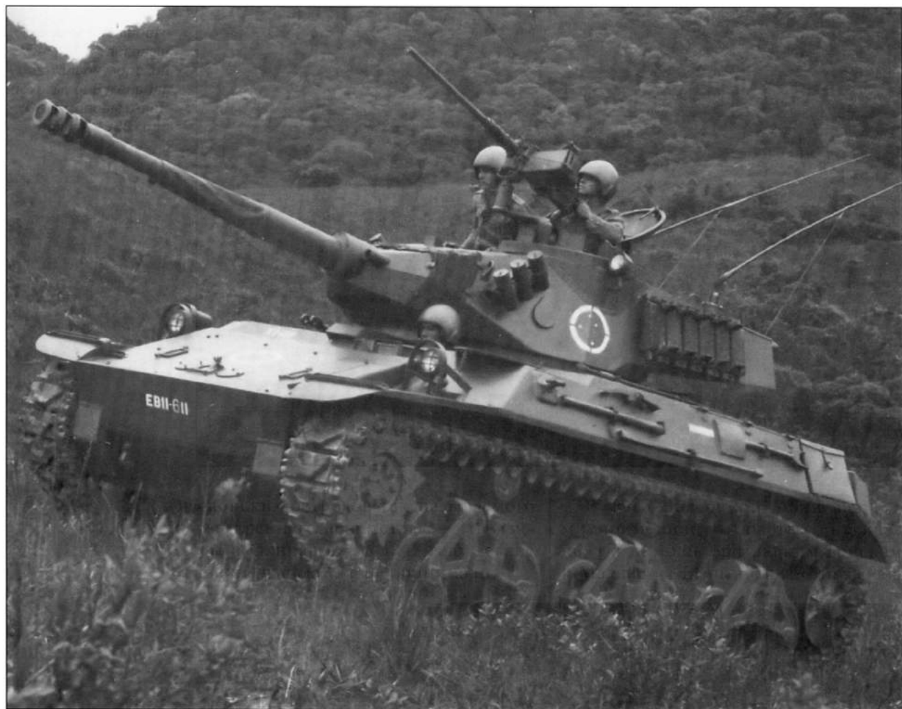
Легкий танк Х1А2 — у этой машины от американского прототипа сохранились только отдельные элементы ходовой части
