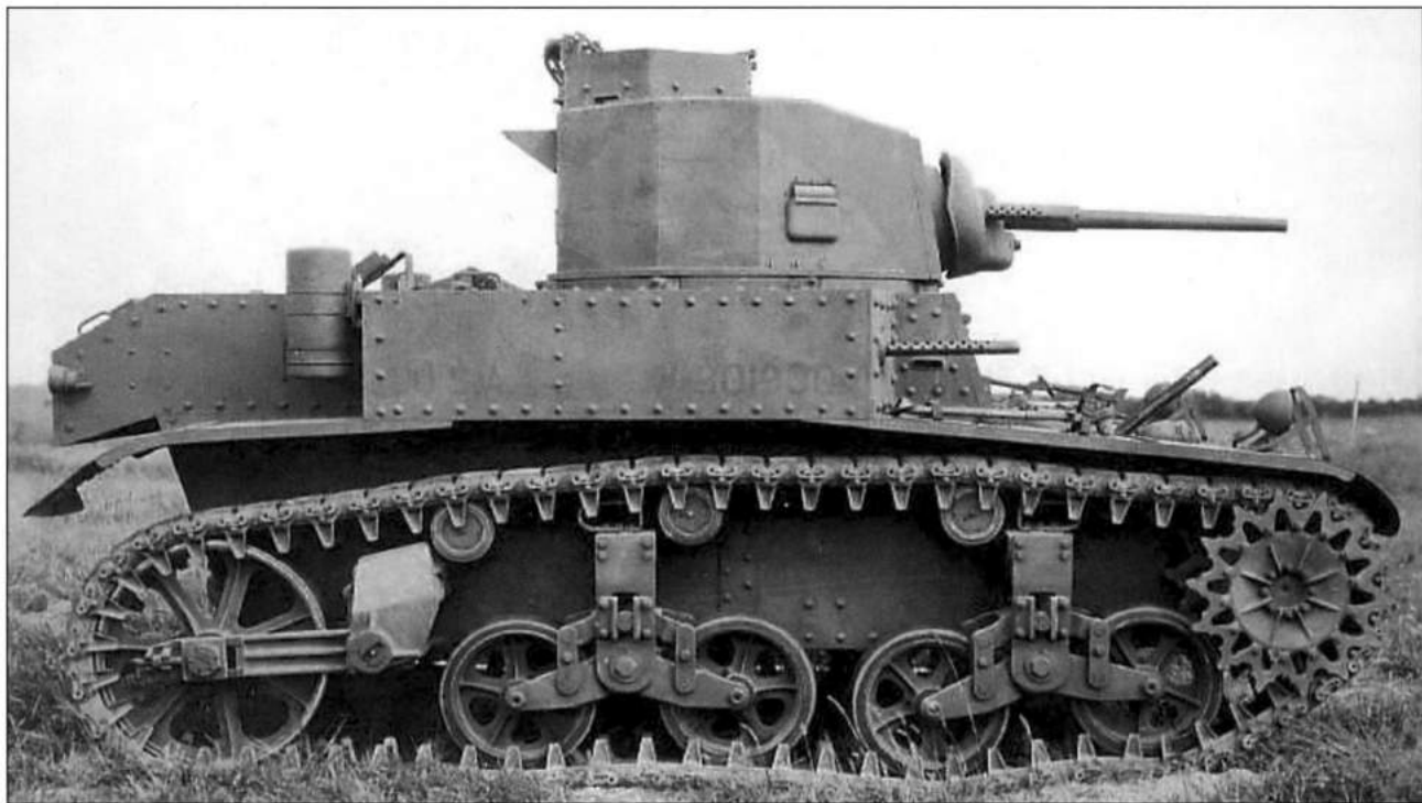
Легкий танк МЗ со сварной башней
