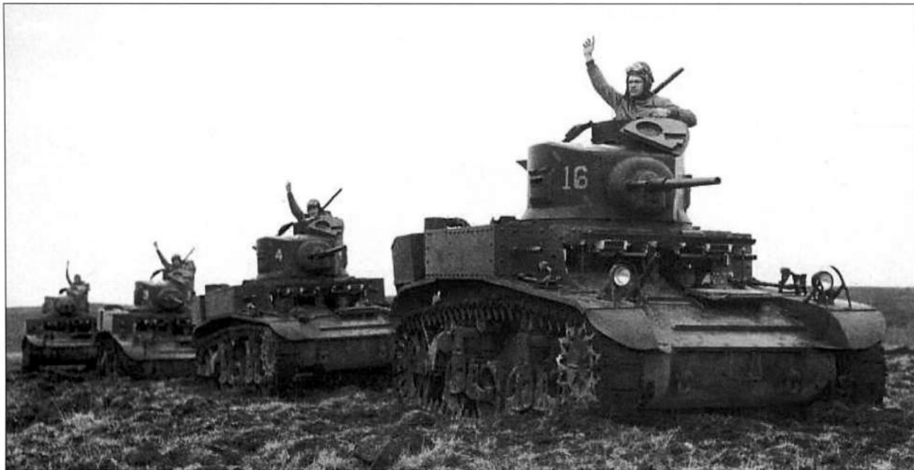
Легкие танки М3 позднего выпуска с подковообразными сварными башнями. 1942 год
