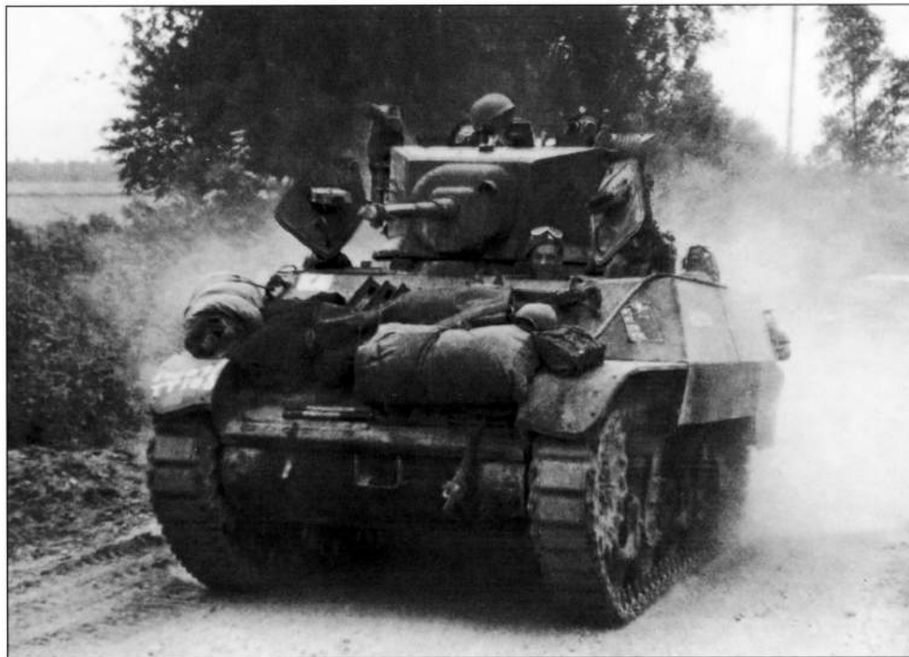
К моменту высадки в Нормандии стандартным разведывательным танком в британских танковых дивизиях стал Stuart V (M3A3). На снимке: Stuart V 7-й танковой дивизии «Крысы пустыни», Нормандия, 15 июня 1944 года
