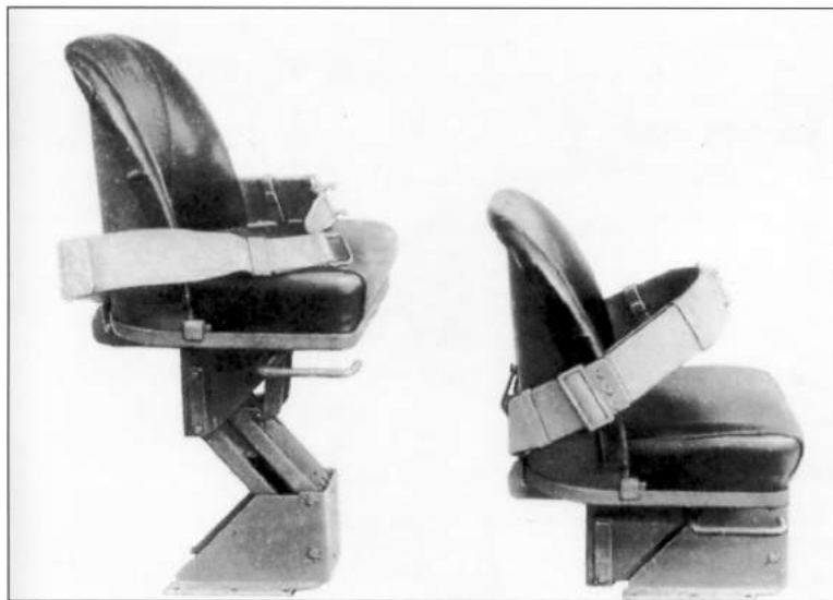
Сиденье механика- водителя на М3А3 имело два положения: для вождения с открытым и закры- тым посадочным люком
