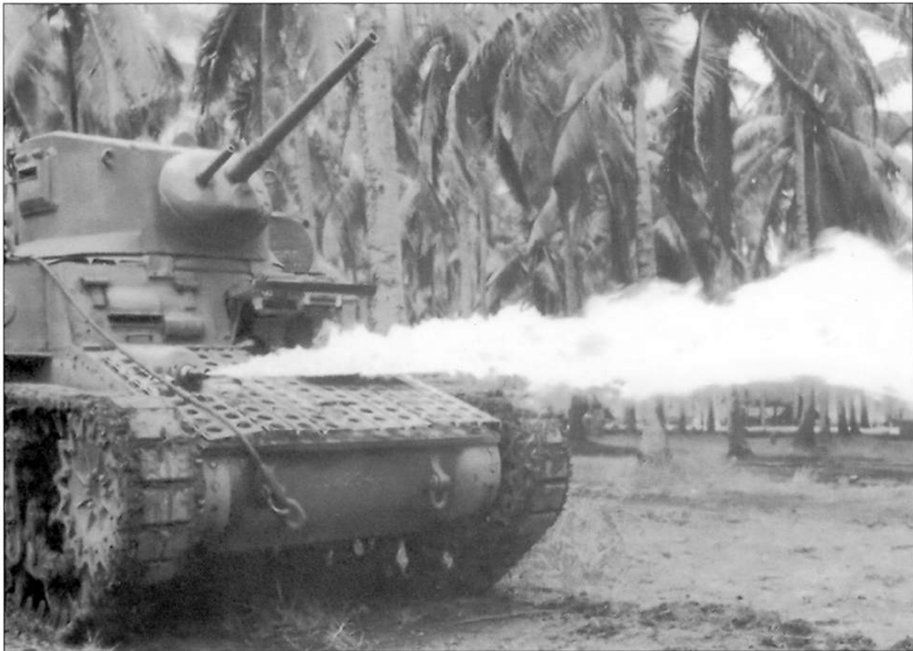
На части танков М3А1 огнемёт был установлен не в башне, а в корпусе, вместо курсового пулемёта. При этом основное вооружение – 37-мм пушка – сохранялось
