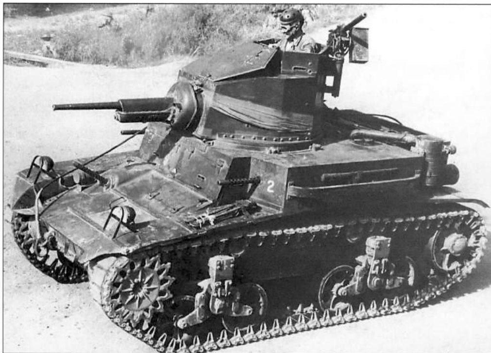
Легкий танк M2A4 из состава 2-й танковой дивизии армии США. 1941 год. Эта машина оснащена дизельным двигателем Guiberson T-1020
