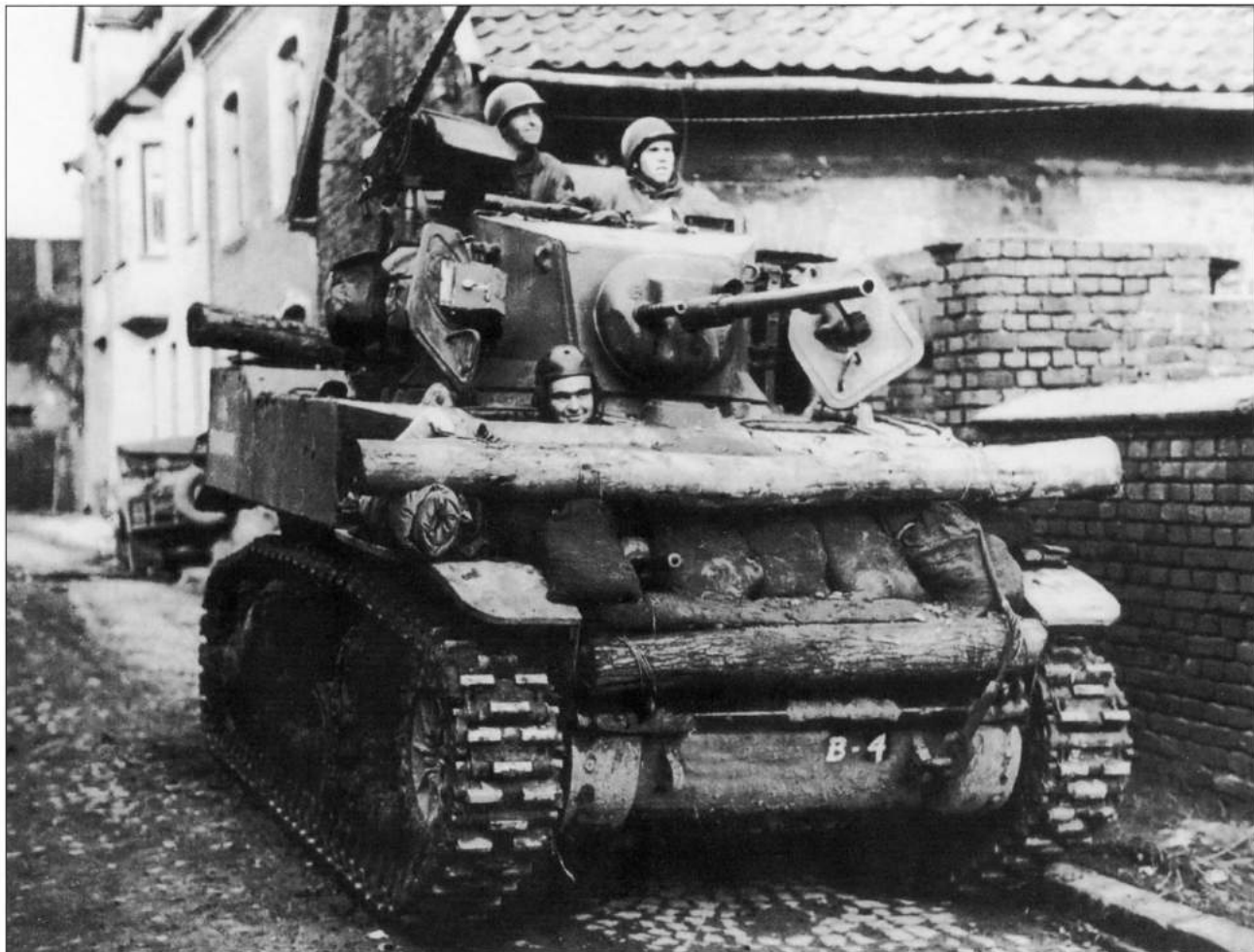
Легкий танк M5A1 из состава 67-го танкового полка 2-й американской танковой дивизии. Германия, ноябрь 1944 года. С помощью бревен и мешков с песком экипажи старались хоть как-то повысить защищенность своих машин
