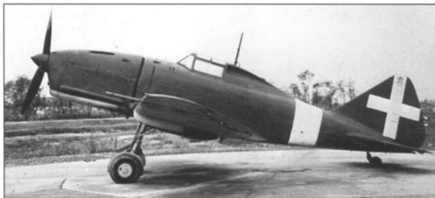
Re.2001 с мотором «Изотта-Фраскини» «Дельта»
