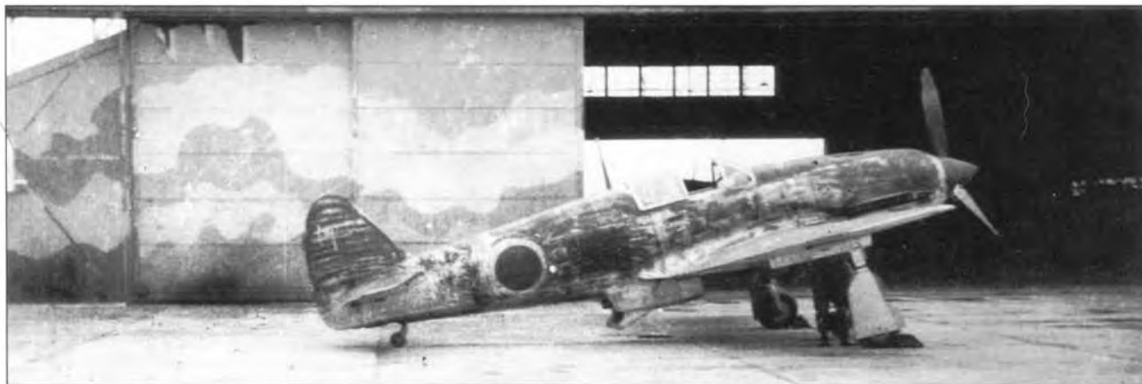
Ки-61 стал единственным японским истребителем с двигателем жидкостного охлаждения
