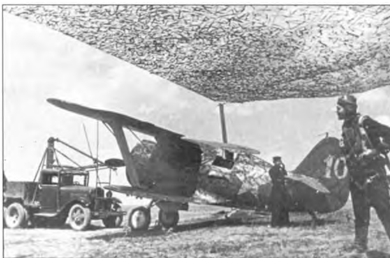
Запуск двигателя И-153 при помощи автостартера
