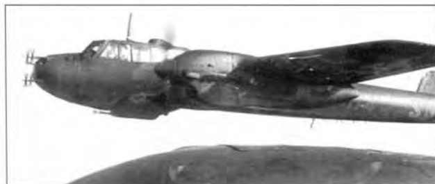
Характерными чертами истребительного варианта Do 215 были «рога» антенн РЛС и подфюзеляжный обтекатель пушек
