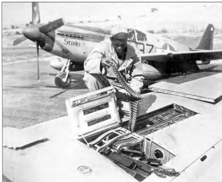
Оружейник загружает пулеметную ленту для крыльевых пулеметов истребителя P-51B «Мустанг»
