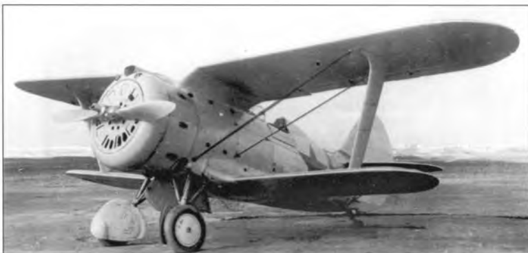
И-153 отличался характерным изломом верхнего крыла типа «чайка»
