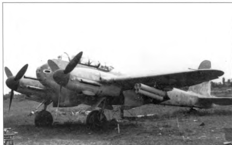
Самолет Me 210 с реактивными снарядами WvGr.21, использовавшимися для ударов по плотным боевым порядкам бомбардировщиков
