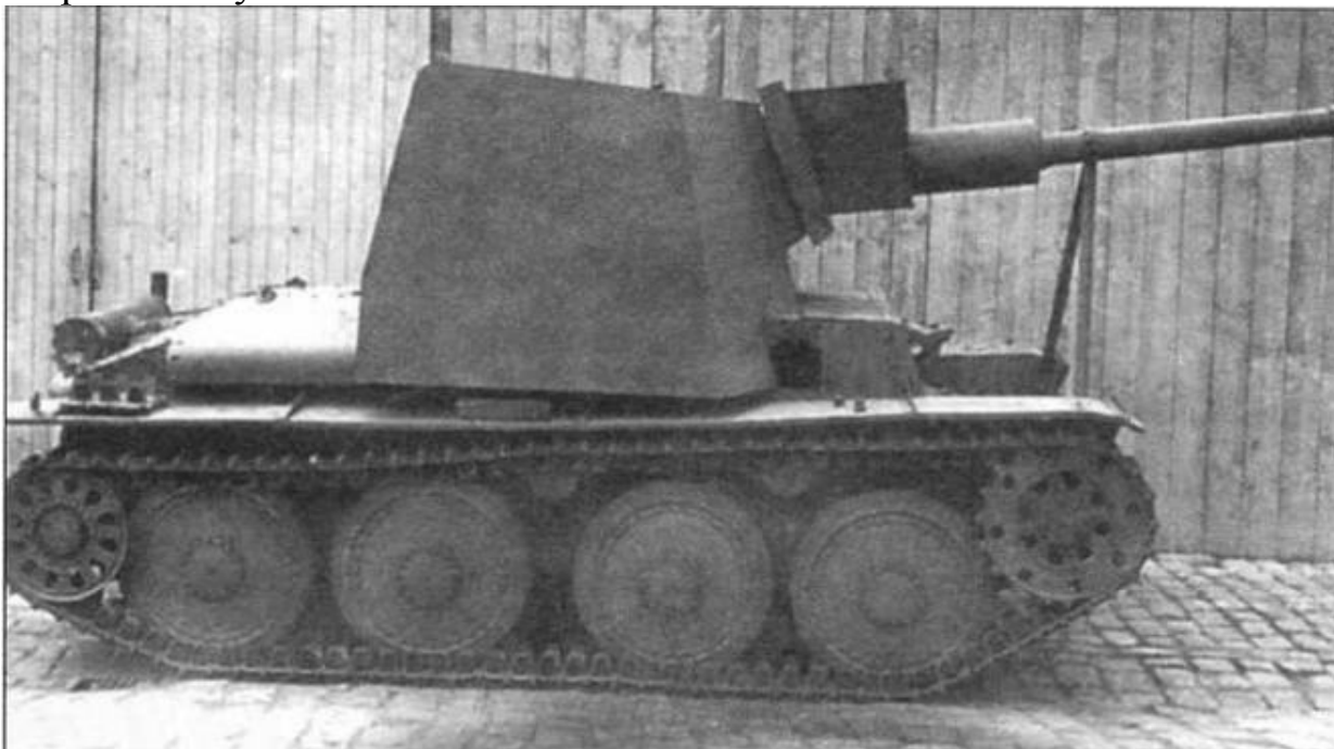
Прототип самоходной установки, вооруженной 75-мм истребительной пушкой StuK 40 во дворе завода фирмы ВММ
