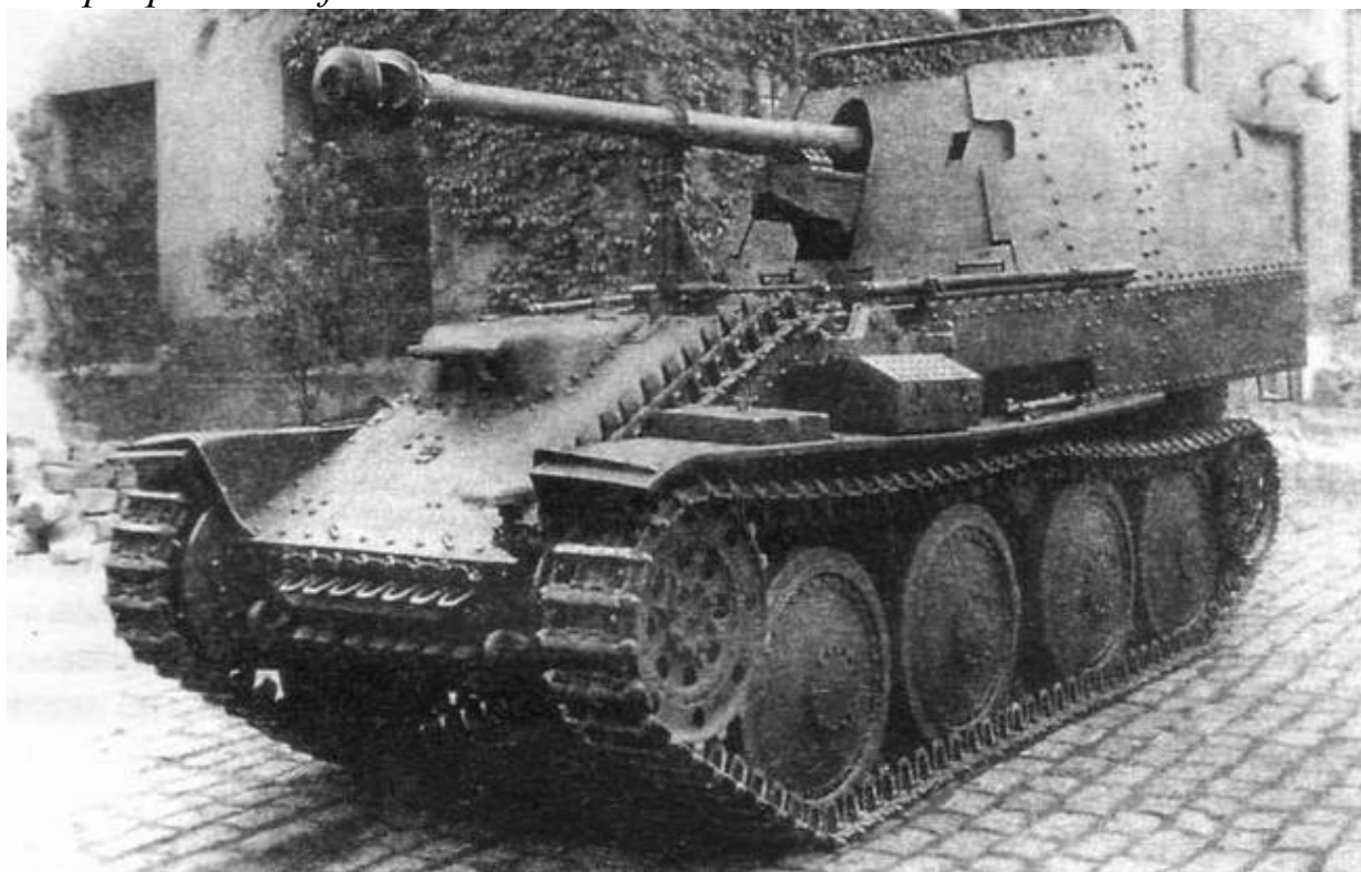
Самоходная установка «Мардер III» Ausf.M во дворе завода ВММ. Хорошо видна литая рубка механика-водителя
