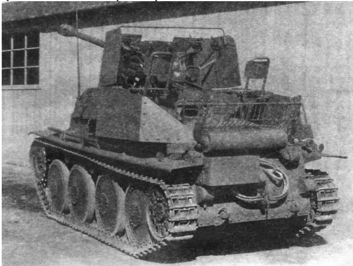
Истребитель танков Sd.Kfz. 139 «Мардер III». Хорошо видны сиденья членов орудийного расчета, размещенные в положении походному
