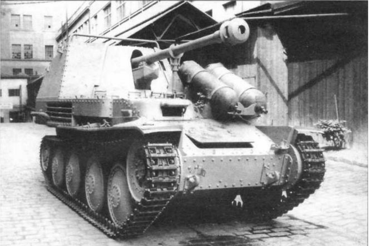
Учебная самоходка Sd.Kfz. 138 Ausf.M с двигателем, работавшим на газе
