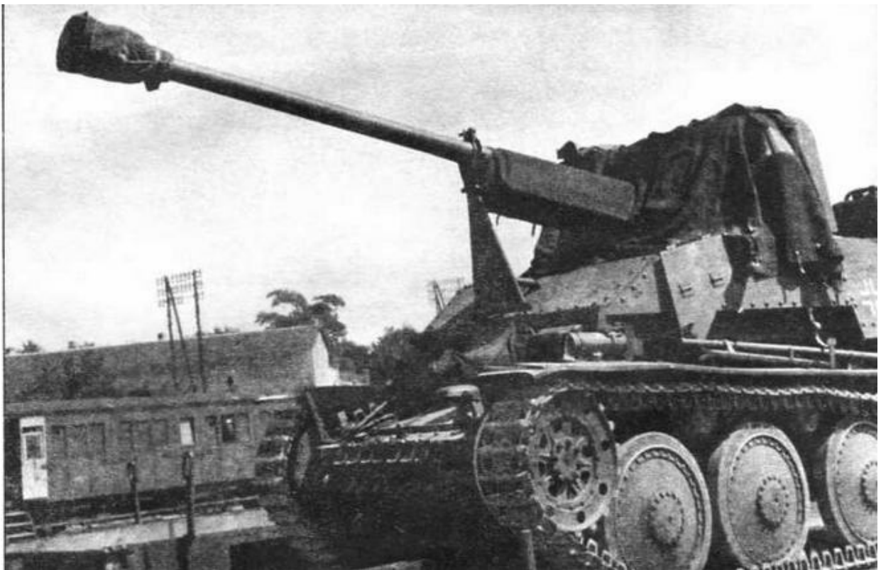
Истребитель танков Sd.Kfz.139 «Мардер III» с боевым отделением, накрытым брезентом (в центре). «Мардер III» на железнодорожной платформе. Хорошо видна откиннутая крышка люка радиста (внизу)
