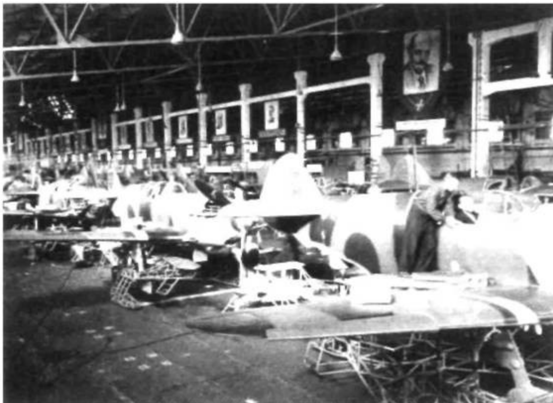
Сборка самолетов ЛаГГ-3 и Ла-5 в цеху завода 21. Не останавливая производства, завод перешел на выпуск нового самолета.
