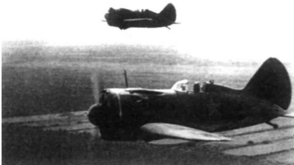
Последняя серийная модель И-16 тип 29. Всего на заводе 21 было построено 650 таких самолетов. На этом «ишачке» был установлен мотор М-63. Вооружение самолета составляли три синхронных пулемета: 2 ШКАС калибра 7,62 мм и один БС 12,7 мм.
