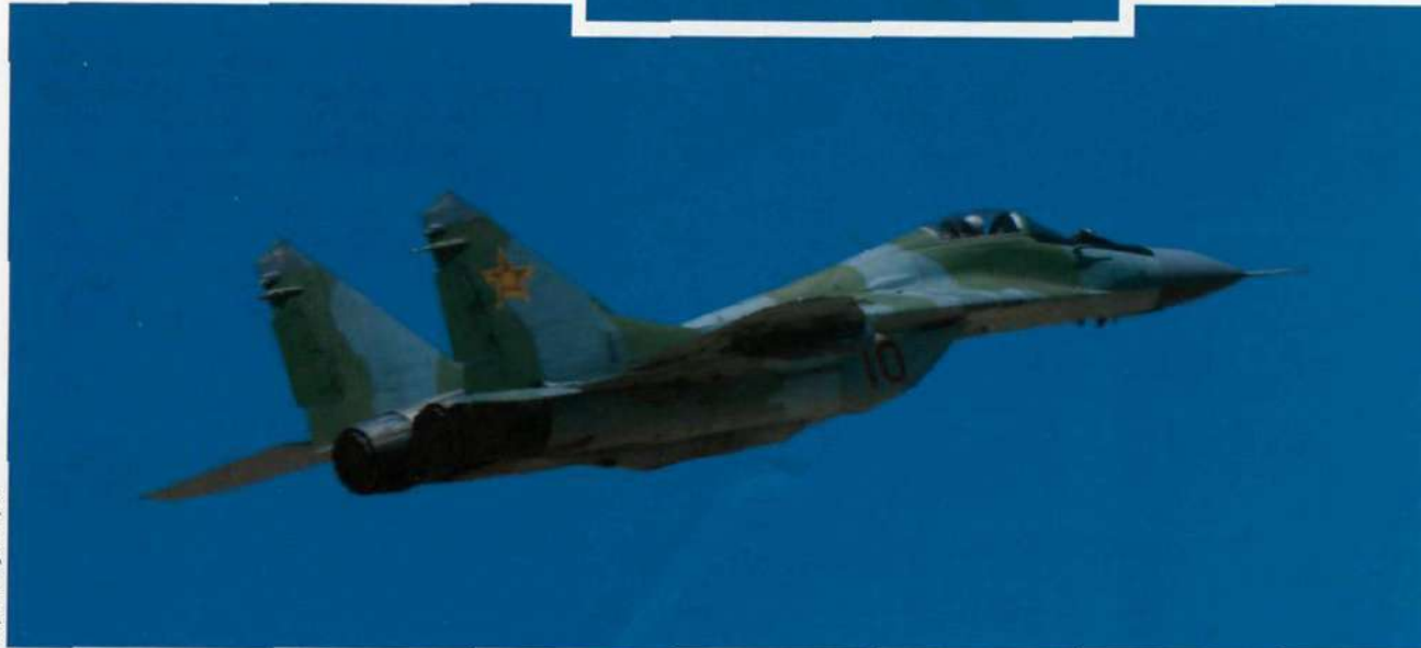
МиГ-29 бортовой №10 600-я гв. АБ. Как и большинство казахских МиГов, истребитель получил новый камуфляж и опознавательные знаки. На данном истребителе ОЗ нанесены лишь в 4 позиции — на киях и на верхних плоскостях крыльев. На нижних плоскостях крыльев старые ОЗ ВВС СССР закрашены. Аэродром «Жетыген».
