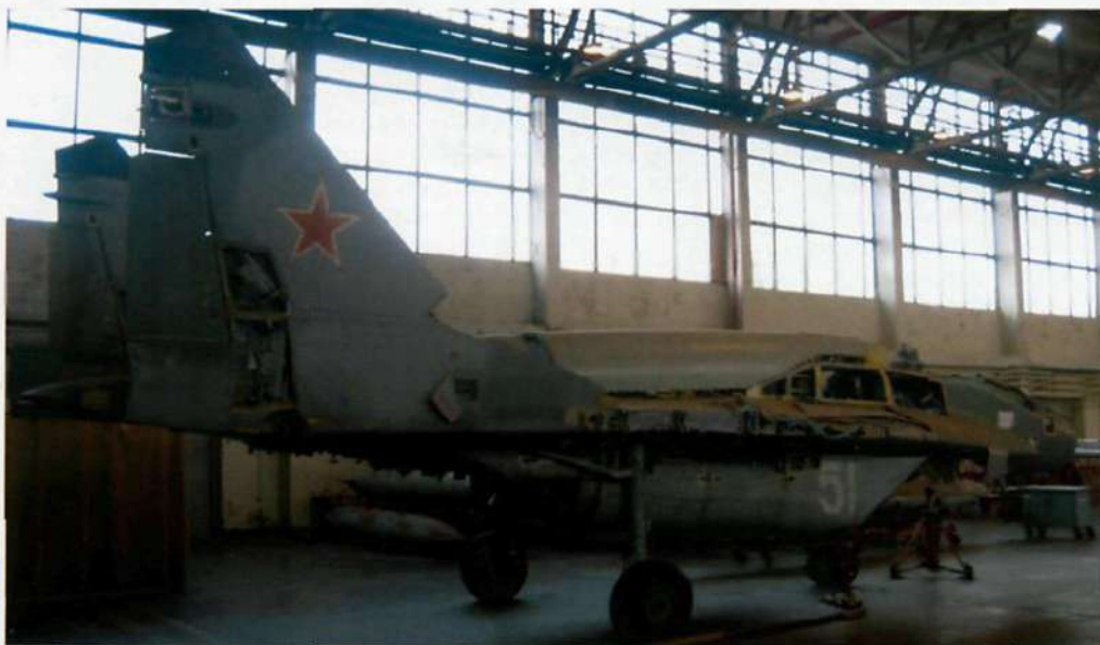
Недостроенный корпус МиГ-29 №51 в цехе окончательной сборки 121-го АРЗ. До приостановки работ на самолете успели смонтировать штангу дозаправки топливом в полете, накладной глот с увеличенным топливным баком и тормозным щитком.
