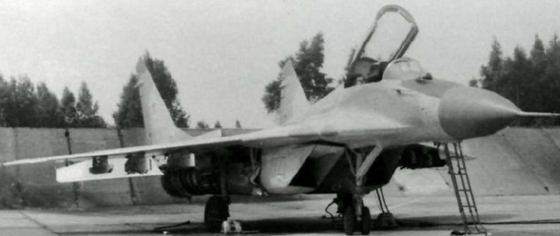
МиГ-29 бортовой №14 (синий) установлен на газовой площадке ТЗЧ аэродрома «Шауляй». Капоты двигателей сняты и к самолету подключены кабели питания от стационарной электросети.
