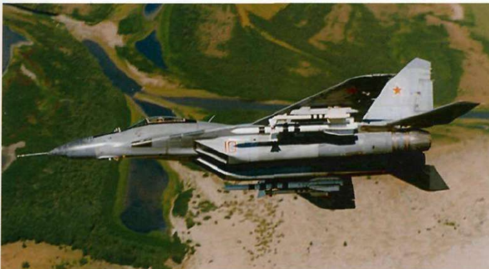
МиГ-29 бортовой №10, принадлежащий ГЛИЦ в Ахтубинске. Каркас откидной части фонаря кабины летчика выкрашен в черный цвет. Возможно, это сделано для лучшего распознавания изображения самолета на киноплёнке. Над жаропрочной накладкой пушечной установки видны блеклые остатки эмблемы КБ «МиГ».
