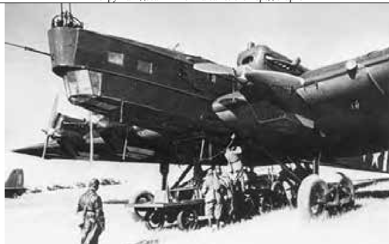
Подвешивание автомобиля-пикапа под самолёт ТБ-3 на киевских манёврах, 1935г.
