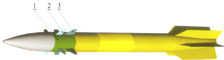
Рис. 6.29. УАС Vulcano-B: 1 – рулевой блок; 2 – дестабилизатор; 3 – аэродинамический руль
