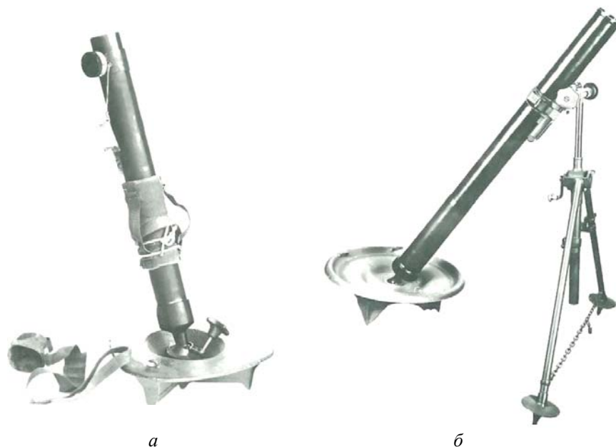
Рис. 7.9. Малокалиберные минометы: а – 60-мм миномет без сошек; б – 81-мм миномет с коротким стволом
