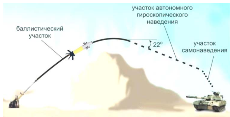
Рис. 6.23. Траектория УАС с участками автономного гироскопического и конечного самонаведения
