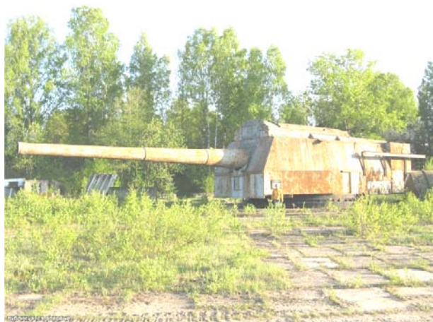
Рис. 9.18. 406-мм орудие Б-37 на испытательном станке МП-10
