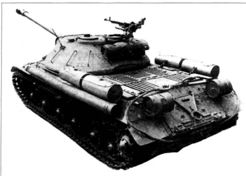
ИС-3. Ввод антенны расположен на наклонной стенке башни - характерная деталь машин первых выпусков (Фото из коллекции Г. Петрова) ИС-3
