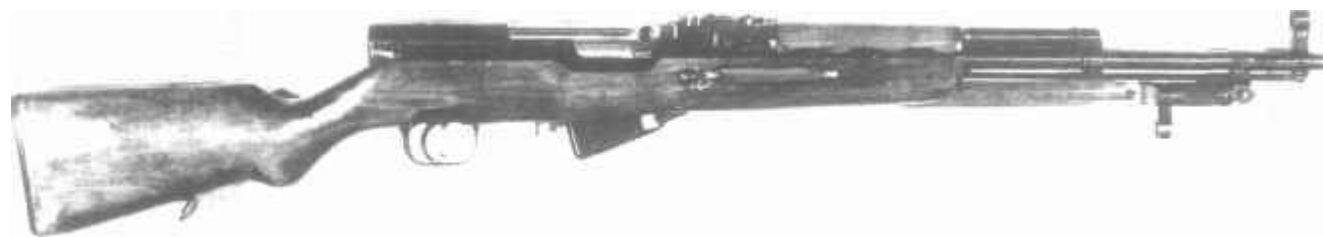
7,62-мм самозарядный карабин системы Симонова образца 1945 г. SKS-45
