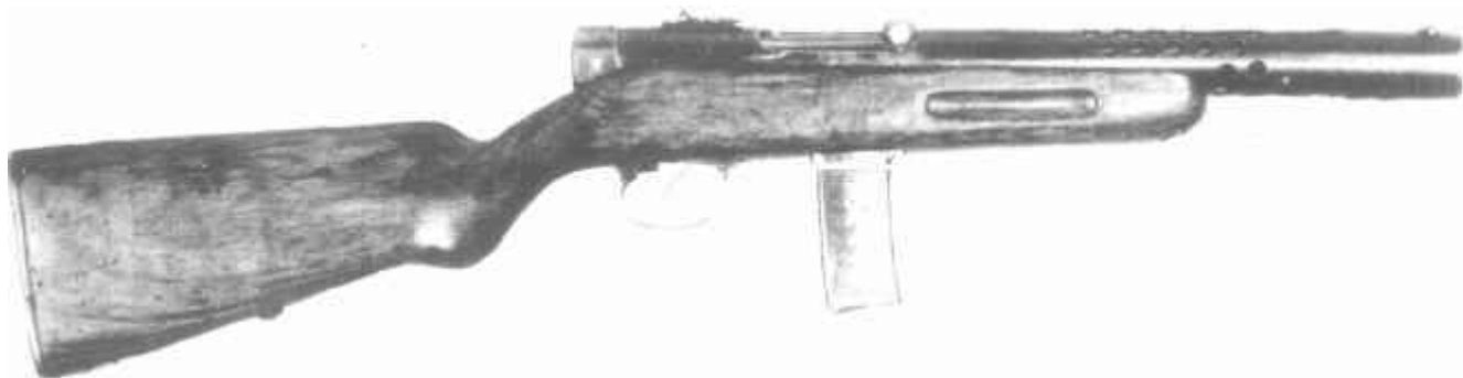
7,62-мм пистолет-пулемет системы Токарева, опытный образец 1931 г.
