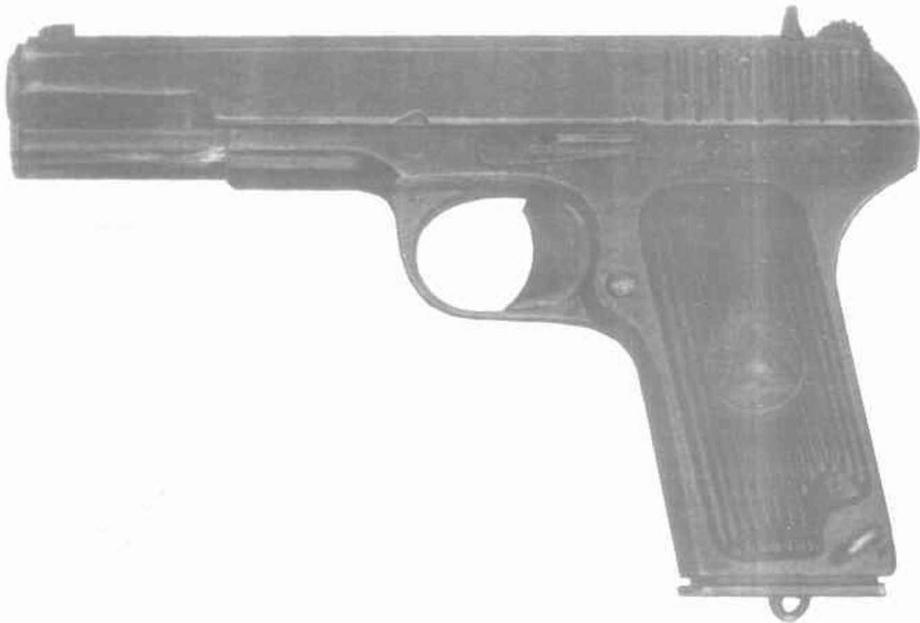
7,62-мм пистолет системы Токарева образца 1933 г. ТТ
