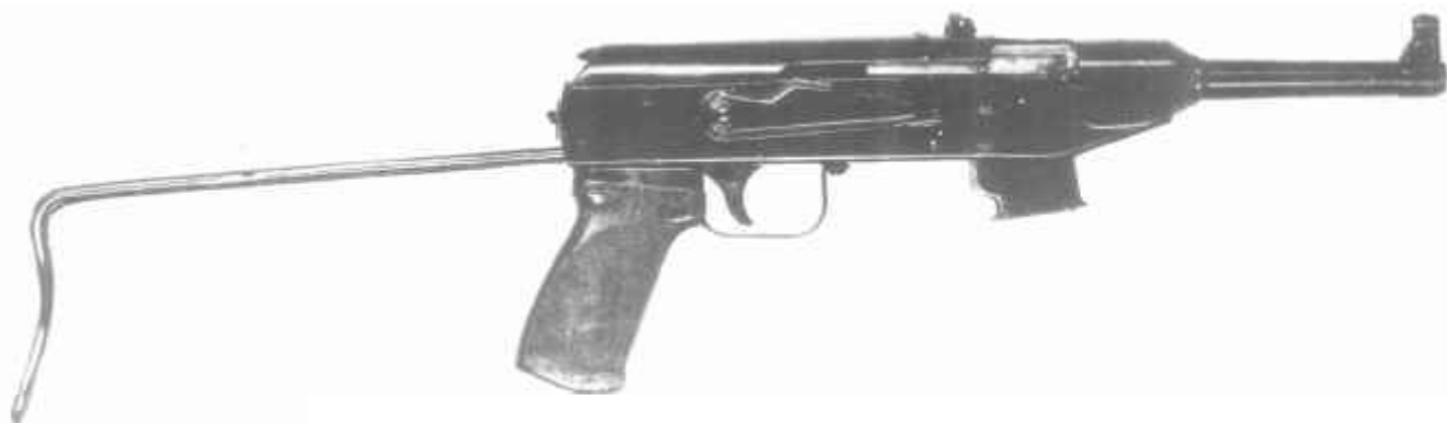
9,0-мм пистолет-пулемет системы Калашникова, опытный образец 1947 г.
