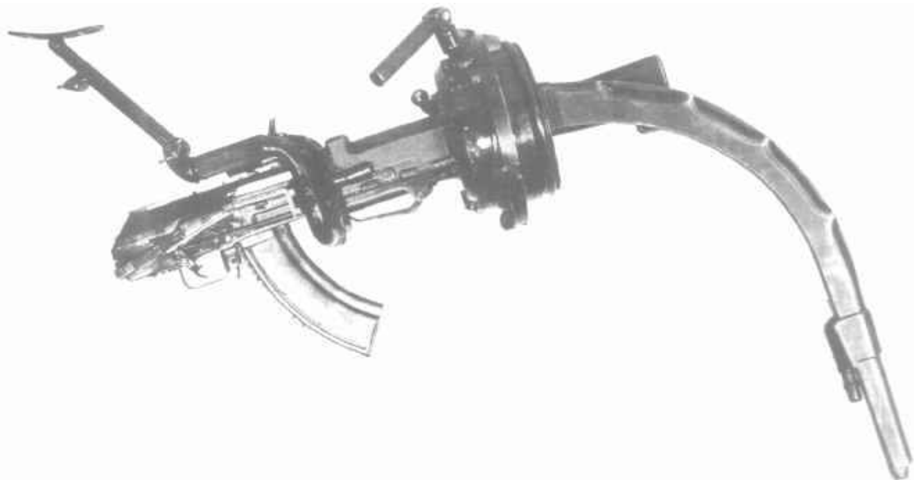
Кривоствольный (криволинейный) пулемет на базе 7,62-мм ручного пулемета системы Калашникова РПК
