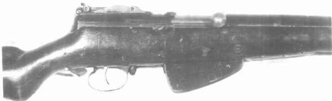
7,62-мм автоматическая винтовка системы Токарева, опытный образец 1925 г.
