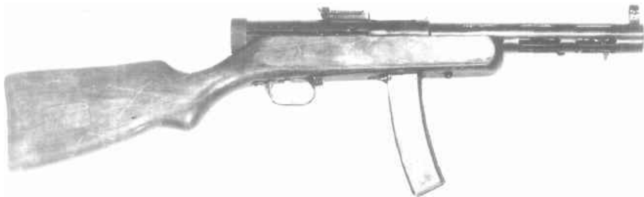
7,62-мм пистолет-пулемет системы Дегтярева образца 1934 г.
