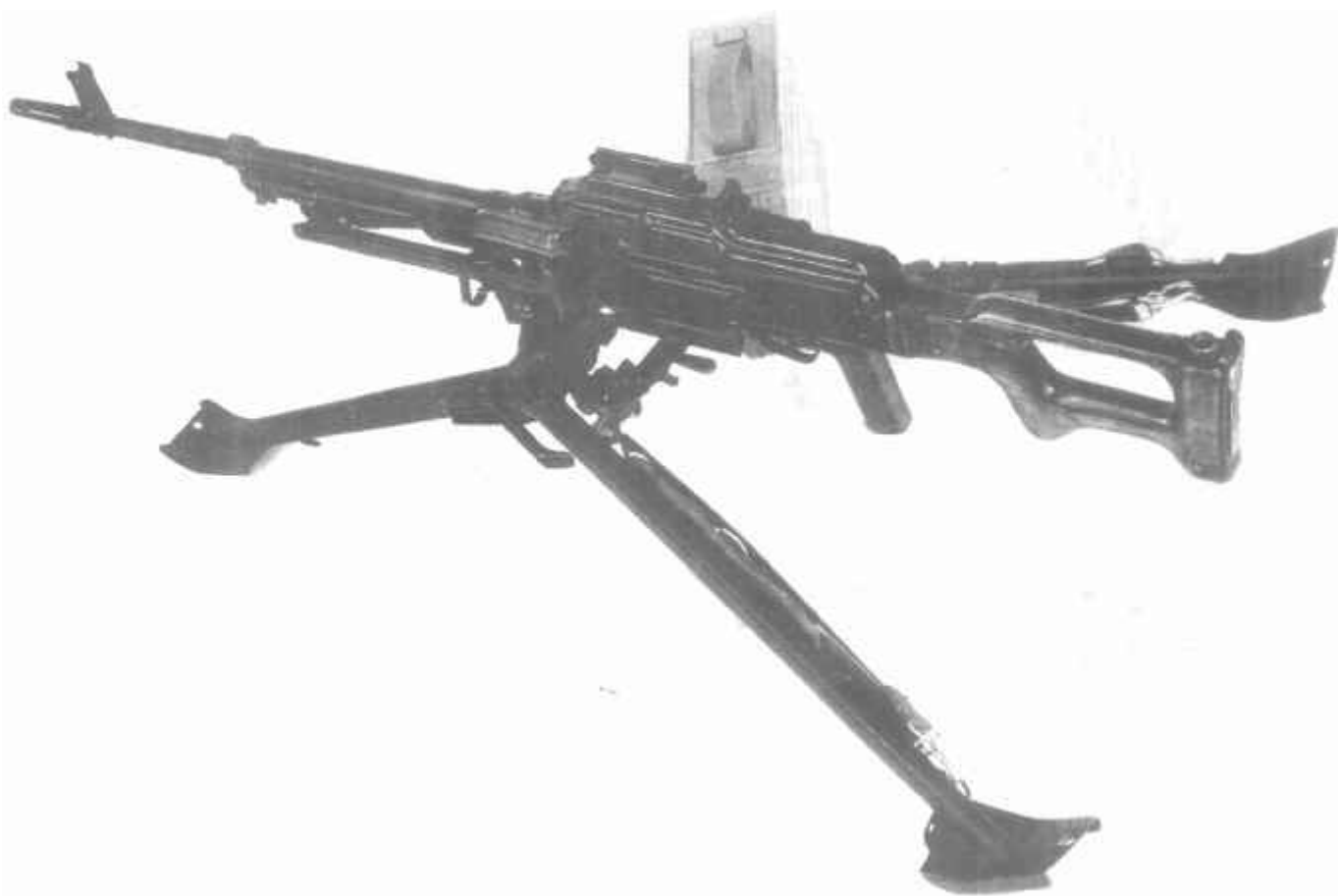
7,62-мм станковый пулемет системы Калашникова ПКСМ на станке Степанова
