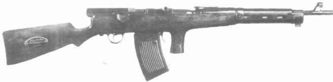
6,5-мм автомат системы Федорова образца 1916 г.
