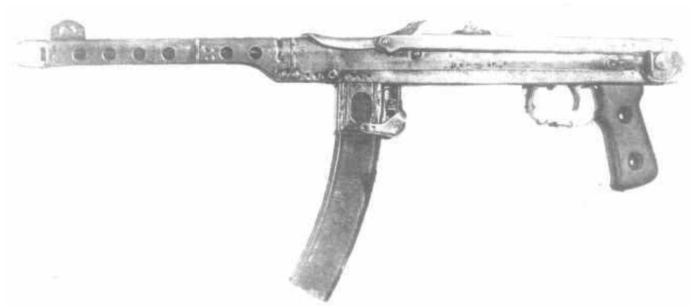
7,62-мм пистолет-пулемет системы Судаева образца 1942 г. ППС-42
