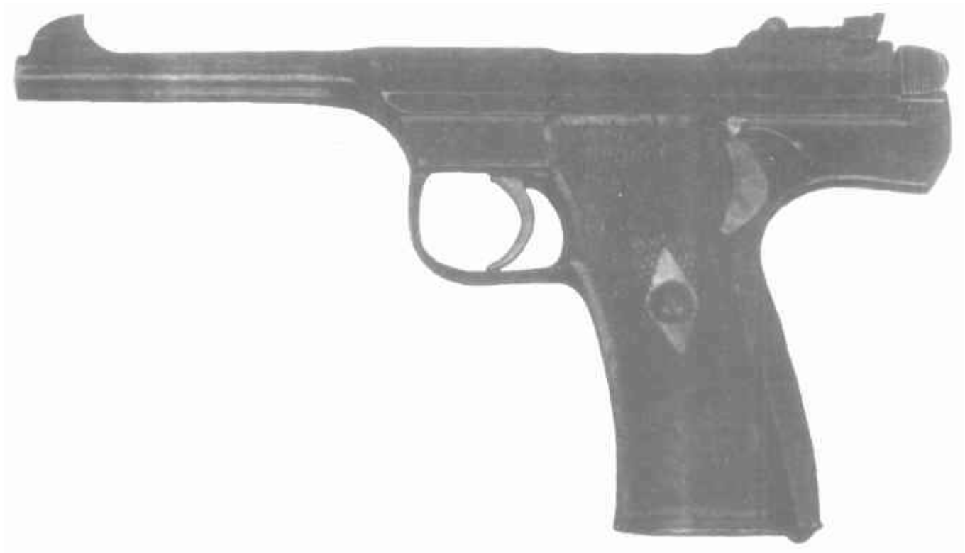
7,62-мм пистолет системы Ракова, опытный образец 1939 г.
