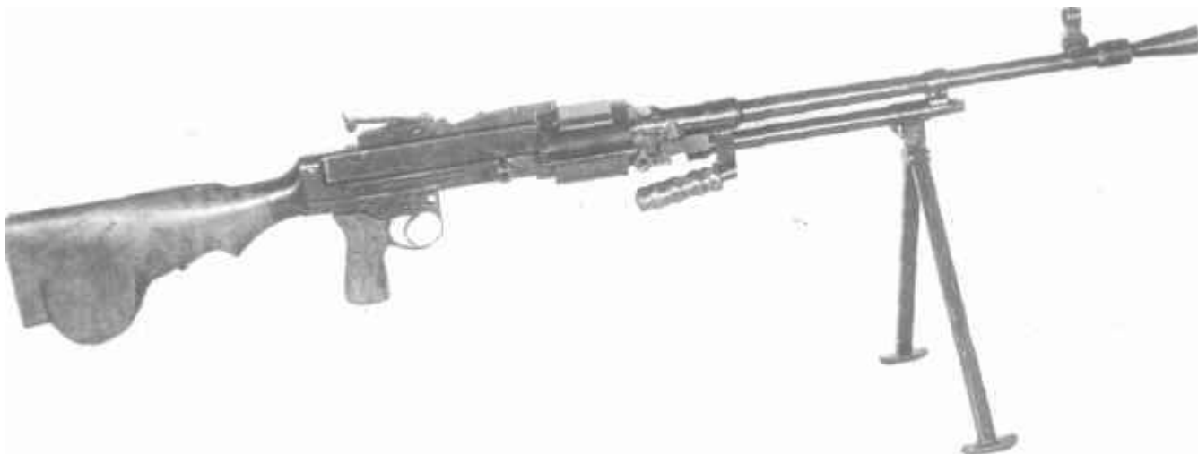
7,62-мм ручной пулемет системы Дегтярева, опытный образец 1942 г.
