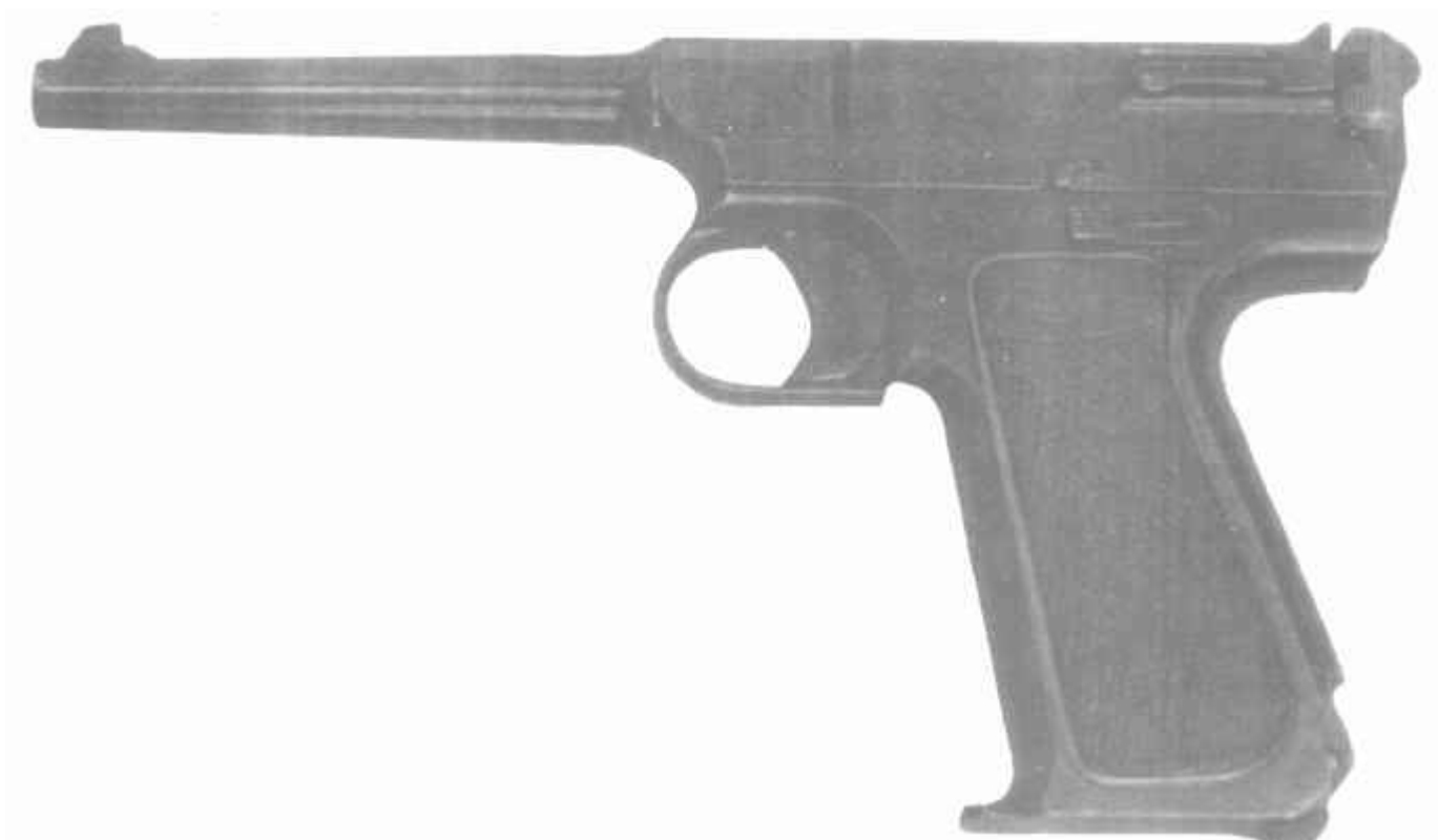
7,62-мм пистолет системы Воеводина, опытный образец 1939 г.
