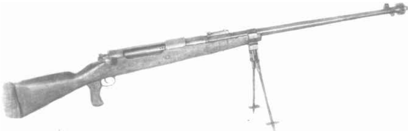
14,5-мм противотанковое ружье системы Рукавишникова, опытный образец 1939 г.
