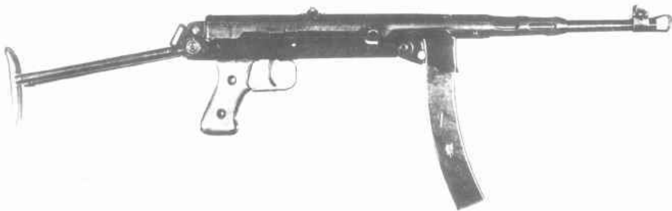
7,62-мм пистолет-пулемет системы Безручко-Высоцкого, опытный образец 1942 г.
