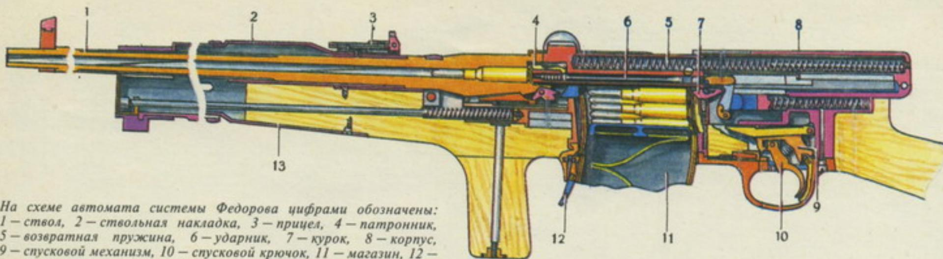
На схеме автомата системы Федорова цифрами обозначены: 1 — ствол, 2 — ствольная накладка, 3 — прицел, 4 — патронник, 5 — возвратная пружина, 6 — ударник, 7 — курок, 8 — корпус, 9 — спусковой механизм, 10 — спусковой крючок, 11 — магазин, 12 — защелка магазина, 13 — ложа.
