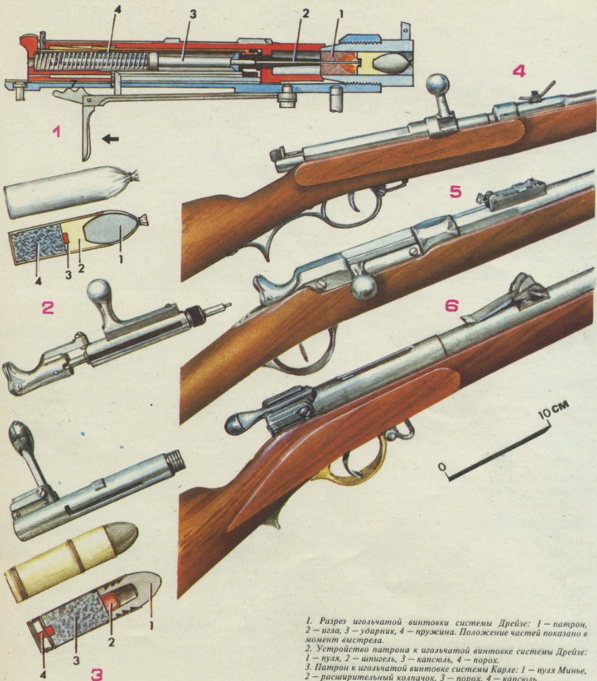
1. Разрез игольчатой винтовки системы Дрейзе: 1 — патрон, 2 — игла, 3 — ударник, 4 — пружина. Положение частей показано в момент выстрела.
