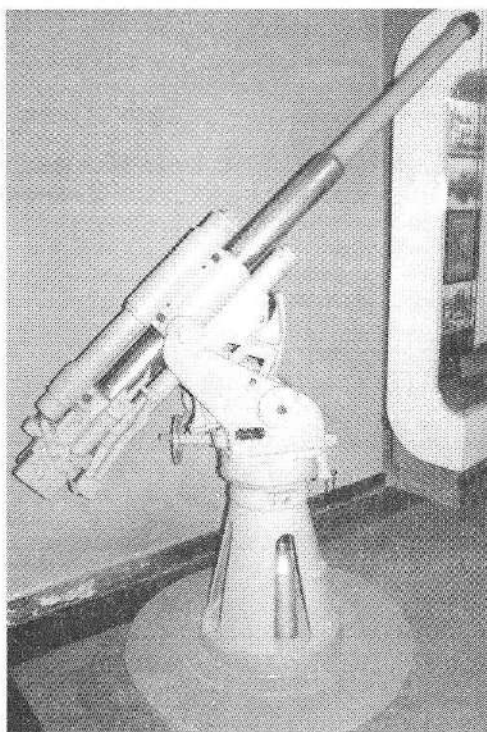
45-мм палубная артиллерийская установка 21-К
