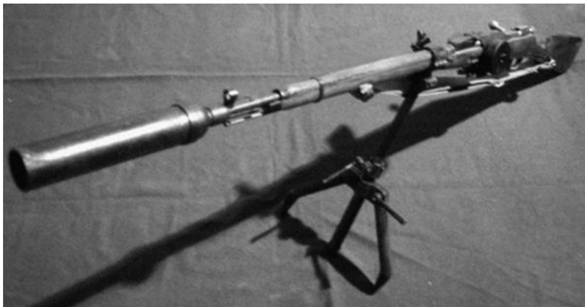
Гранатомет Дьяконова – трехлинейка Мосина с мортиркой на стволе
