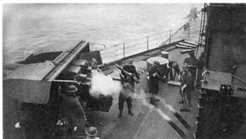
**102-мм зенитный калибр «Худа». Вверху орудия модели Mk.V в установках Mk.III, впоследствии замененные на спаренные установки Mk.XIX с орудиями Mk.XVI (справа)**
