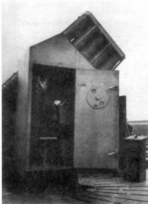
калибром 178 мм, которые могли выпускаться залпом или поодиночке. Когда реактивные снаряды достигали высоты около 300 м, срабатывал вышибной заряд, выбрасывающий небольшие мины весом 140 г, прикрепленные к трем парашютам тонкой стальной проволокой. Предполагалось, что самолеты, пролетающие через такую завесу, будут цеплять проволоку и притягивать
