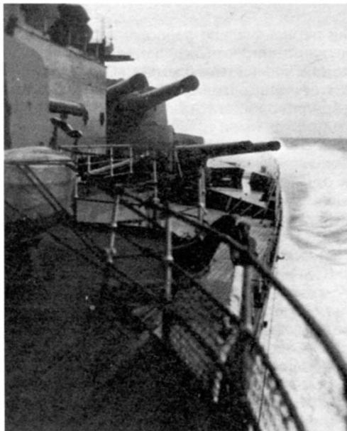
**«Худ» во время испытаний полным ходом после ремонта повреждений в 1936 г. Носовые башни развернуты в корму для снижения воздействия брызг на мостик**
