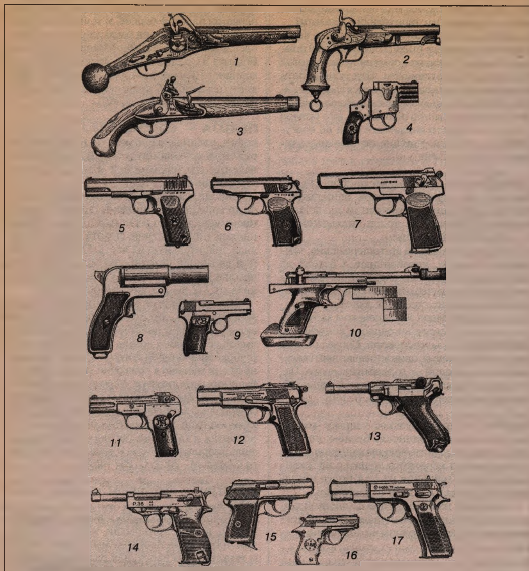
Пистолеты: 1 — европейский VII в. с колесцовым замком; 2 — русский нарезной 1854 г. с капсюльным замком; 3 — русский 1809 г. с ударно-кремневым замком; 4 — 6,35-мм германский четырехствольный; 5 — 7,62-мм Токарева — ТТ; 6 — 9-мм Макарова — ПМ; 7 — 9-мм автоматический Стечкина — АПС; 8 — сигнальный Шпагина; 9 — 6,35-мм Коровина — ТК; 10 — 5,6-мм спортивный целевой Марголина — МЦУ; 11 — 7,65-мм Браунинга 1900 г.; 12 — 9-мм Браунинга 1935 г.; 13 — 9-мм Люгера «Парабеллум»; 14 — 9-мм «Вальтер»; 15 — 9-мм П-46; 16 — 6,35-мм карманный «Лама»; 17 — 9-мм М-75
