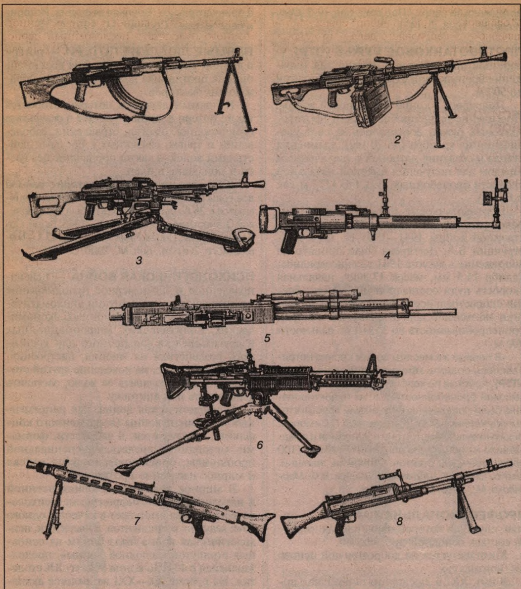
Пулемёты: 1 — 7,62-мм ручной РПК; 2, 3 — 7,62-мм единый ПК (на сошках) и ПКС (на станке); 4 — 7,62-мм авиационный скорострельный ШКАС; 5 — 12,7-мм авиационный УБ; 6 — 7,62-мм единый М60; 7 — 7,62 единый МГ-3; 8 — 7,62-мм единый L7A2
