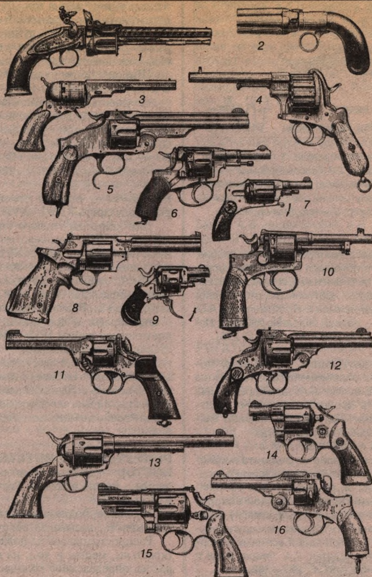
Револьверы: 1 — коллера с ударно-кремневым замком; 2 — капсюльный Мариэтта; 3 — капсюльный Кольта; 4 — шпилечный Лефоше; 5 — 10,67-мм Смита — Вессона; 6 — 7,62-мм (наган) укороченный; 7 — 6-мм «Стрелец»; 8 — 7,62-мм спортивный ТОЗ-66; 9 — от 5,6-мм до 12,7-мм гражданский «Булдого»; 10 — 8-мм Расти — Гассера; 11 — 9,65-мм «Энфилд»; 12 — 11,2-мм Смита — Вессона; 13 — от 7,65-мм до 11,43-мм Кольта; 14 — 9,65-мм или 5,6-мм ЗКР-590; 15 — 9,65-мм Смита — Вессона; 16 — 9-мм Хино-26
