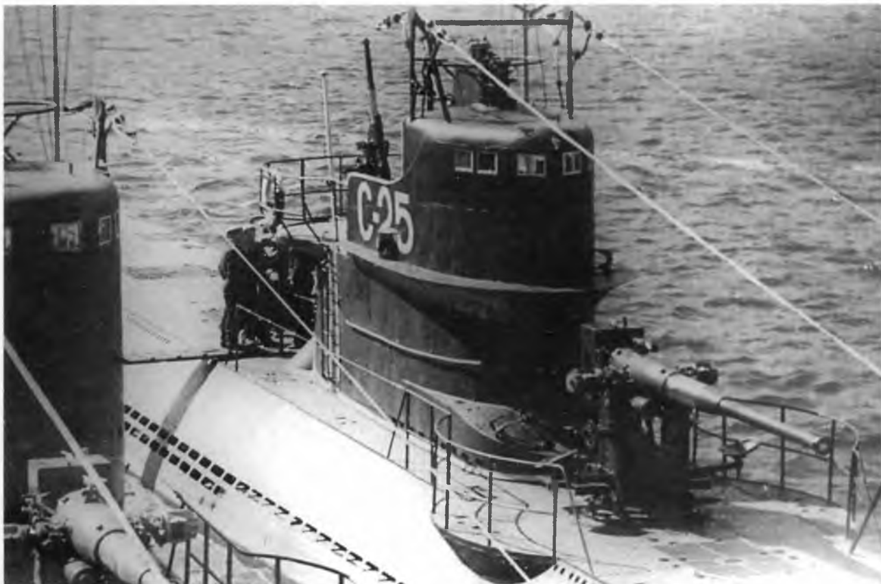
Подводная лодка С-25. Хорошо виден волноотбойник на рубке — он был установлен на «эсках» в ходе модернизации в послевоенные годы
