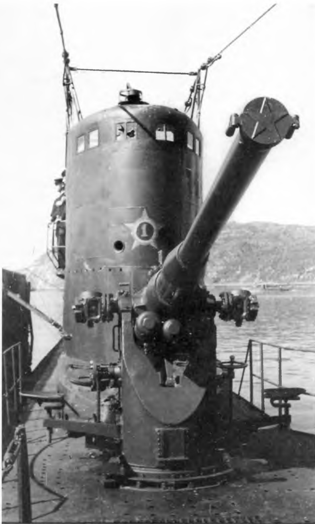
Артиллерийское вооружение подводной лодки Северного флота С-51 - 100-мм орудие Б-2ПЛ и 45-мм 21-К. На снимке справа рядом с «сорокапяткой» стоит командир лодки капитан 3 ранга И. Ф. Кучеренко, 1943 г. Фото С.Лейтмана
