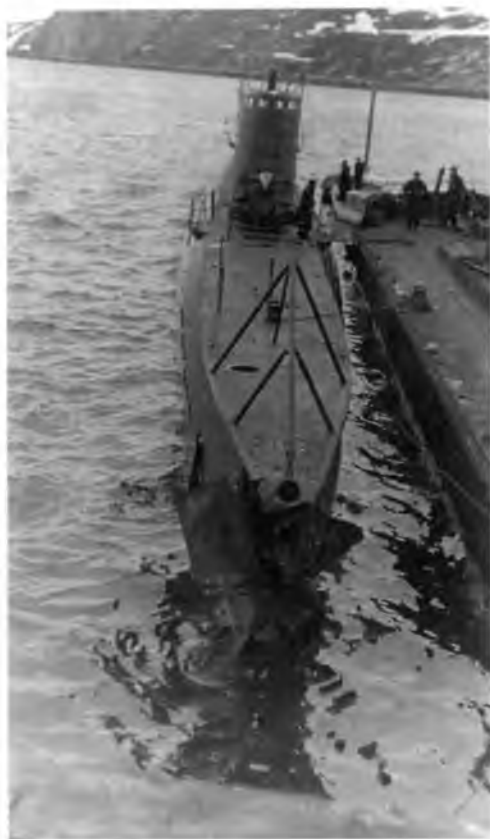
Подводная лодка С-55 после возвращения из боевого похода. Хорошо видны повреждения, полученные от взрывов глубинных бомб 29 апреля 1943 г.
