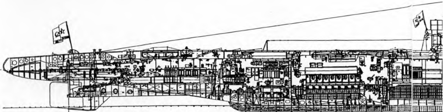
Продольный разрез подводной лодки XVI серии (проект 97). Копия подлинного чертежа
