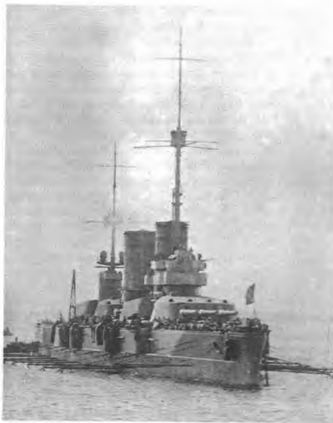
“Гангут” во время якорной стоянки на рейде. Для защиты от торпед на корабле опущены противоторпедные сети.
