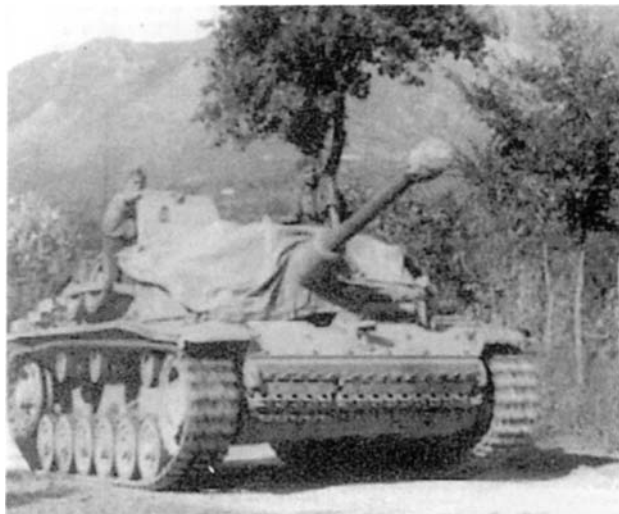
StuG III с длинноствольным орудием из состава дивизиона штурмовых орудий на Сицилии, 1943 г. Судя по «небоевому» виду орудия (брезент укрывает перископические прицелы, наружный пулемет снят), можно заключить, что снимок сделан еще до высадки англо-американских войск. (Роберт Носс)
