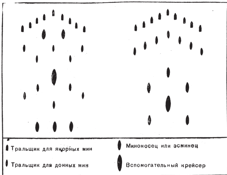
Охранение вспомогательного крейсера при проходе в 1942 г. через Ла-Манш по маршруту, на котором приходилось считаться с наличием только якорных мин (слева) и якорных и донных мин (справа)
