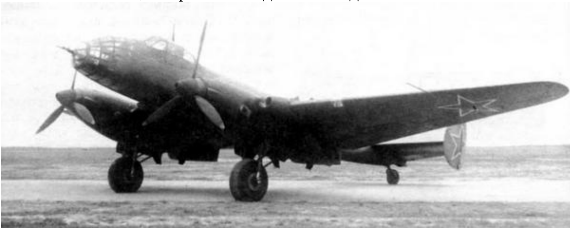
Опытный образец Ер-2 с дизелями М-30Б на испытаниях в НИИ ВВС, февраль 1943 г.
