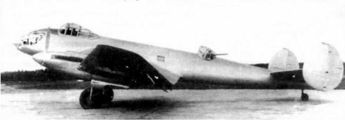
ДБ-240 с турелью ТАТ-БТ в боевом положении.
