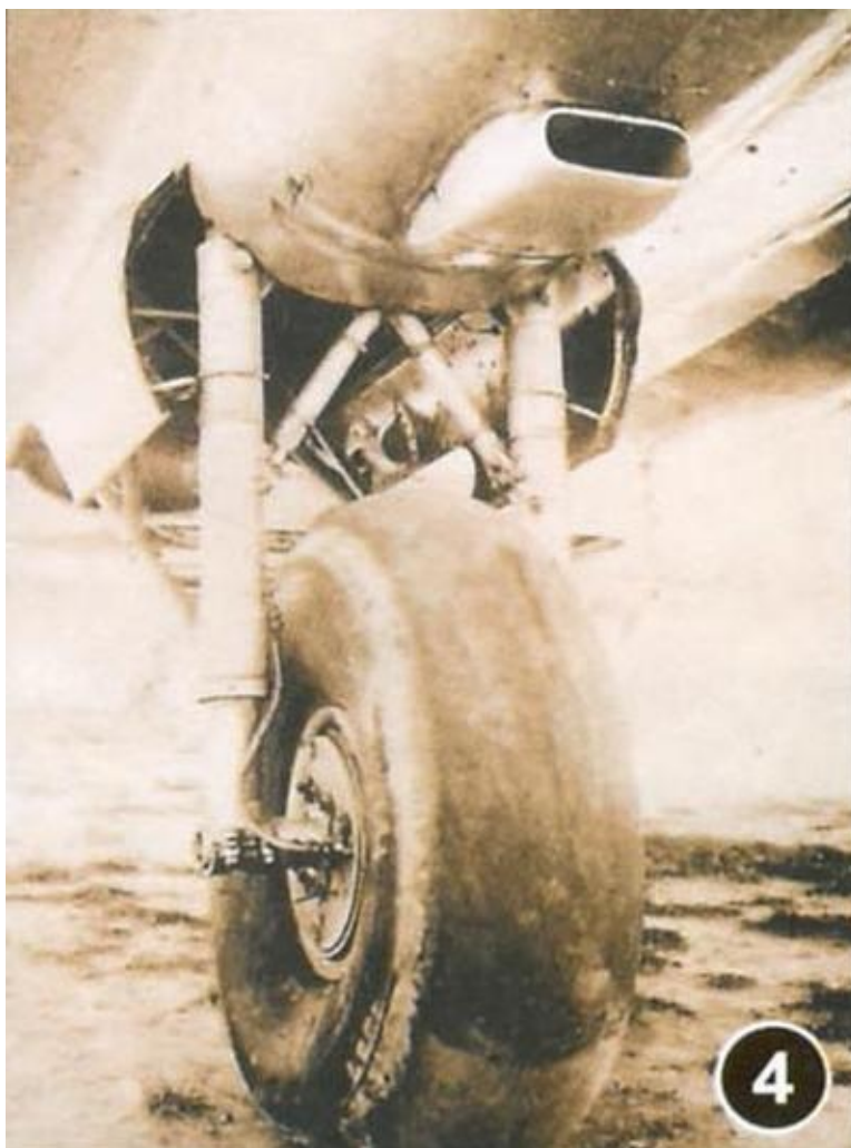
4. Основная опора шасси.
