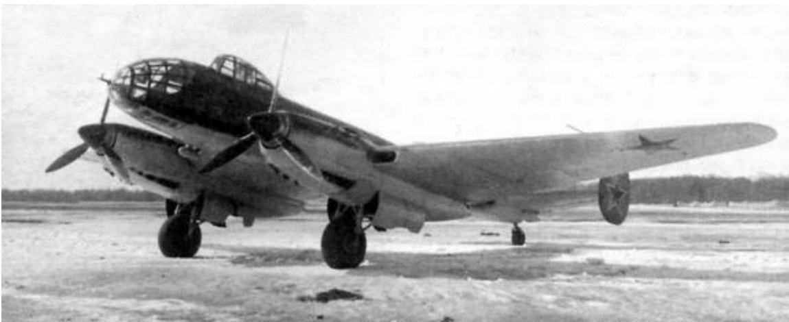
Ер-2 с Х-образными моторами МБ-100, сентябрь 1943 г.
