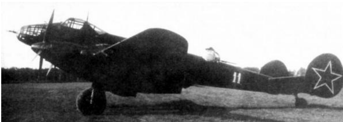
Ер-2 с дизелями АЧ-30Б на войсковых испытаниях, лето 1945 г. Нижние поверхности машины — черные.
