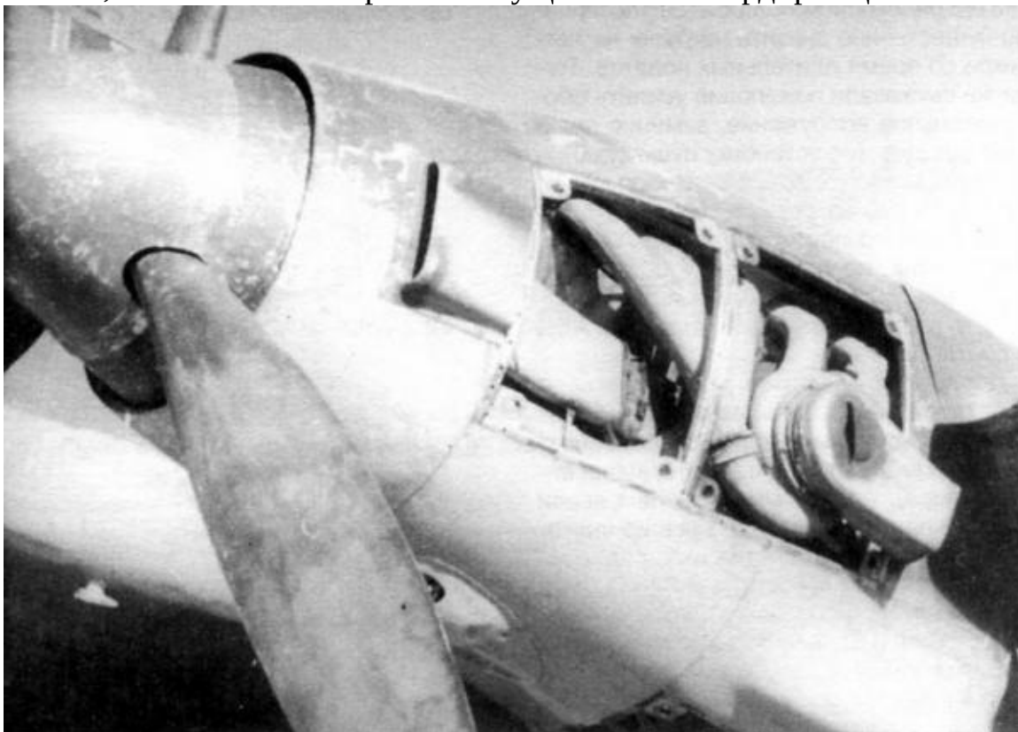
Частично раскопотированный дизель АЧ-30Б.
