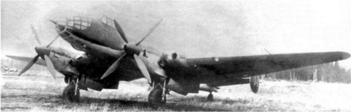
Ер-2 с дизелями М-30Б и четырехлопастными винтами АВ-9ЕЛ-116.
