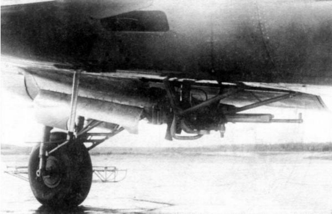
Люковая установка с пулеметом ШКАС в боевом положении.
