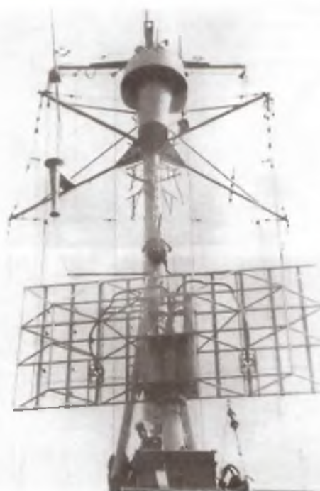
Фок-мачта и антенна радиолокационной станции FuMO-21 миноносца T-35
