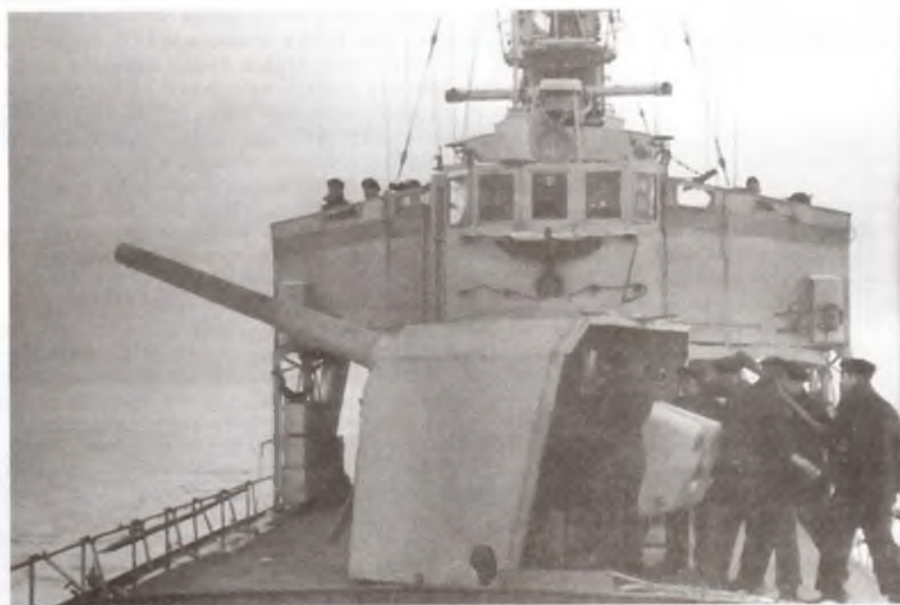
105-мм орудие SKC/28 на баке миноносца типа 24
