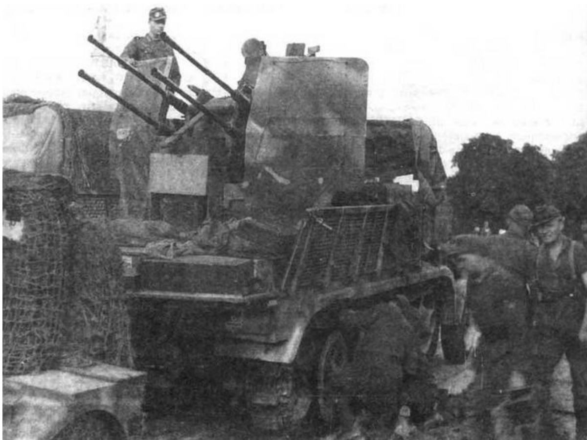
Самоходная установка с 20-мм счетверенной автоматической зенитной пушкой Sd.Kfz.7/1. Нормандия, июнь 1944 года
