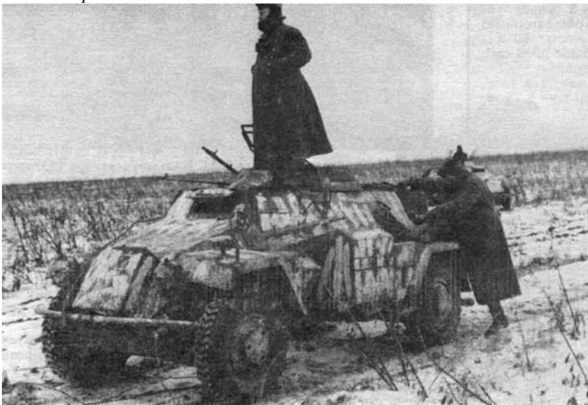
Бронеавтомобиль Sd.Kfz.221. вооруженный пулеметом MG 34 и противотанковым ружьем Panzerbüsche 39. Восточный фронт. 1942 год
