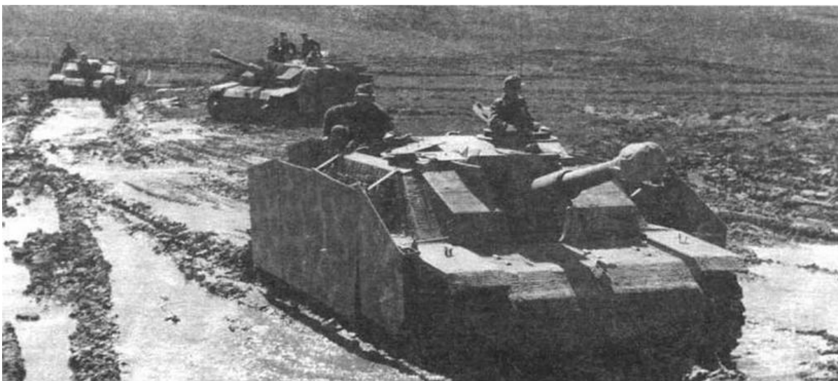
Штурмовая гаубица Stull 42. С марта 1943 года эти САУ состояли на вооружении батарей совместно со штурмовыми орудиями
