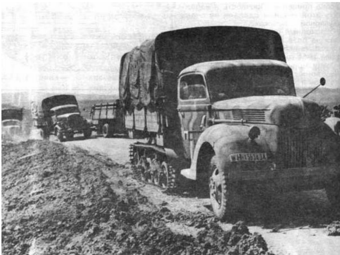
Полугусеничный грузовой автомобиль Sd.Kfz.3b Maultier. Эта машина создана путем установки гусеничного движителя "Карден-Ллойд" вместо заднего моста коммерческого грузовика Ford
