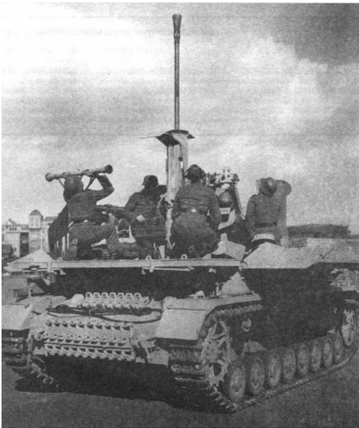
Möbelwagen в боевом положении — все бронециты боевой платформы откинуты
