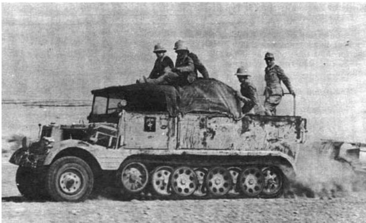
Артиллерийский 3-тонный полугусеничный тягач Sd.Kfz.11 в частях Африканского корпуса использовался главным образом для буксировки легких 105-мм полевых гаубиц leFH 18. Северная Африка, 1942 год
