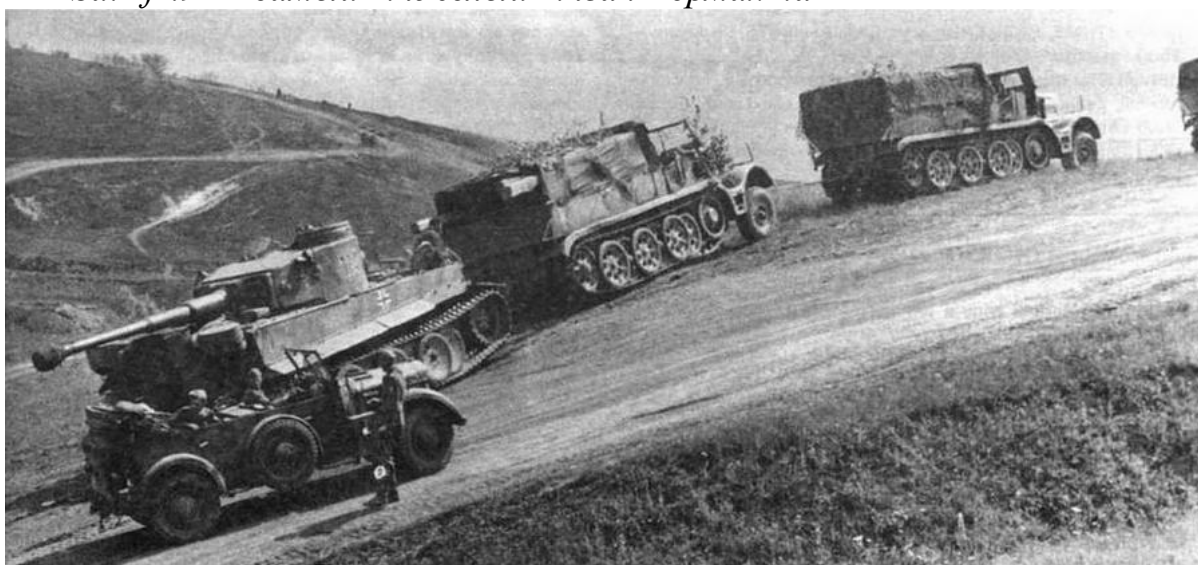
Для буксировки танка Tiger приходилось "запрягать" два 18-тонных тягача Sd.Kfz. 9
