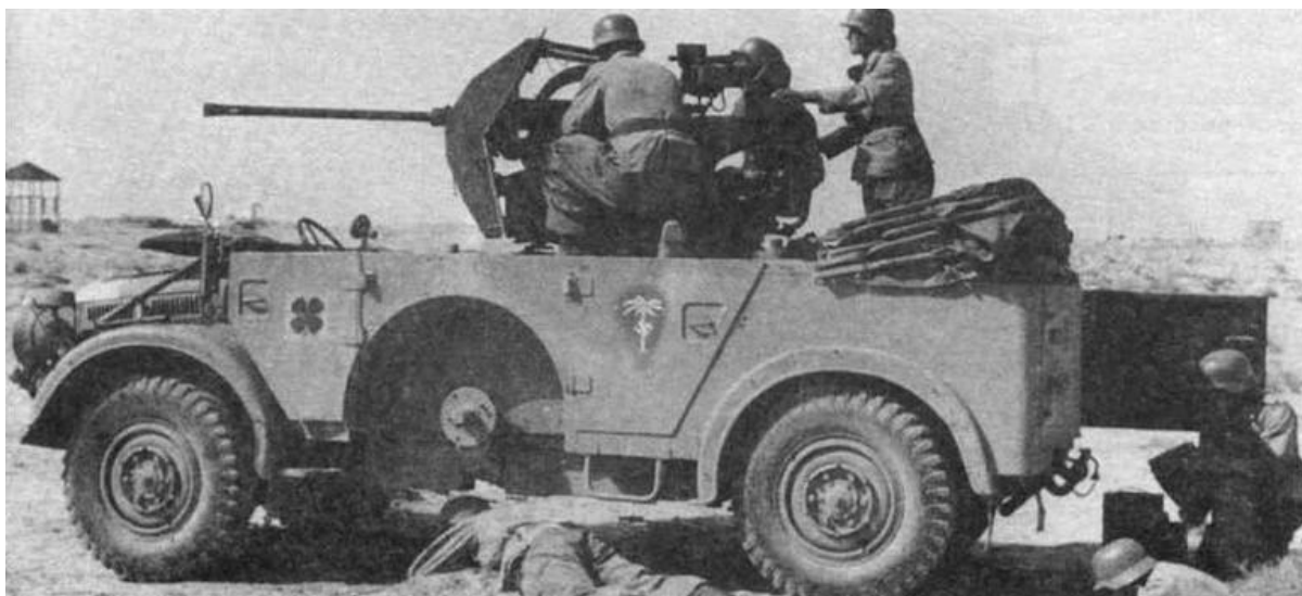
Армейский автомобиль Horch с 20-мм автоматической зенитной пушкой, которая часто использовалась и для стрельбы по наземным целям. Северная Африка, 1941 год
