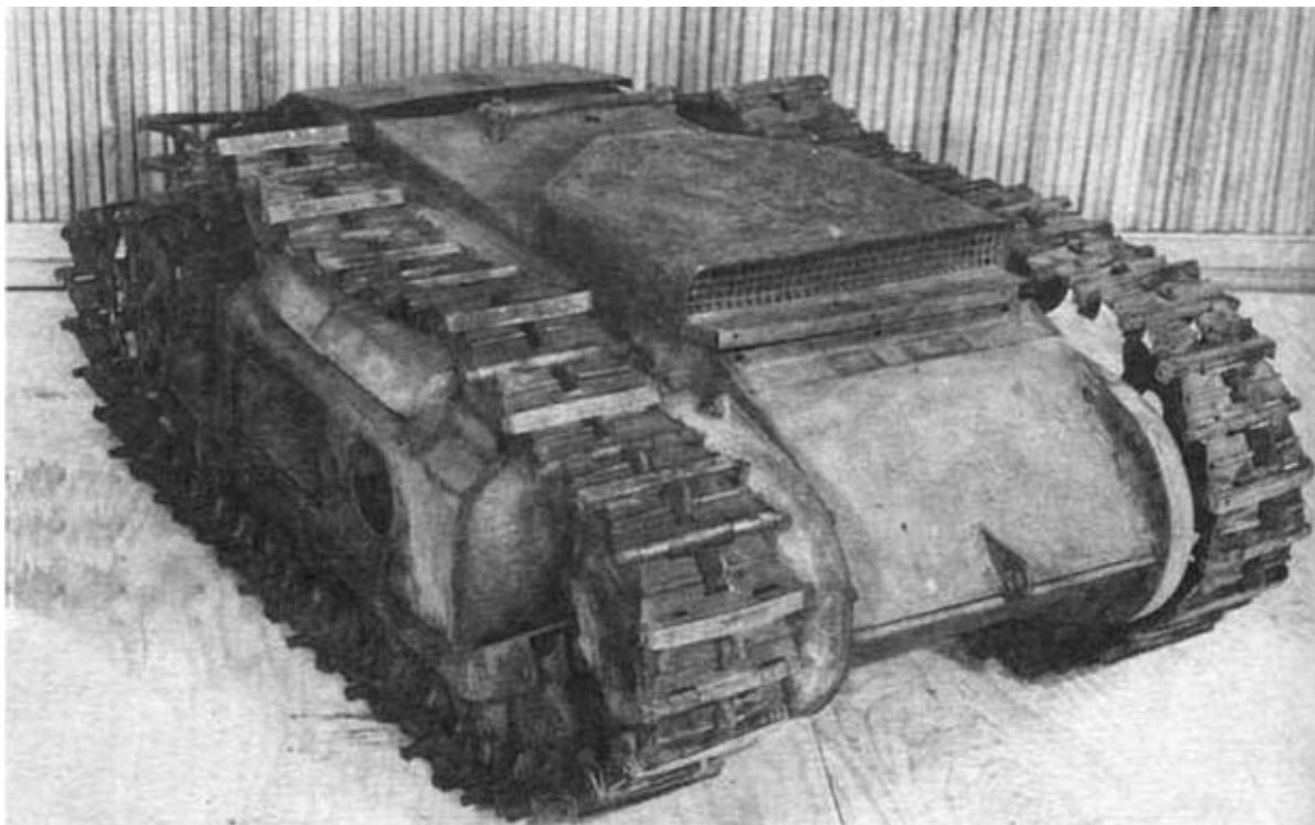
Телетанкетка Sd.Kfz.-303 с двигателем внутреннего сгорания
