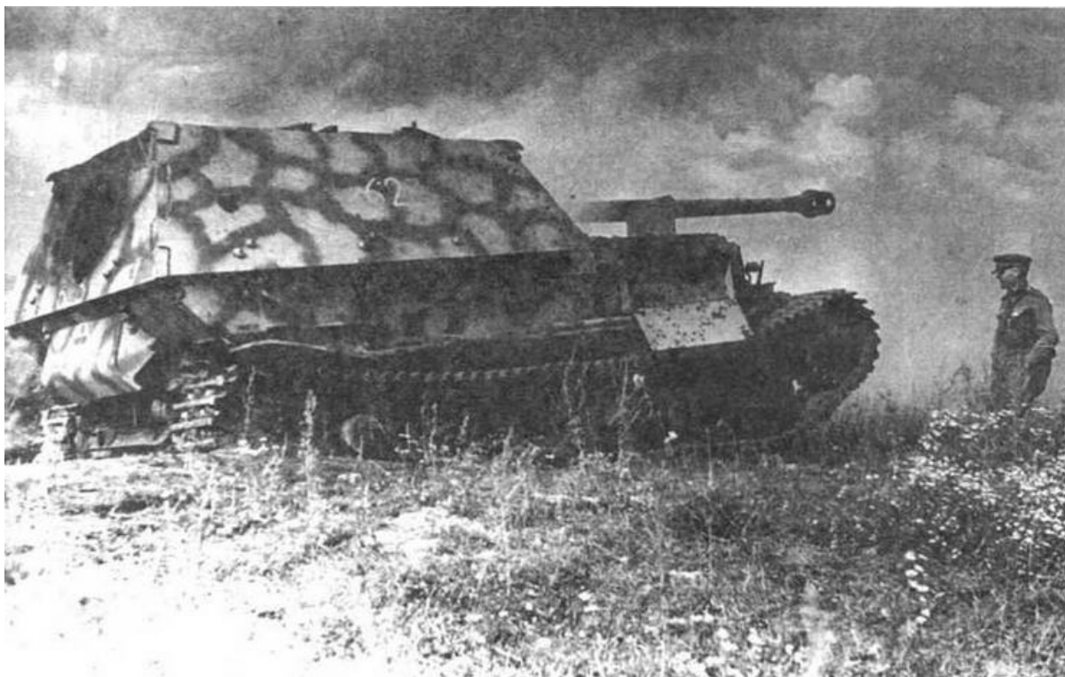
Подбитый Ferdinand из роты 654-го дивизиона. Люк для демонтажа пушки, по-видимому, сорван внутренним взрывом. Центральный фронт июль 1943 года
