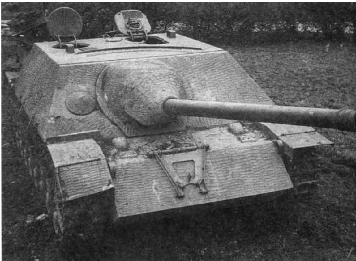
Истребитель танков Panzer IV/70 производства фирмы Vomag
