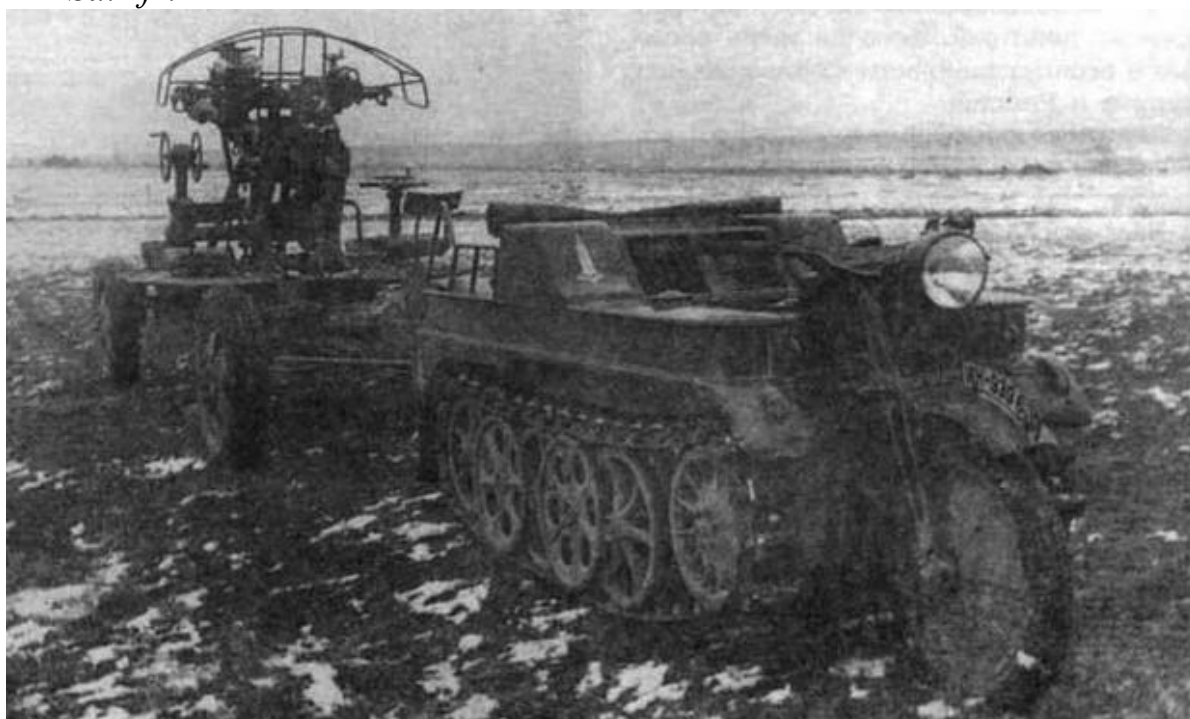
Полугусеничный мотоцикл с зенитной пушкой на буксире
