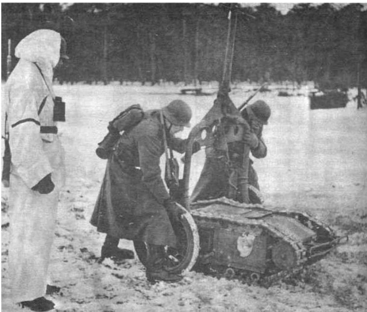
Разгрузка гелетанкетки Goliath Sd.Kfz.T02 с транспортной тележки
