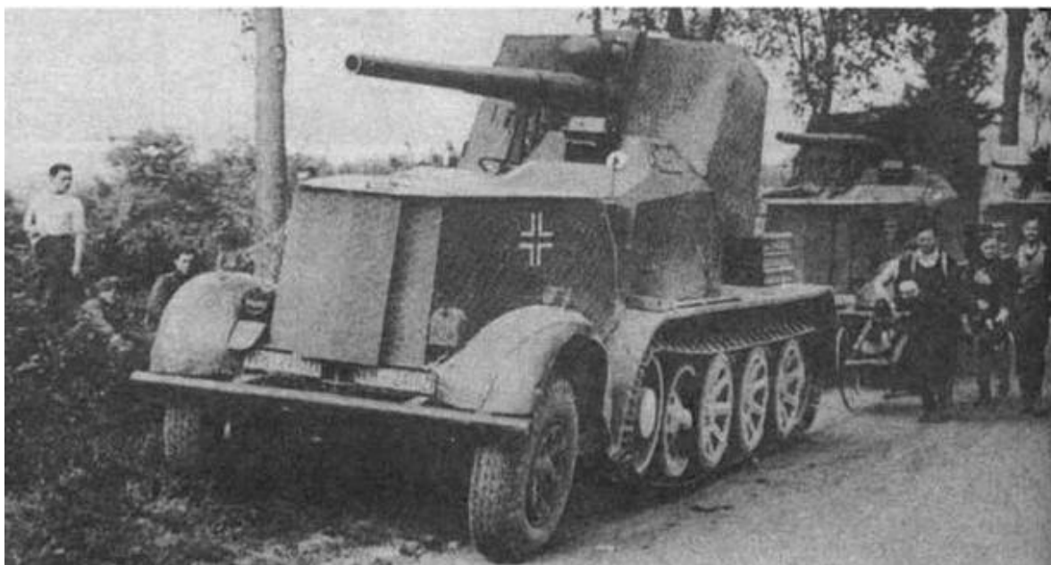
88-мм зенитная пушка на бронированном шасси тягача Sd.Kfz.8
