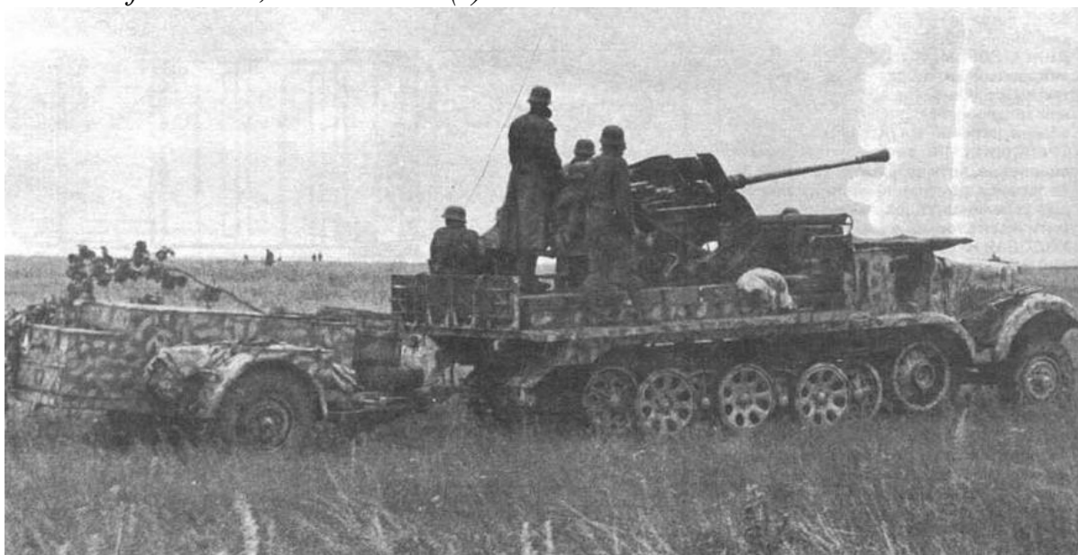
Самоходная установка Sd.Kfz.6/2. В прицепе перевозились боеприпасы. Восточный фронт, лето 1943 года
