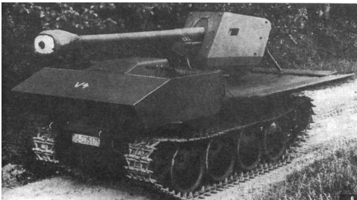
75-мм пушка Pak 40 на шасси тягача Ost — наиболее миниатюрная противотанковая САУ германской армии периода Второй мировой войны
