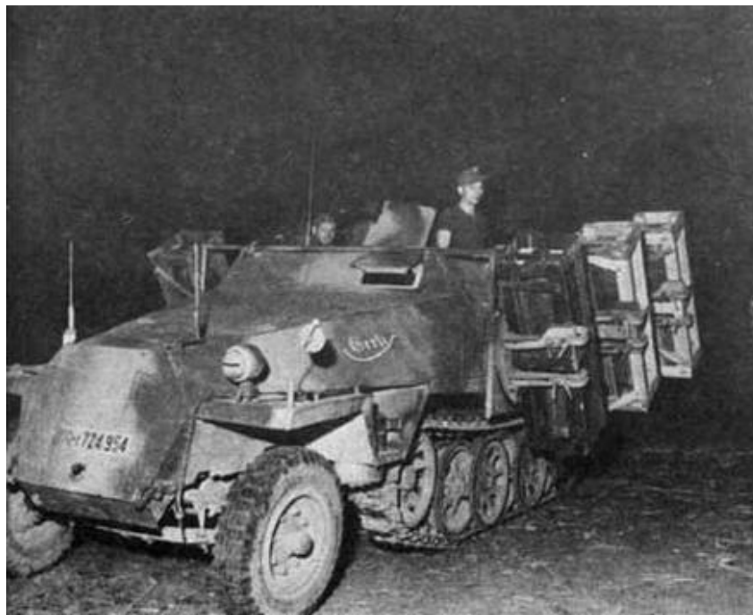
Бронетранспортер Sd.Kfz.251 Ausf.D, оборудованный контейнерами для запуска реактивных снарядов калибра 280 мм
