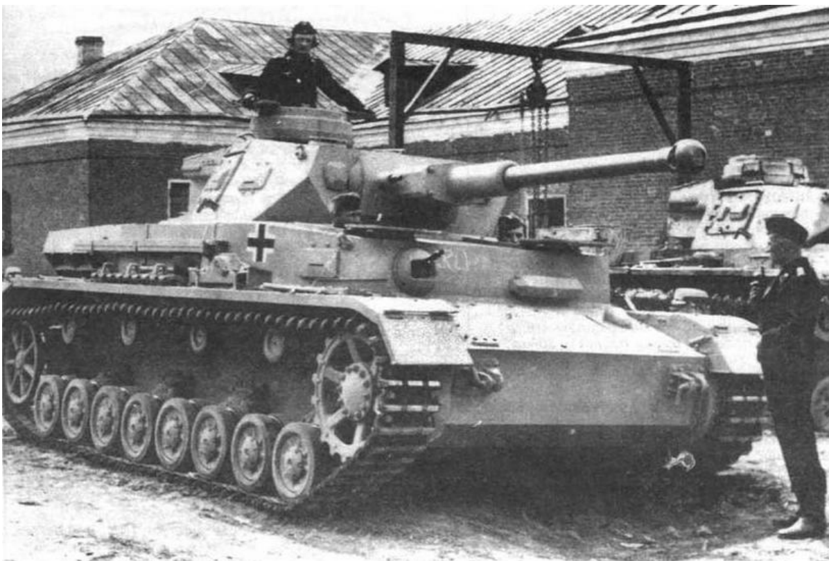
Средний танк Pz.IV Ausf.F1 Судя по наличию смотровых приборов заряжающего на лобовом и правом бортовом листах башни, эта машина переоборудована из танка модификации F1
