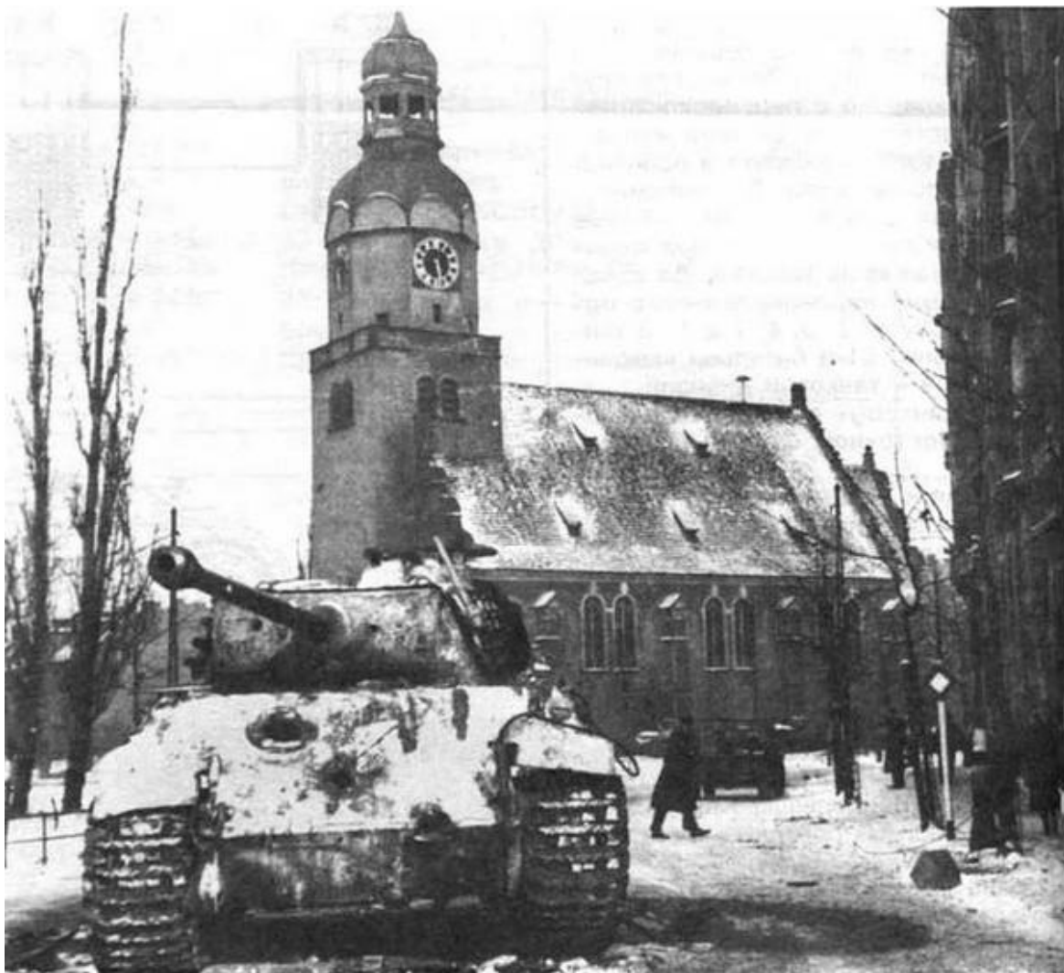
Тяжелый танк Panther Ausf.G. подбитый на улицах Познани в январе 1945 года. В лобовой броне корпуса хорошо видны сквозные пробоины
