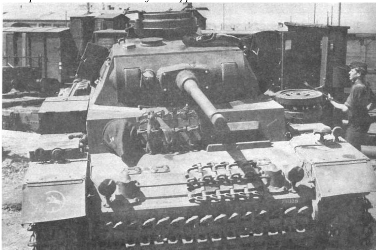
Средний танк Pz.III Ausf.J, вооруженный 50-мм пушкой с длиной ствола в 60 калибров, во время разгрузки с железнодорожной платформы. Восточный фронт. 1942 год. На правом крыле машины — тактический значок 24-й танковой дивизии (24.Panzer- Division)
