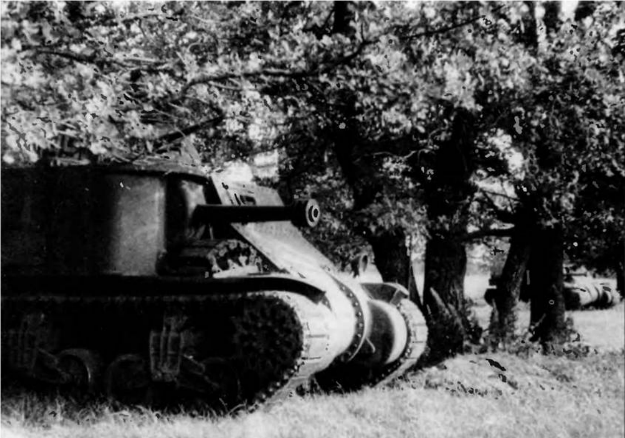
Средний танк М3с на исходной позиции. Орловское направление, 1943 год. Массивный противовес у дульного среза ствола 75-мм пушки М2 свидетельствует о том, что это орудие оснащено стабилизатором наведения в вертикальной плоскости
