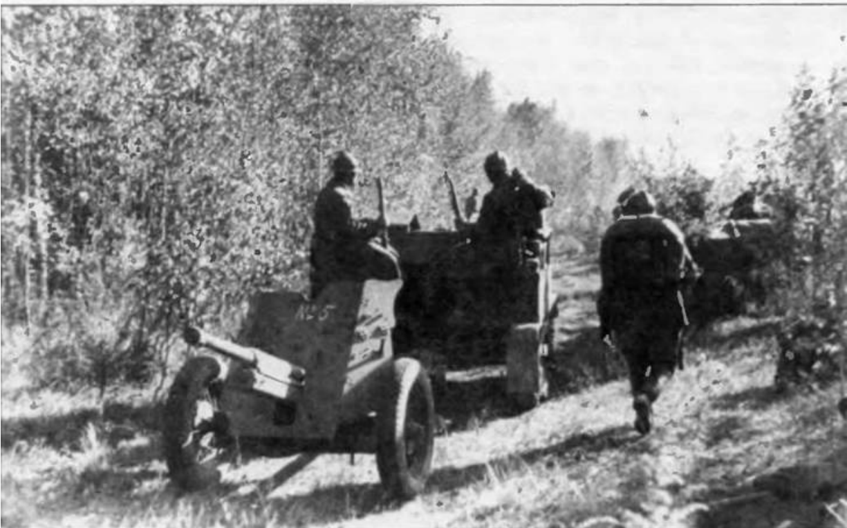
Танкетка Т-27, переоборудованная в артиллерийский тягач (справа). Танкетки Т-27 буксируют 45-мм противотанковые пушки (в центре)
