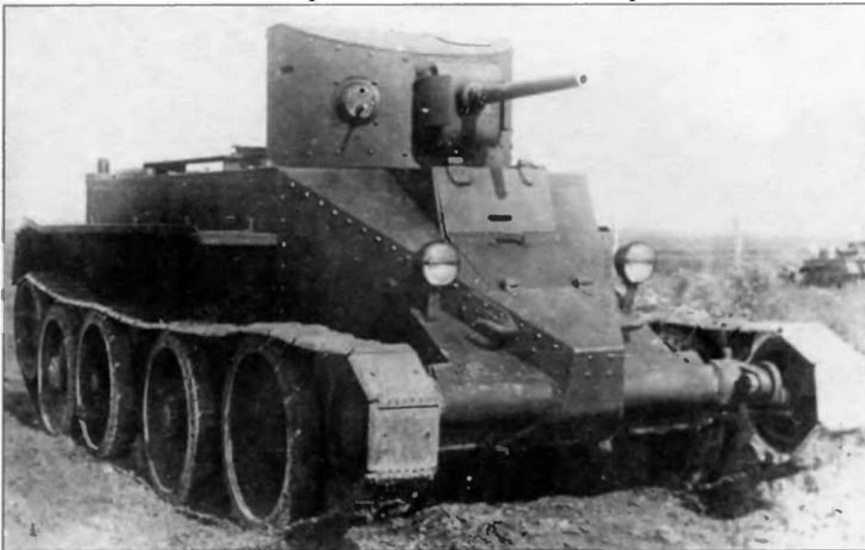
Легкий колесно-гусеничный танк БТ с пушечно-пулеметным вооружением
