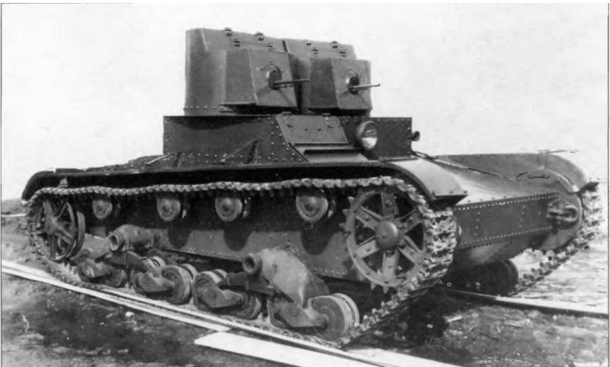
Легкий танк Т-26 обр. 1931 г. с пулеметным вооружением
