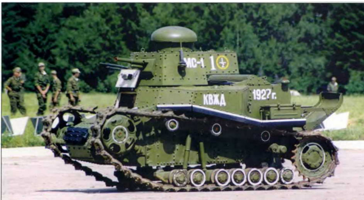
Восстановленный легкий танк МС-1. Кубинка, 2001 год. К сожалению ходовая часть этой машины не соответствует серийным
