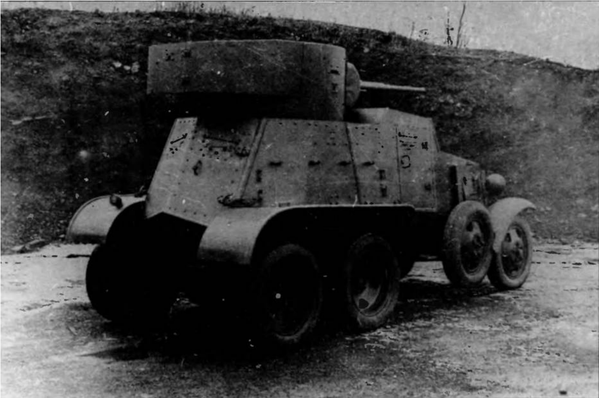
Средний броневомобиль БА-3. Хорошо видна дверь в корме бронекорпуса
