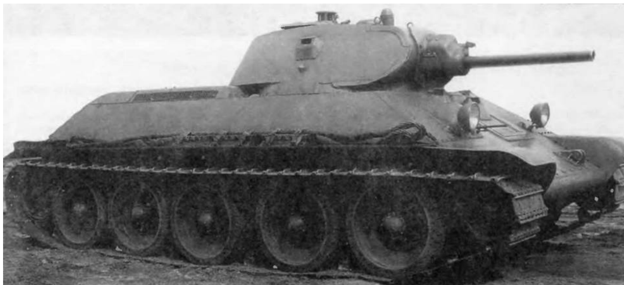
Серийный танк Т-34 обр. 1940 г. с 76-мм пушкой Л-11
