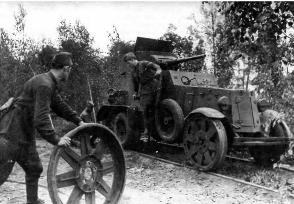
Экипаж БА-6 жд младшего сержанта П.М.Андреева надевает железнодорожные бандажки на автомобильные скаты. 1942 год
