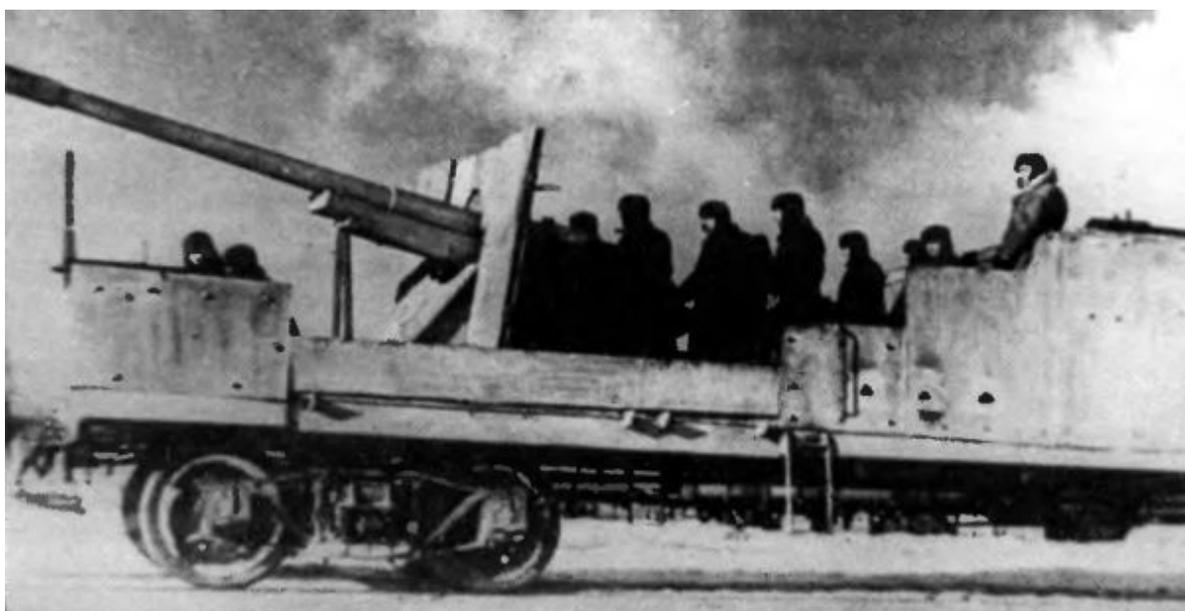
*Бронеплощадка с орудием калибра 107-мм*
