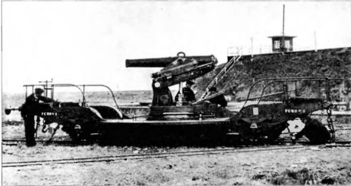
*Железнодорожная установка системы Канэ-Пенье для 155-мм гаубицы*
