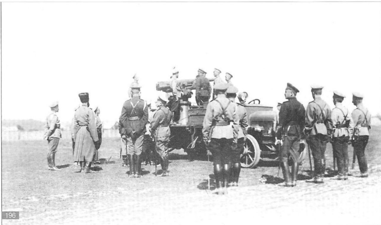
Император Николай II осматривает 76 мм зенитную батарею на шасси небронированных 5-тонных грузовиков «Уайт», 1916 г. (РГАКФД).
