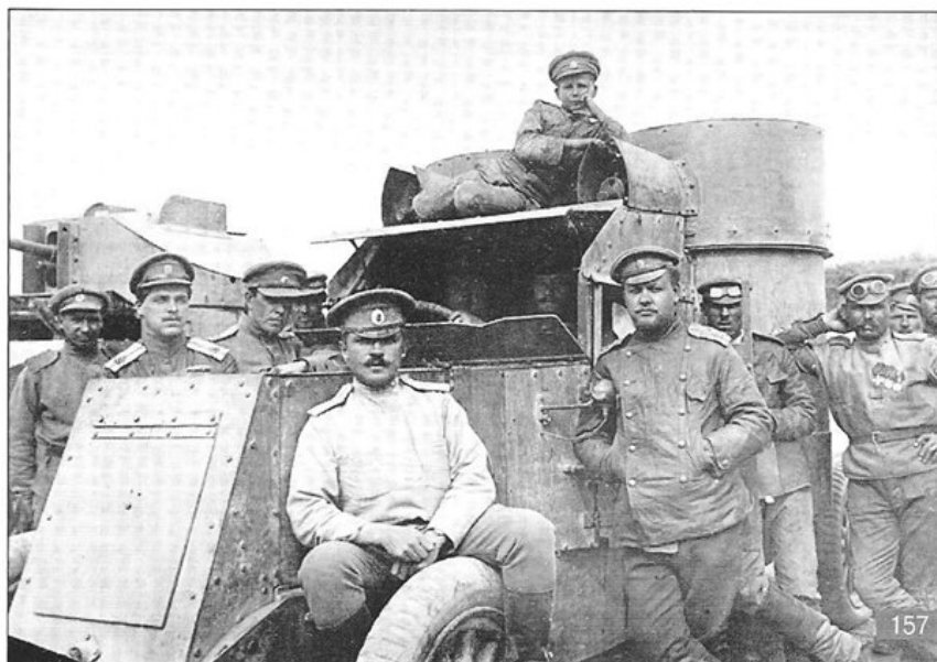
157 Неизвестный пулеметный автомобильный взвод: броневый автомобиль «Остин» 2-й серии и броневый автомобиль «Ланчестер» с 37-мм пушкой Гочкиса. На крыше «Остина» — мальчик-сын полка (РГАСФД).
