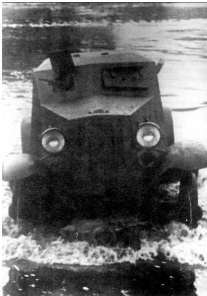
*Бронеавтомобиль Д-8 преодолевает вброд водную преграду*
