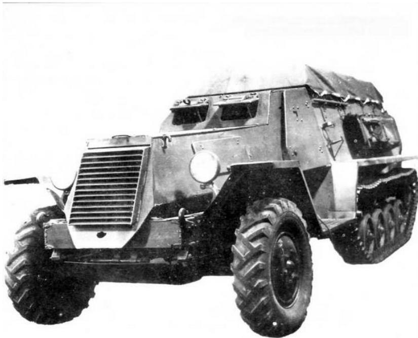
*Макетный образец полугусеничного бронетранспортера Б-3. 1944 год.*
