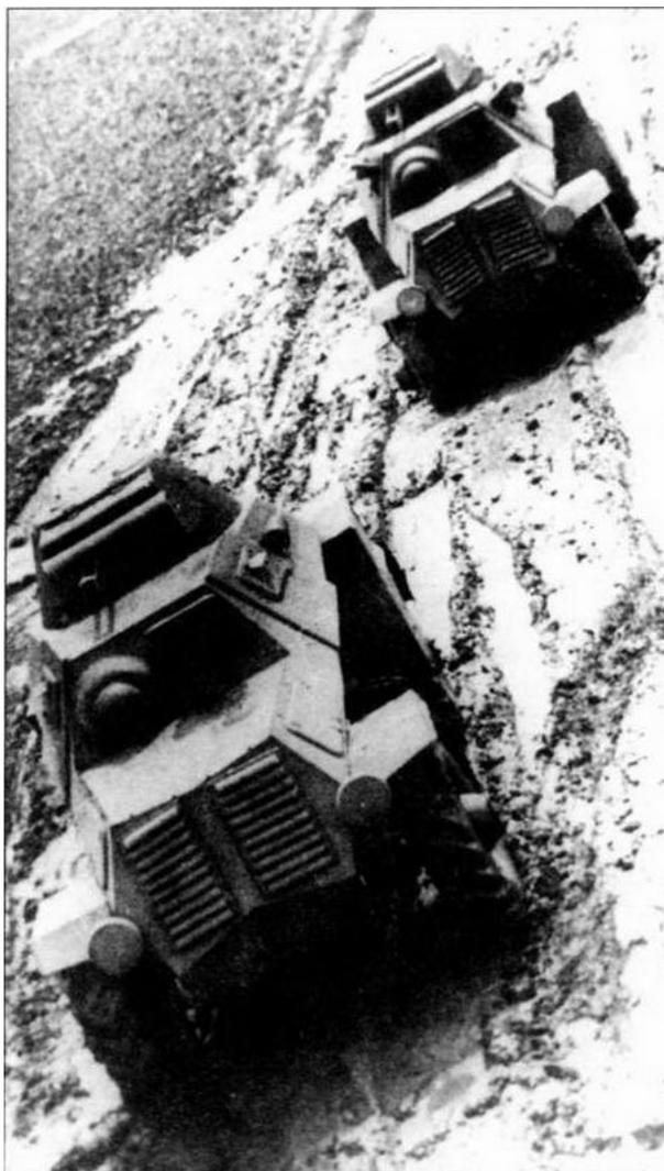
*Бронеавтомобили ЛБ-62 во время заводских испытаний. Задняя машина оснащена двухкатными задними колесами. У передней — все колеса однокатные с протектором типа "косая елка". 1940 год*
