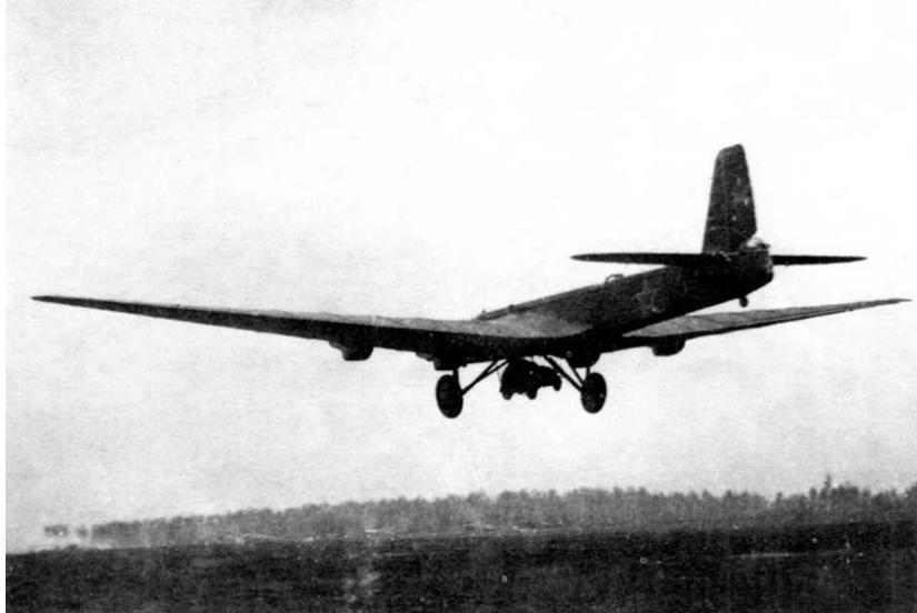
*Бронеавтомобиль БА-64Б проходил испытания в качестве штатной боевой техники воздушно-десантных войск. В 1943 году была осуществлена подвеска этой машины под бомбардировщиком ТБ-3*
