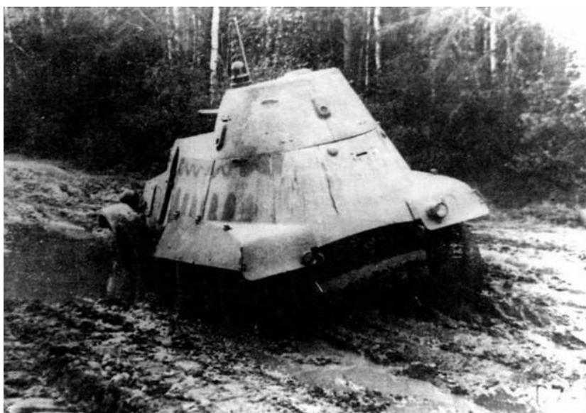
*БА-11 во время испытаний. Отсутствие привода на все колеса сильно ограничивало проходимость машины*
