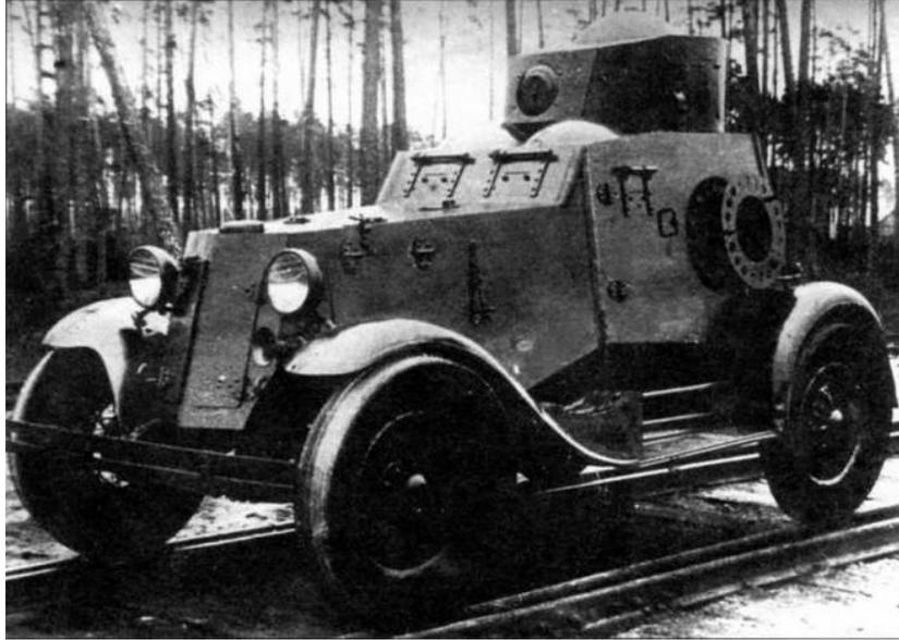
*Бронеавтомобиль ФАИ жд. Для движения по рельсам поверх штатных покрышек надевались железнодорожные скаты*
