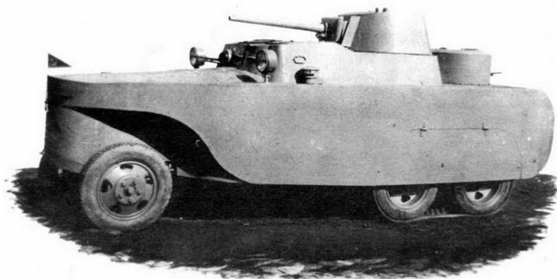
*Броньавтомобиль- дрезина БАД-2 на железнодорожном (вверху) и обычном ходу. Поверх пневматических шин задних ведущих мостов надеты всеподходные гусеничные ленты "Оверолл"*
