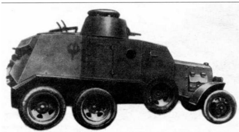
*Бронеавтомобиль Д-13. За башней видна турель для установки зенитного пулемета "максим"*
