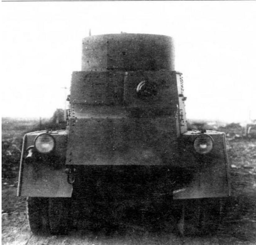
*Бронеавтомобиль БА-5. Вид сзади. Слева от пулеметной установки хорошо виден смотровой лючок кормового поста управления*
