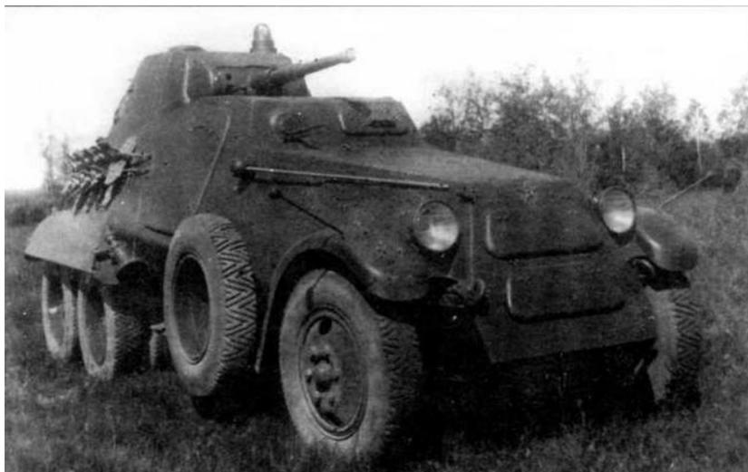
*Тяжелый броневедомитель БА-11 во время испытаний на НИИТТПолигоне. 1940 год. Штыревая антенна уложена вдоль капота машины в положение по-походному*
