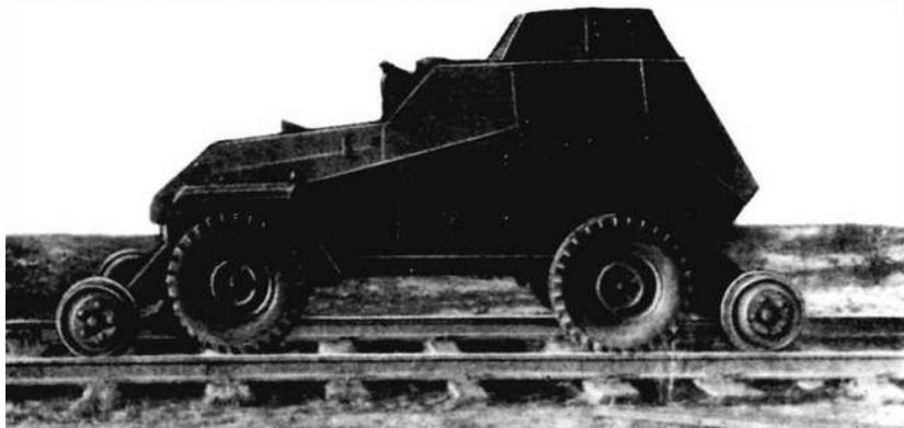
*Железнодорожный вариант БА-64Г, разработанный на ГАЗе. Осень 1942 года*
