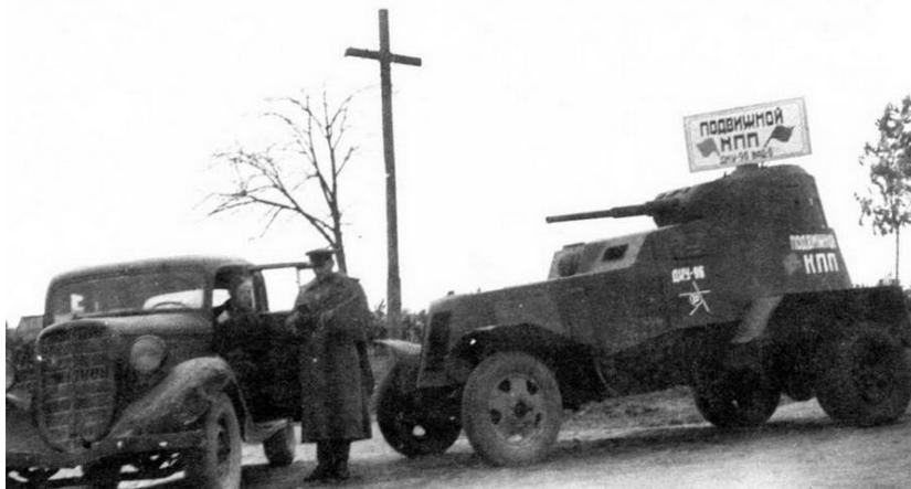
*Броневик БА-10, используемый в качестве подвижного контрольно-пропускного пункта. 1-й Белорусский фронт, 1944 год. Любопытная деталь — у машины отсутствует один ведущий мост*
