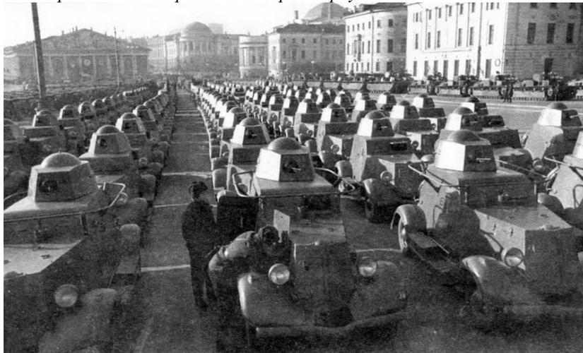
*Бронеавтомобили БА-20 в парадном строю на Манежной площади. Москва, 1 мая 1940 года. В первой шеренге — командирские машины, оснащенные радиостанциями 71-ТК-1 с поручневыми антеннами*
