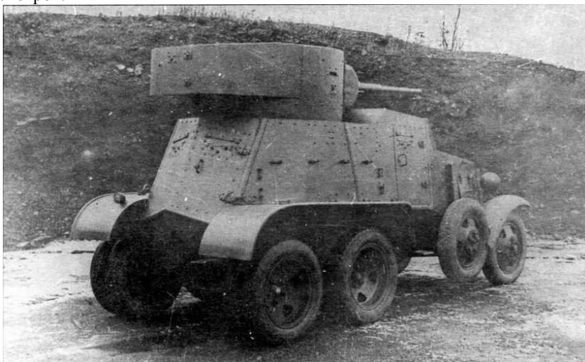
*Броневедомка БА-3 во время заводских испытаний. Хорошо видна дверь в корме бронекорпуса*
