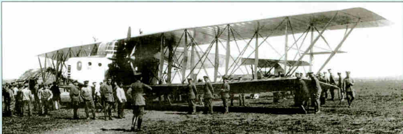
Гиганты «Сименс-Шуккерт» имели многостоечные бипланные коробки
