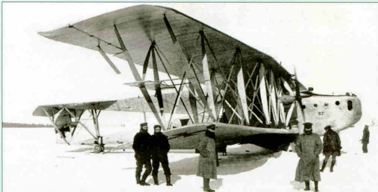
Самолеты-гиганты фирмы «Сименс-Шуккерт» отличались причудливой формы фюзеляжем – высоким и узким, с раздвоенной в вертикальной плоскости хвостовой частью
