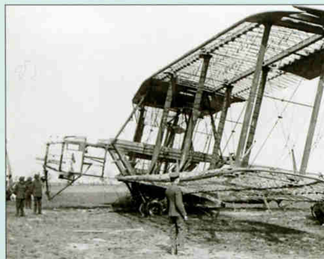
Остов «ризенфлюгцойга», лишенный обшивки
