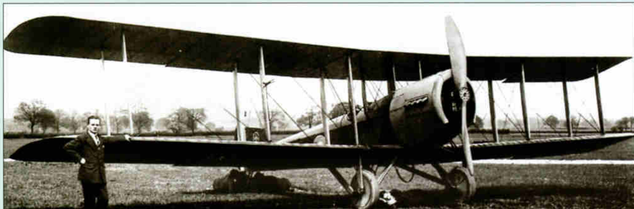
Т.1 «Куку» стал первым в мире колесным самолетом, специально спроектированным для базирования на авианосцах
