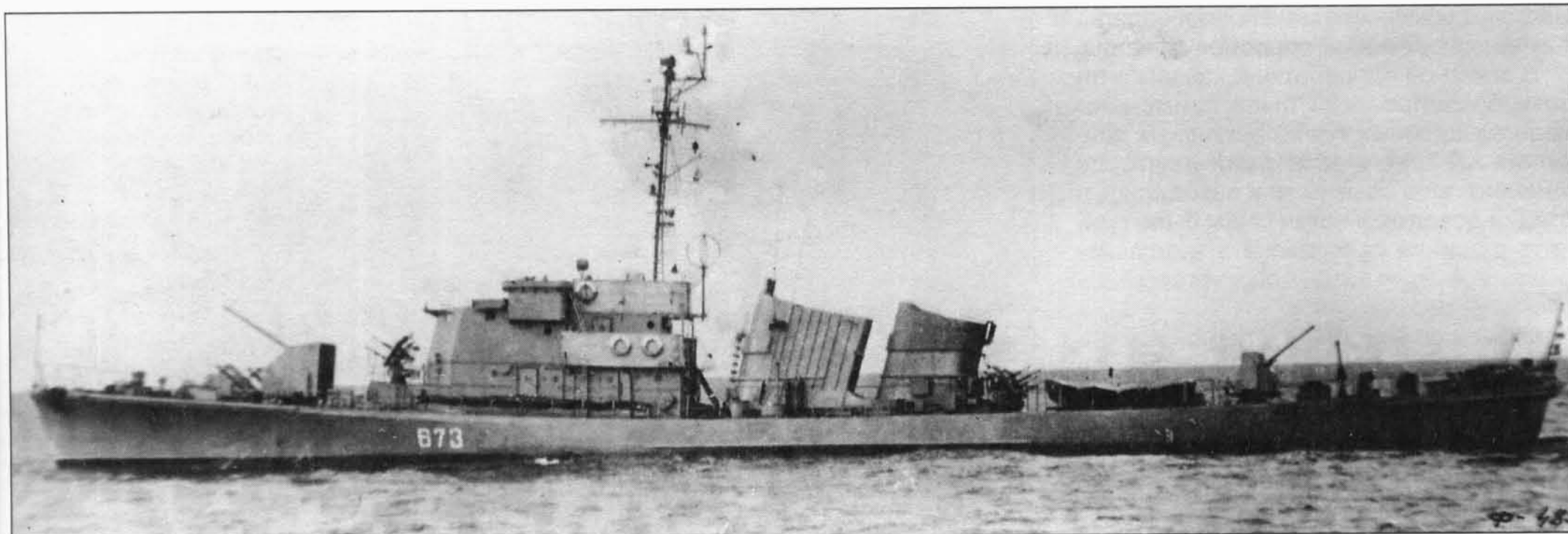
Опытный корабль МПК-163 (заводской № 936) с газотурбинной ускорительной установкой УГТУ-2
