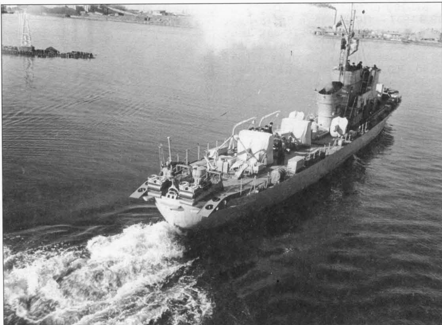
Большой охотник Балтийского флота выходит в море, 1950-е гг. Фрагмент этого снимка показывает расположение бомбосбрасывателей и минных скатов
