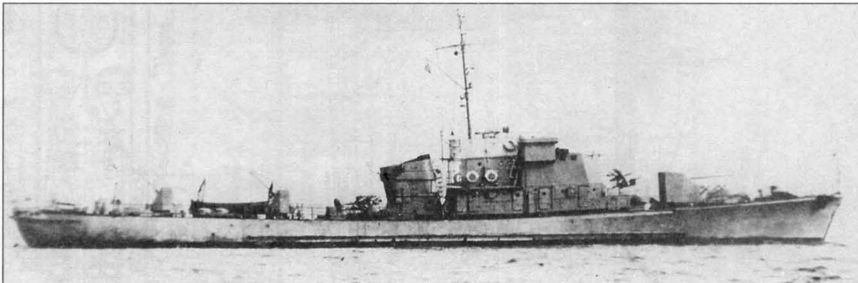
Большой охотник проекта 122бис второй серии с 12,7-мм пулеметами 2М-1
