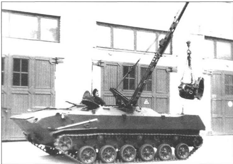
БРЭМ-Д с кран-стрелой в рабочем положении
