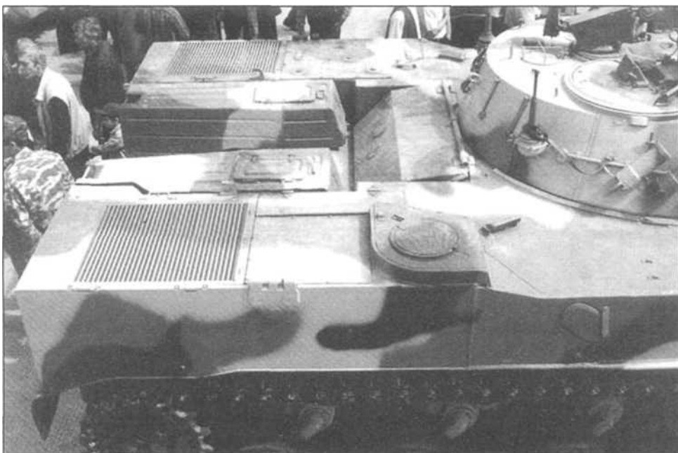
Кормовая часть БМД-3. Установленные на крыше МТО коробки предназначены для перевозки инструментов и ЗИПа
