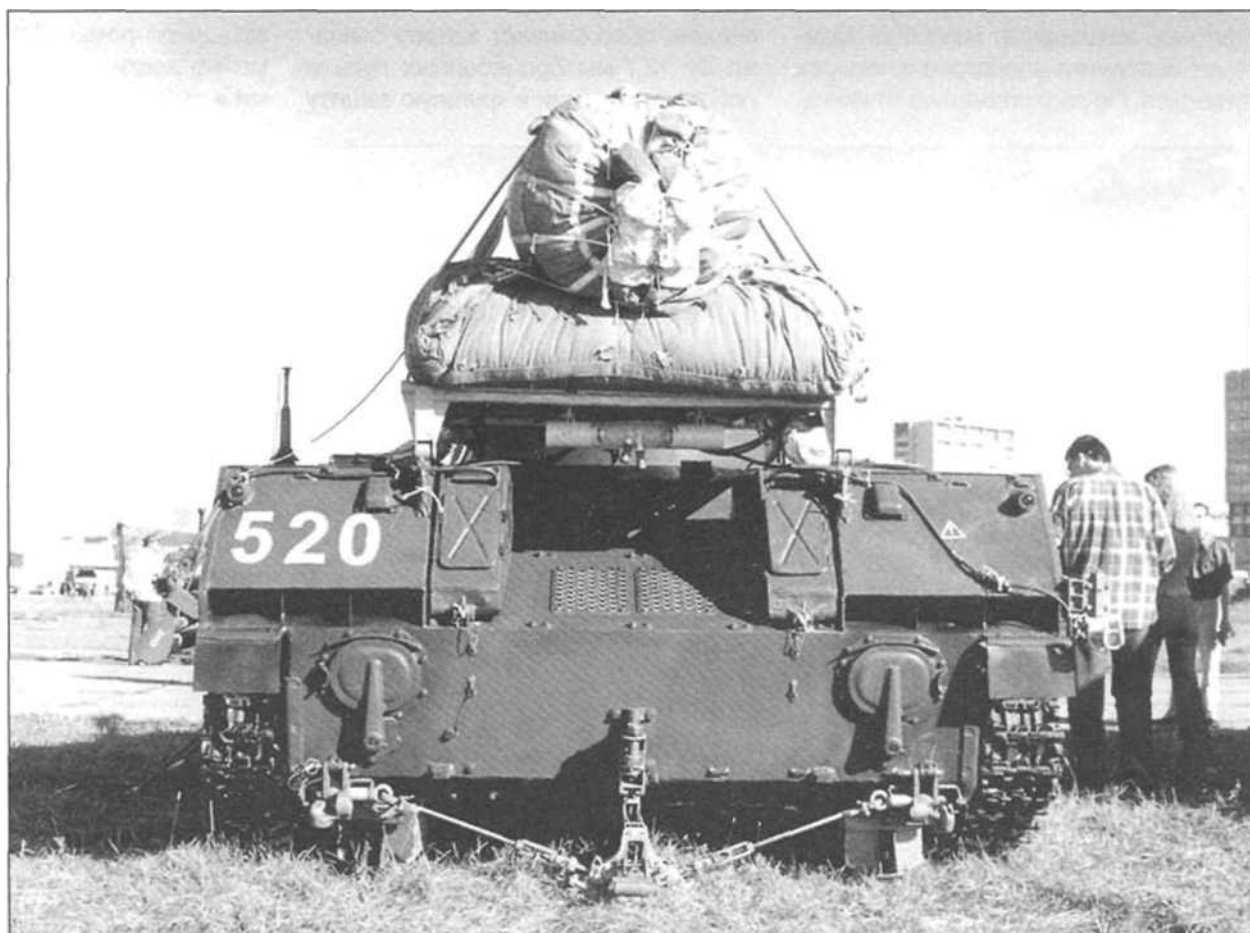
БМД-2 с уложенной парашютно-реактивной системой ПРСМ-916
