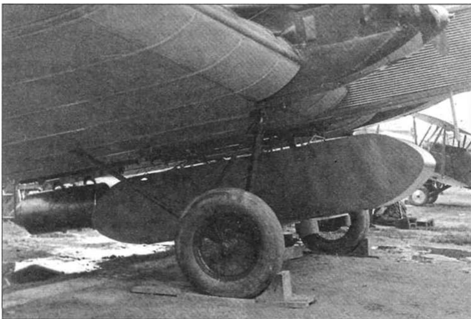
Грузовой ящик с парашютом под бомбардировщиком ТБ-1
