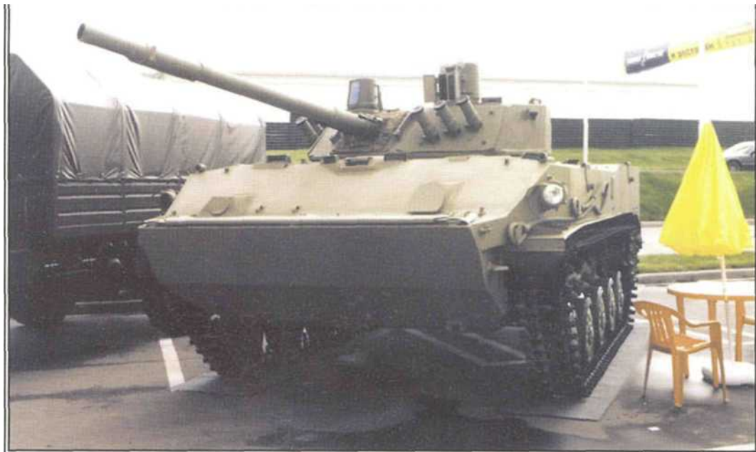
Башня боевого отделения «Бахча У». Справа от пушки, на крыше башни установлен комбинированный дневной/ночной прицел наводчика, слева — тепловизор
