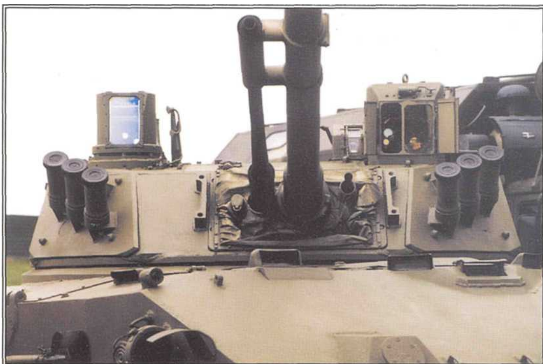
Вид на башню сзади-сверху. В центральной части крыши, под защитным колпаком характерной формы, размещена антенна спутниковой навигации
