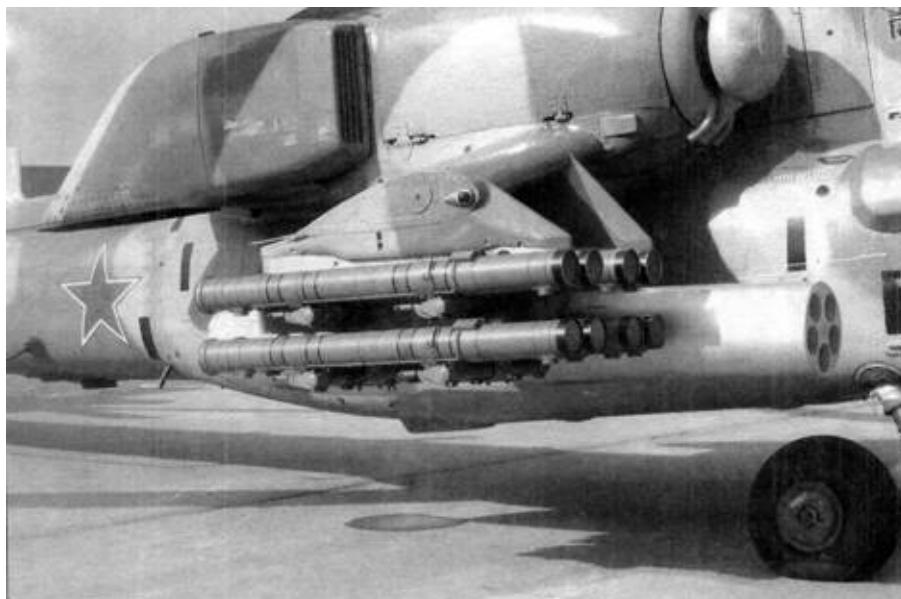
Подвеска пакета транспортно-пусковых контейнеров ПТУР и блока Б-13Л
