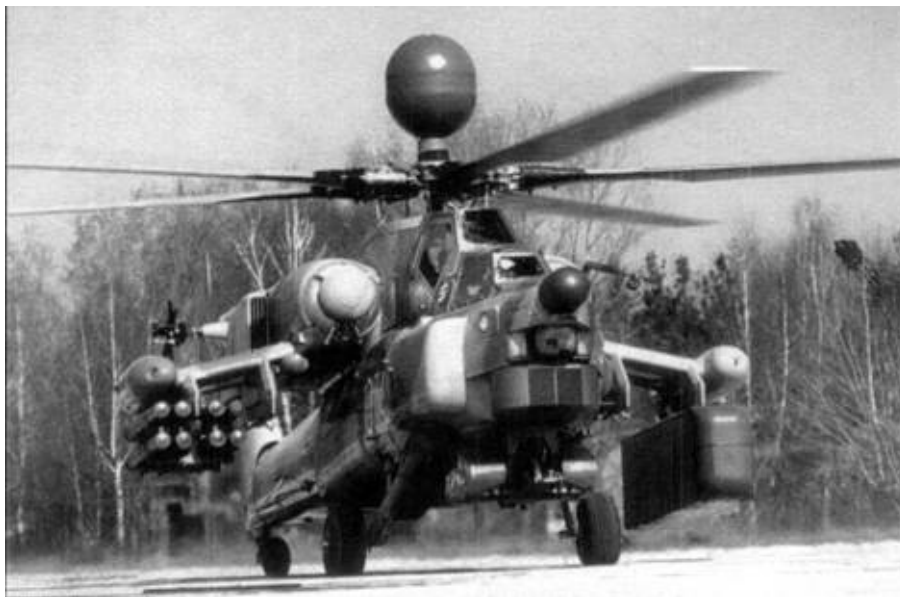
Первый опытный образец Ми-28Н в демонстрационном полете с макетом РЛС
