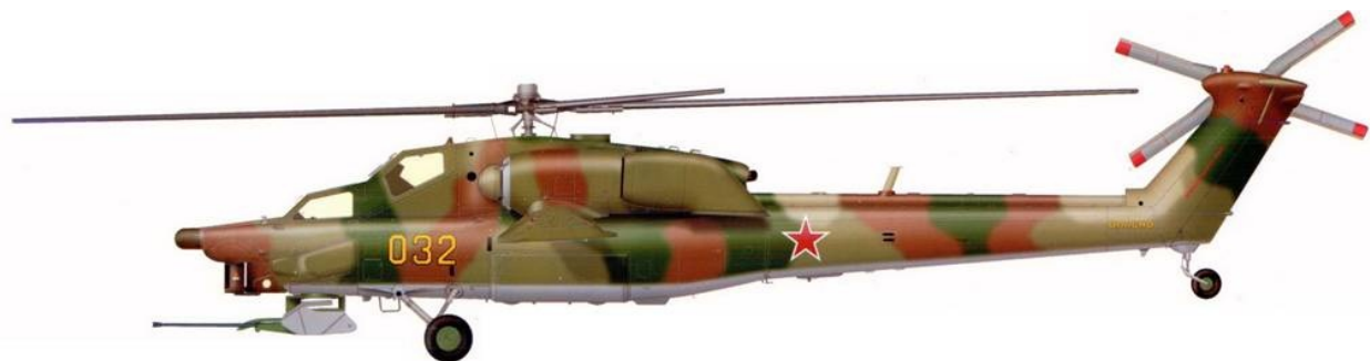
Первый опытный образец Ми-28А с Х-образным хвостовым винтом
