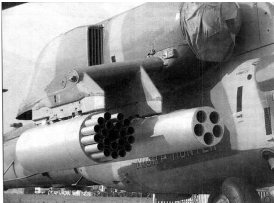
На пилонах под крылом подвешены: слева – блок Б8В-20 с НАР С-8, справа – блок Б-13Л с НАР С-13
