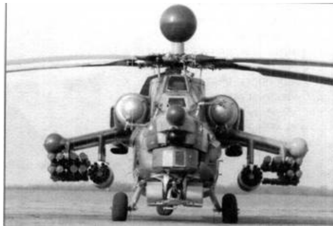
Ми-28Н с вооружением из 14 ПТУР «Атака» и двух блоков Б8В-20
