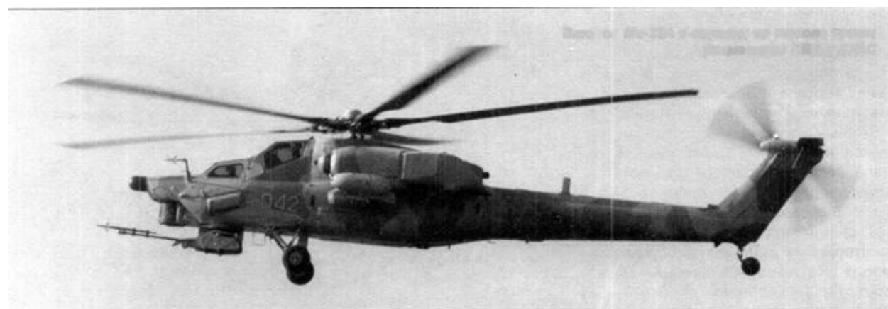
Второй Ми-28А в полете; на стволе пушки размещены ПВД и ДУАС
