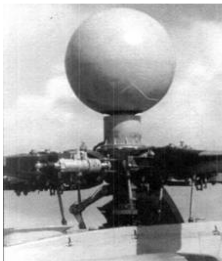
Наддулочный обтекатель антенны РЛС НО-25
