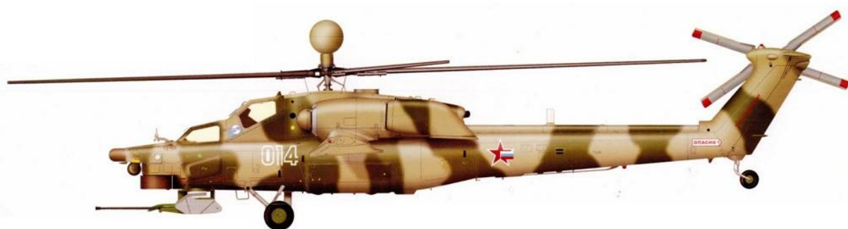
Первый опытный образец Ми-28Н, переделанный из первого опытного Ми-28А, 1999 г.
