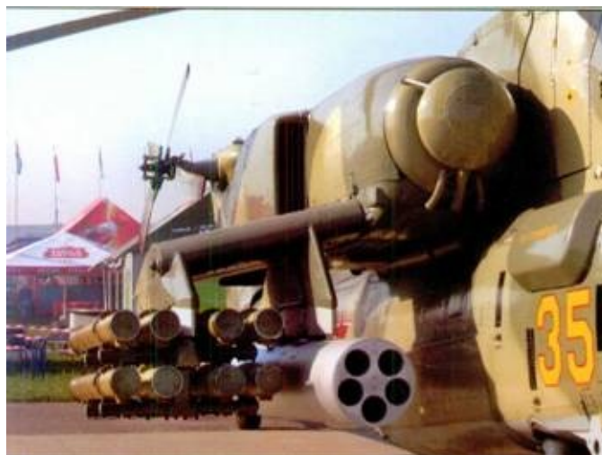
Гондола правого двигателя. Ниже её – крыло, на пилонах которого закреплены блок НАР и транспортно-пусковые контейнеры ПТУР
