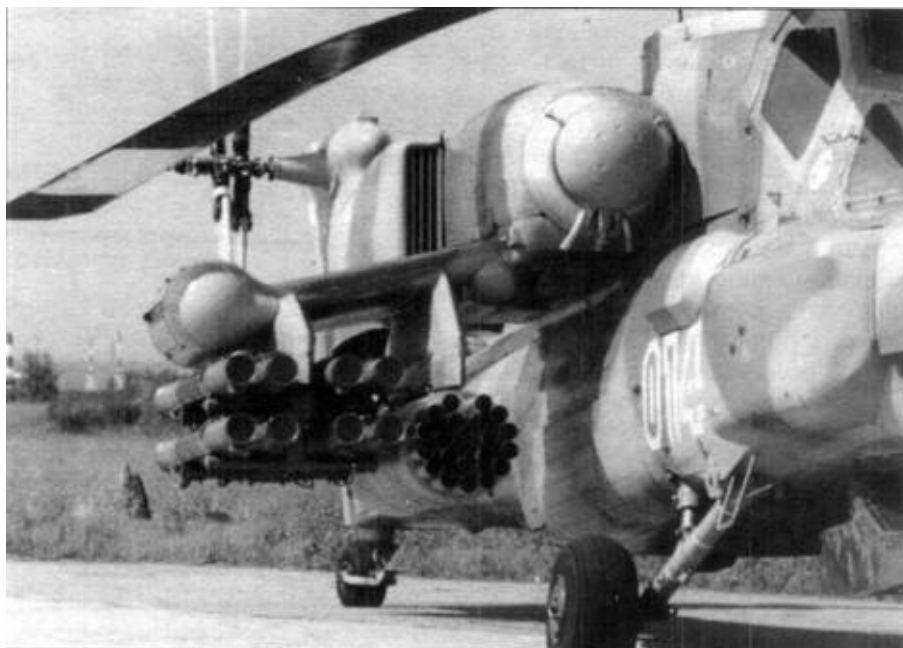
Под крылом Ми-28Н – транспортно-пусковые контейнеры ПТУР и блоки НАР Б8В20-А
