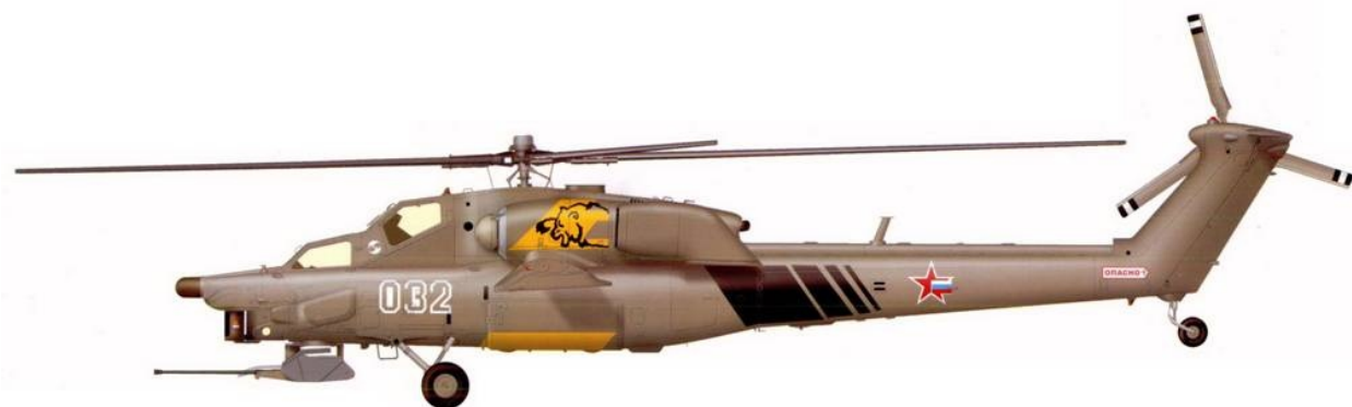
Первый опытный образец Ми-28А в первоначальном виде с трёхлопастным хвостовым винтом, авиасалон МАКС-1999, г.Жуковский, 1999 г.
