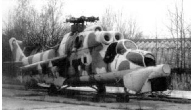
Летающая лаборатория – Ми-24, на которой отрабатывался прицельно-пилотажно-навигационный комплекс Ми-28
