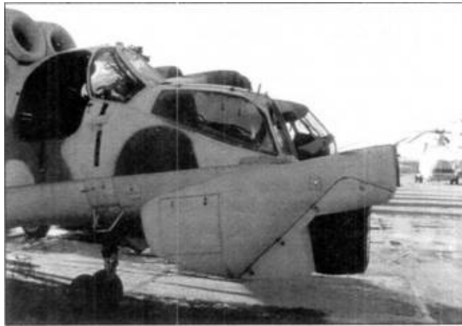
Летающая лаборатория – Ми-24, на которой отрабатывался прицельно-пилотажно-навигационный комплекс Ми-28
