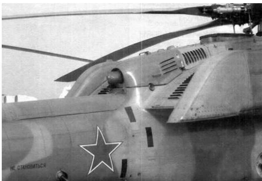
Задняя часть силовой установки с экранно-выхлопными устройствами
