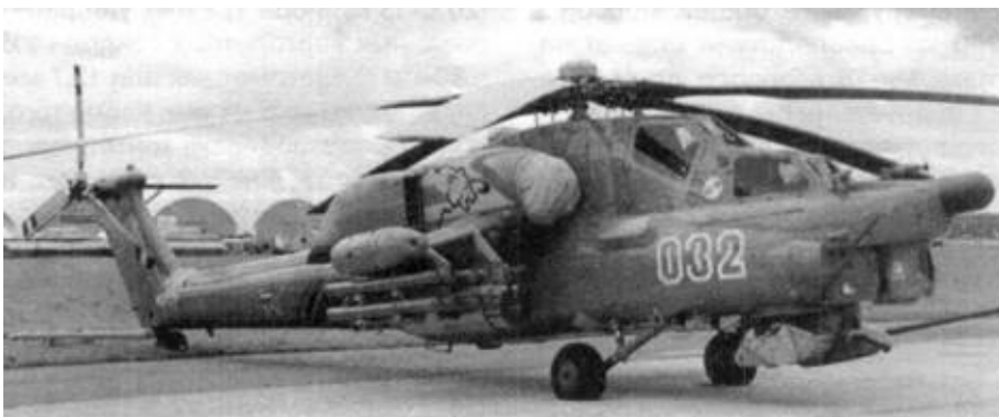
Первый образец Ми-28А в первоначальном виде с трехлопастным хвостовым винтом
