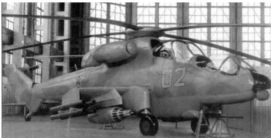
Полноразмерный макет «изделия 280» с хвостовым винтом. Носовая часть вертолета явно сохраняет «фамильные черты» Ми-24
