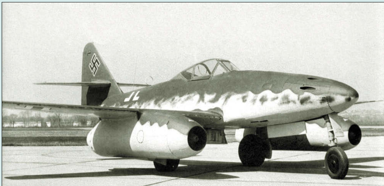
Me 262 был выполнен по схеме низкоплана с двигателями, размещенными в гондолах под крылом
