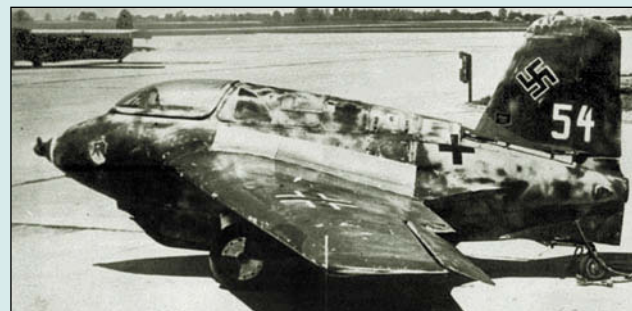
Характерной чертой Me 163 стала аэродинамическая схема «бесхвостка»
