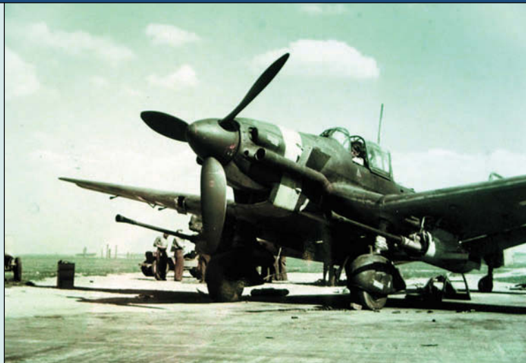
С двумя 37-мм артиллерийскими установками общей массой около 900 кг Ju 87G был чрезвычайно неуклюж... и очень опасен
