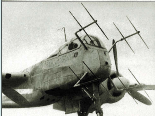
Хотя РЛС обеспечивала возможность обнаружения целей ночью, громоздкие антенны первых бортовых радаров существенно увеличивали лобовой сопротивление
