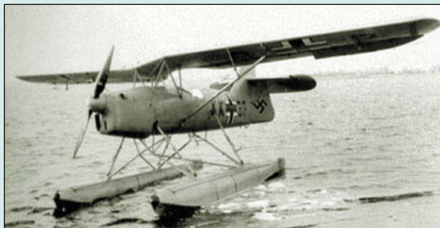
Крошечный разборный гидросамолет Ar 231 предназначался для базирования на подводных лодках
