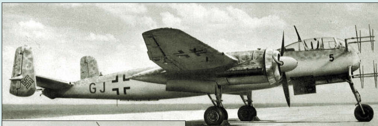
Характерными чертами He 219 были сдвинутая в нос фюзеляжа кабина экипажа и шасси с носовой стойкой
