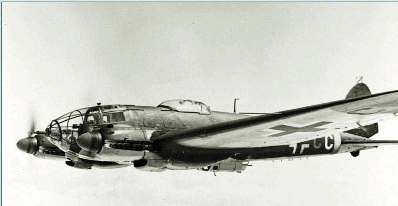
Самолеты He 111P и H получили новую носовую часть фюзеляжа с измененной кабиной экипажа
