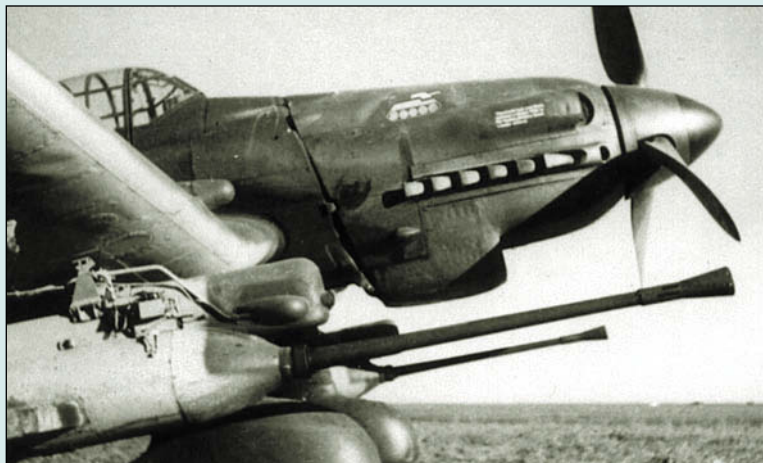
С двумя 37-мм артиллерийскими установками общей массой около 900 кг Ju 87G был чрезвычайно неуклюж... и очень опасен
