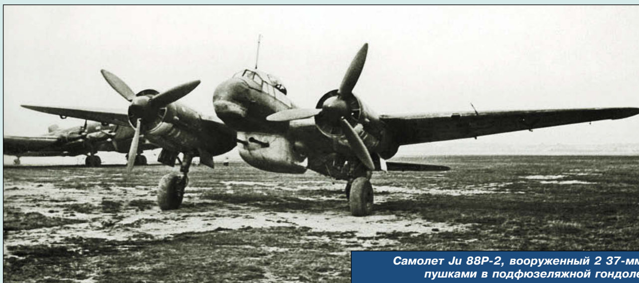
Ночной истребитель Ju 88C-6 с опытной установкой 2 37-мм пушек в подфюзеляжном обтекателе
