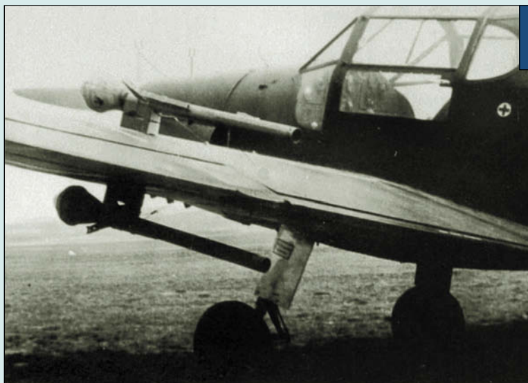
Bucker Bu 181, переоборудованный в истребитель танков. Самолет оснащен четырьмя гранатометами «Панцерфауст»
