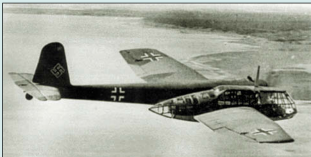
BV 141A-0 в полете. У этой модификации было симметричное горизонтальное оперение, в то время как на более поздней BV 141B-0 от оперения осталась только левая консоль
