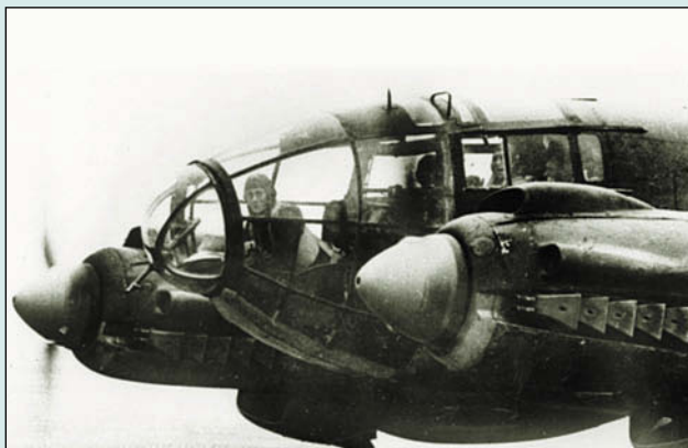
Из-за характерной несимметричной кабины He 111H прозвали «кривомордым»
