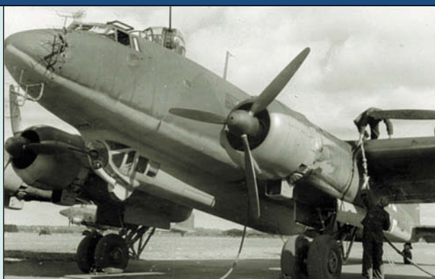
Носовая часть FW 200C-4 с антеннами РЛС
