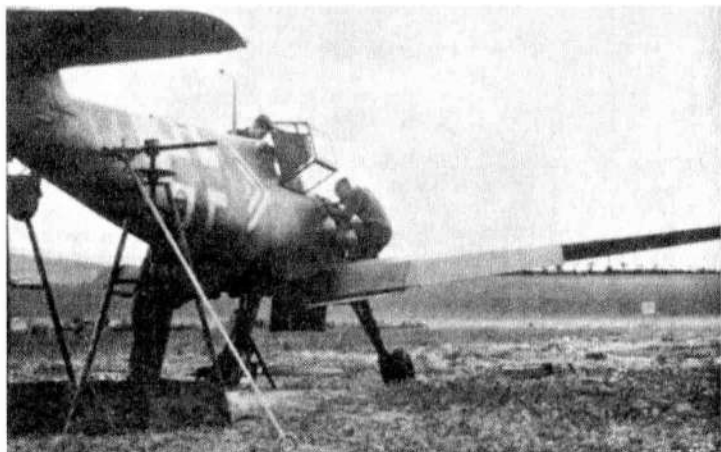
Пристрелка оружия на Bf109F из JG3
