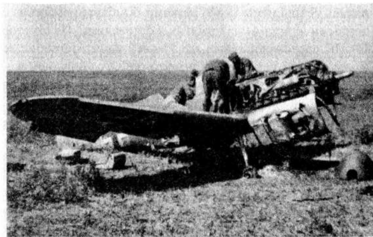
Замена поврежденного двигателя DB-601E в полевых условиях
