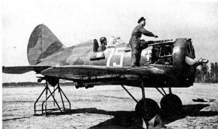
Летчик В.П. Сегалаев и механик И.В. Белокоп отстреливают пулеметы И-16 тип 29 из 71-го иап ВВС КБФ
