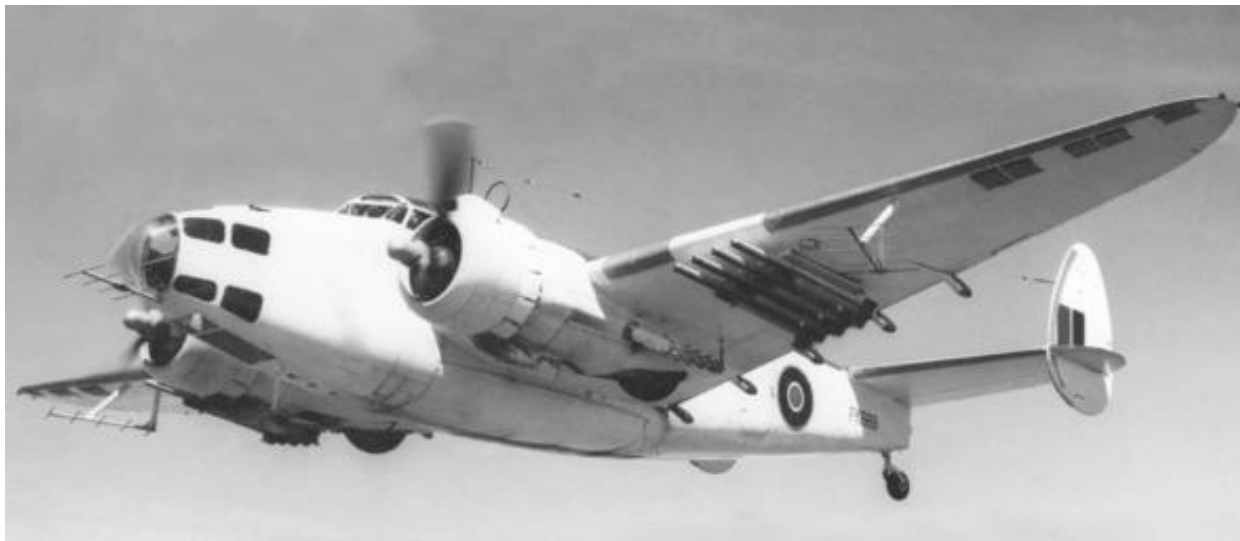
Британский патрульный самолёт «Хадсон» Mk.VI с РЛС ASV Mk II и вооружённый 127-мм НАР (по четыре под каждым крылом)
