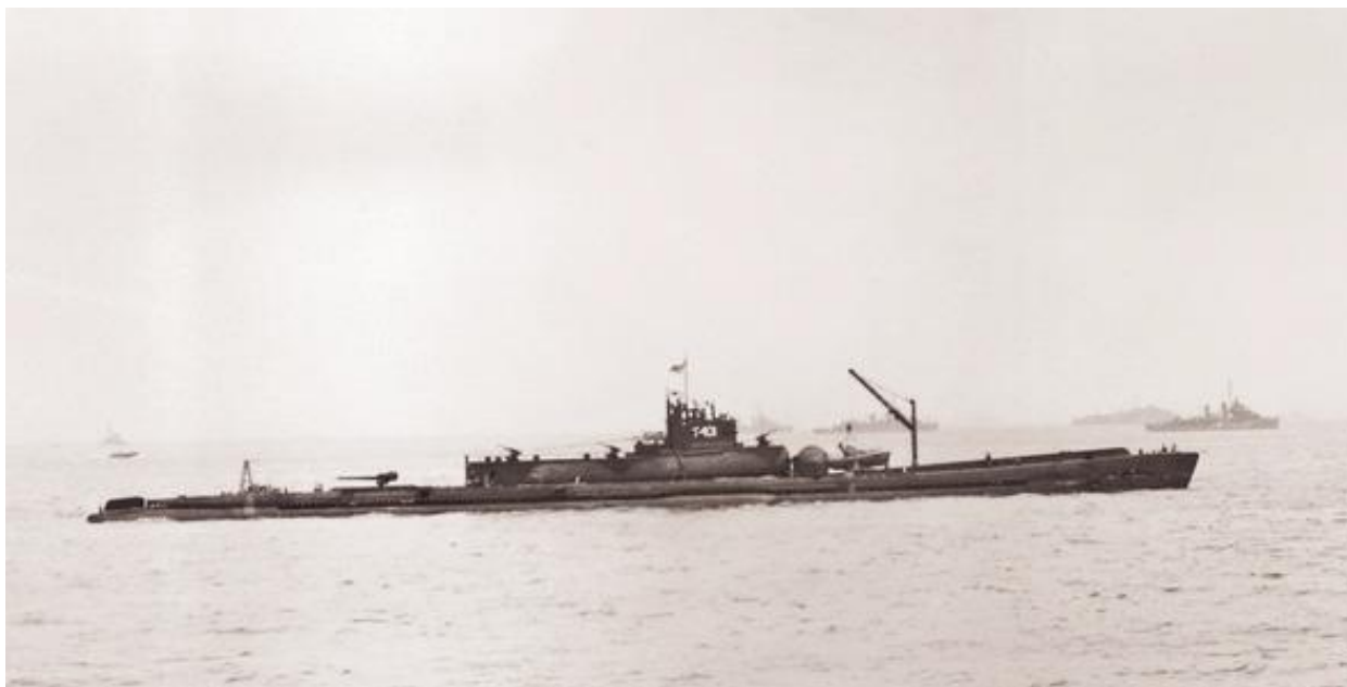
Дизельная авианесущая субмарина I-401 (типа I-400 «Sen-Toku»), ходовые испытания, 1945 год
