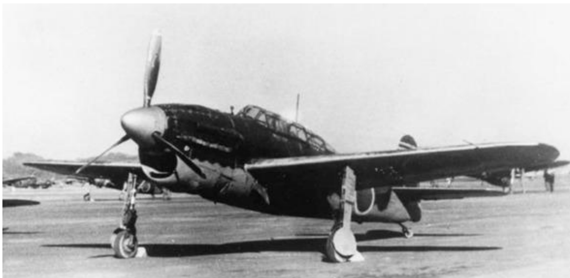
Палубный пикирующий бомбардировщик «Йокосука» D4Y2 «Сусей» с двигателем жидкостного охлаждения «Ацута-32», 1944 год
