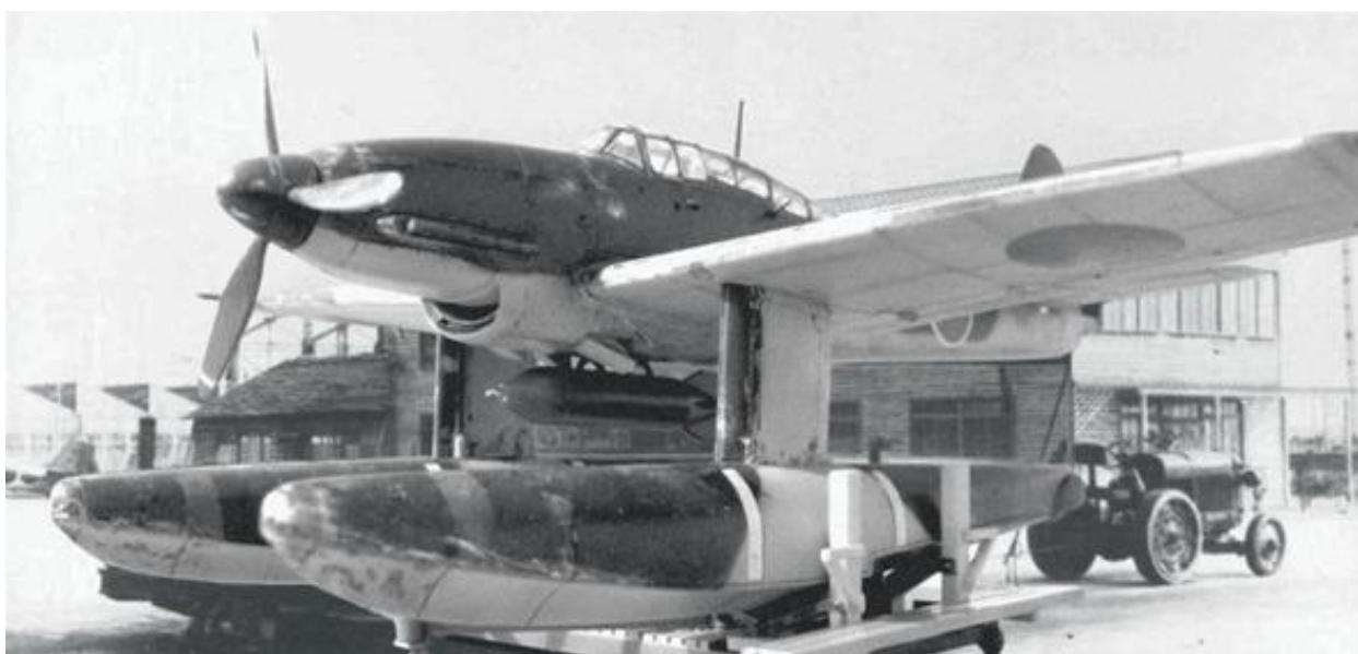
Третий прототип бомбардировщика-торпедоносца М6А1 «Сейран» на транспортной тележке, под фюзеляжем 800-кг авиабомба
