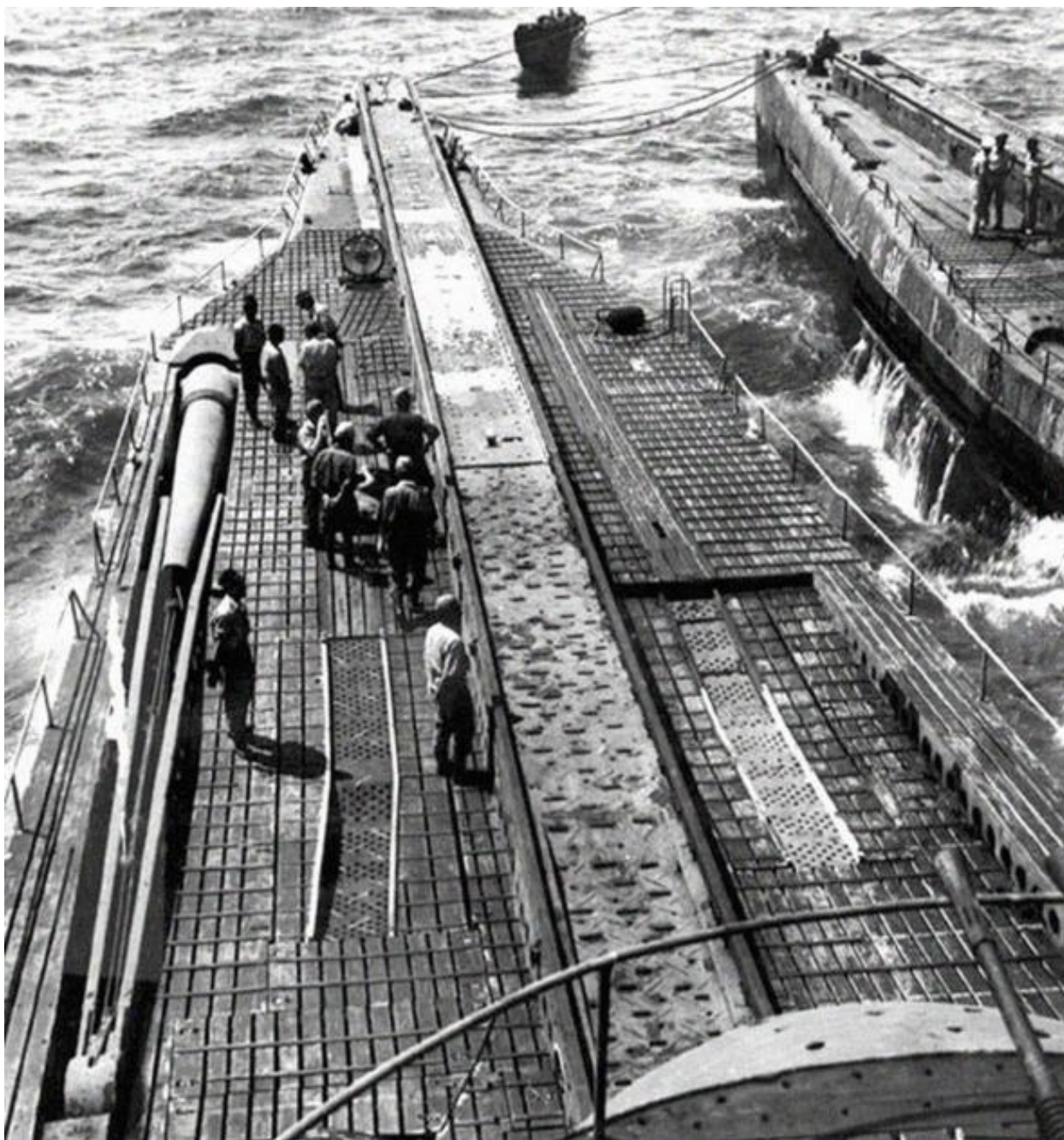
Стартовый трек пневматической катапульты авианесущей субмарины I-400, слева по борту кран (в походном положении) для подъёма на палубу приводнившихся гидросамолётов, Тихий океан, 29 августа 1944 года
