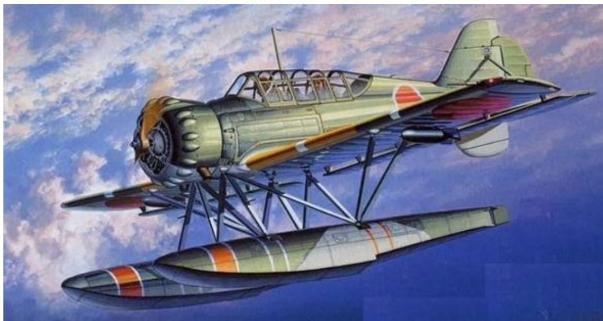
Гидросамолёт «Кугишо» E14Y1 с двумя 30-кг бомбами под крылом
