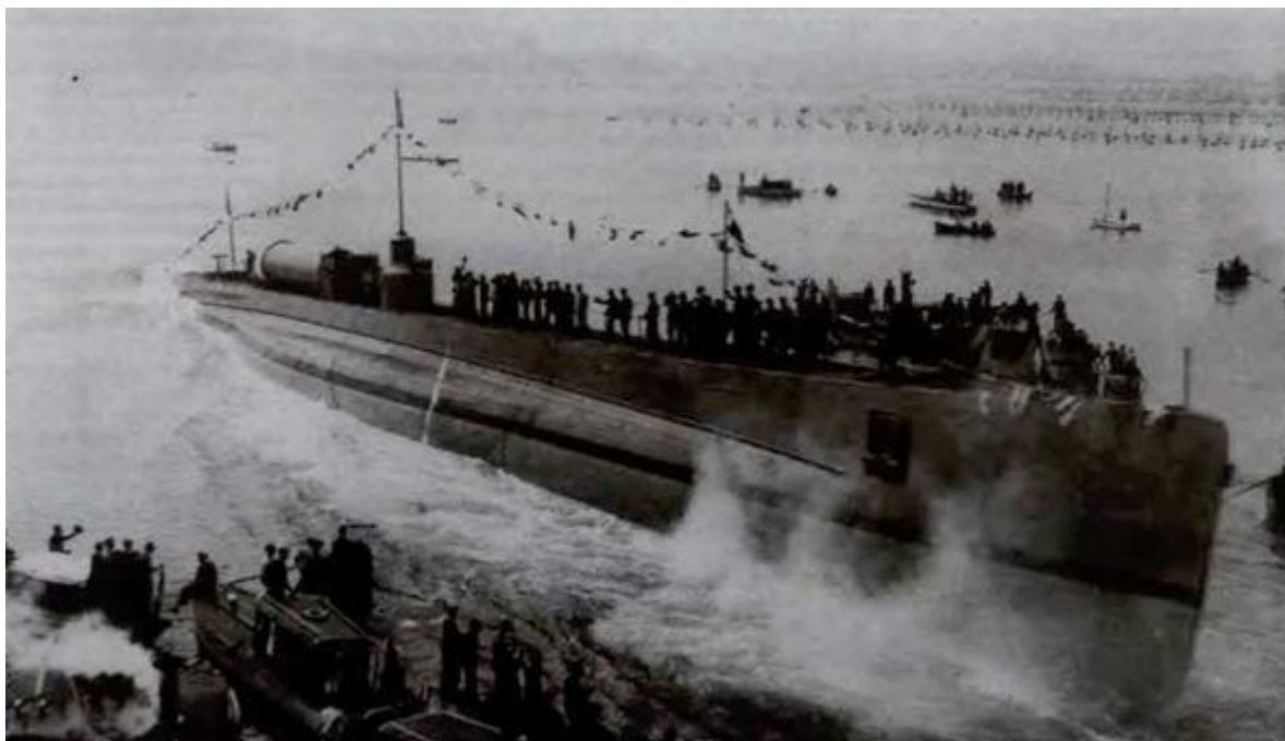
Итальянский подводный крейсер «Эttore Фиерамоска» во время спуска на воду 15 апреля 1929 года, за рубкой хорошо виден цилиндрический ангар для гидросамолёта
