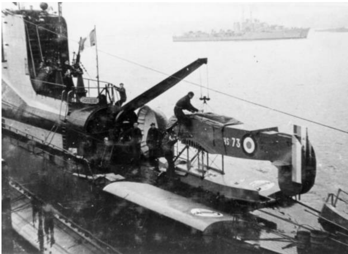
Гидросамолёт-разведчик «Бессон» MB.411 «Петре» на борту «Сюркуфа» готовят к размещению в ангаре (крылья уже демонтированы)
