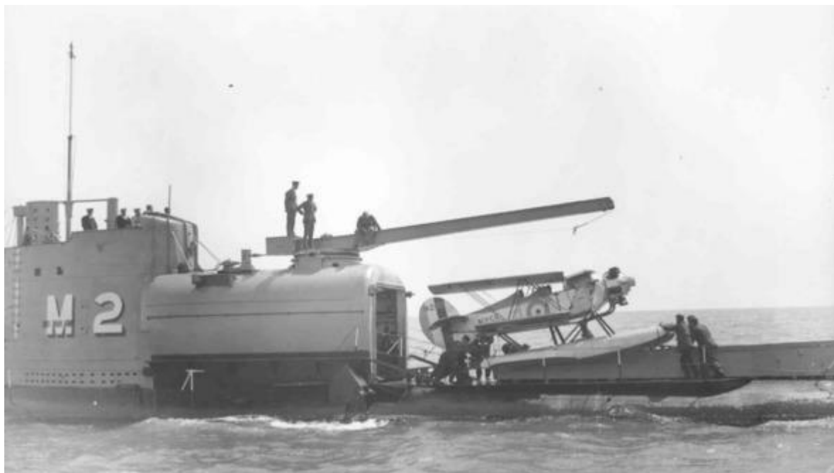
Специальная команда подлодки М-2 готовит к взлёту с помощью катапульты гидросамолёт «Пэто» (крылья ещё сложены, винт не установлен)
