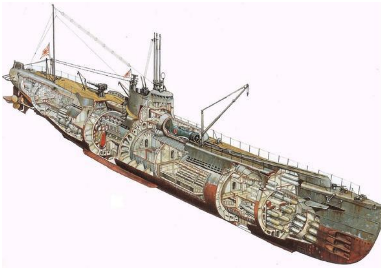
Схематическое устройство авианесущей субмарины I-25 типа B1 («Otsu-Gata»)
