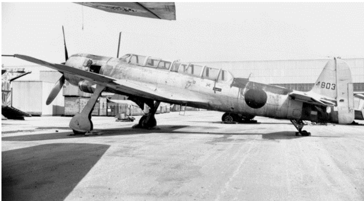
Разведывательный самолёт «Накадзима» С6N1 «Саюн», максимальная скорость на высоте 6000 метров 610 км в час
