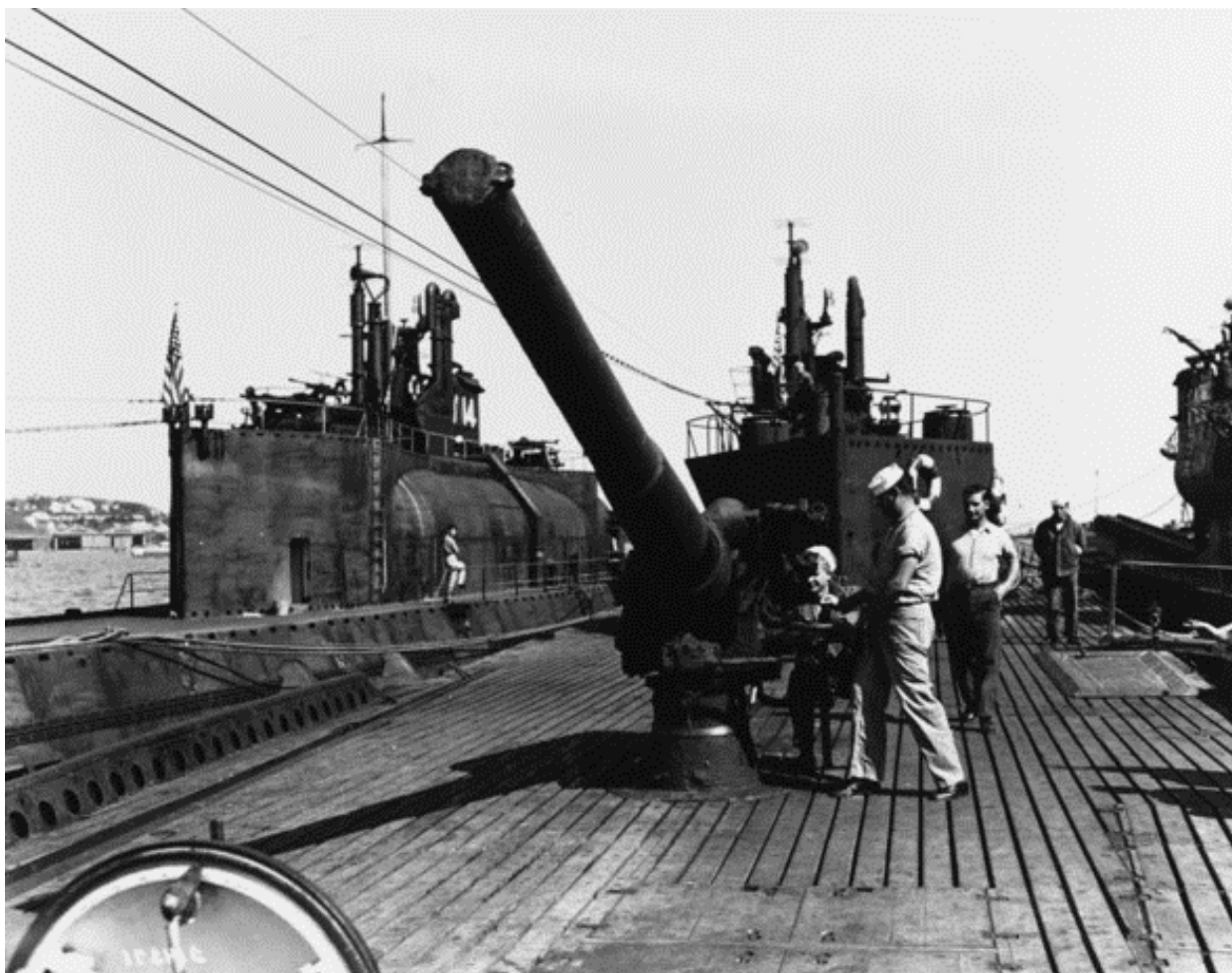
140-мм кормовое орудие авианесущей подводной лодки I-401 (дальность стрельбы 17,5 км, скорострельность 6 выстрелов в минуту)
