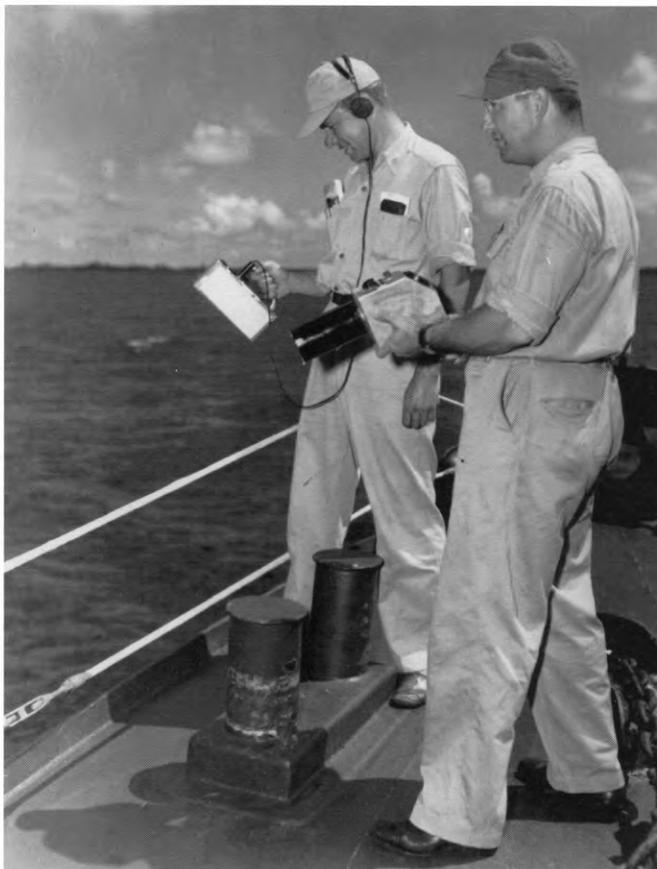
С помощью радиометров и счетчиков Гейгера после каждого испытания обследовали лагуну, а также и корабли-мишени перед тем, как на борт поднимались бригады для снятия приборов, подопытных животных или для дезактивации. Однако из-за большого объема работы измерительных приборов не хватало, особенно после испытания «Бэйкер» 25 июля, когда почти все корабли-мишени и суда поддержки были сильно заражены радиоактивной водой и осадками на дне лагуны.
