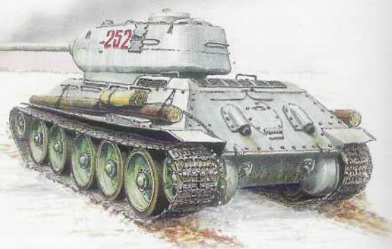
Советские средние танки серии Т-34 отличались мощным дизельным двигателем и броневыми листами, закрепленными под особым углом
